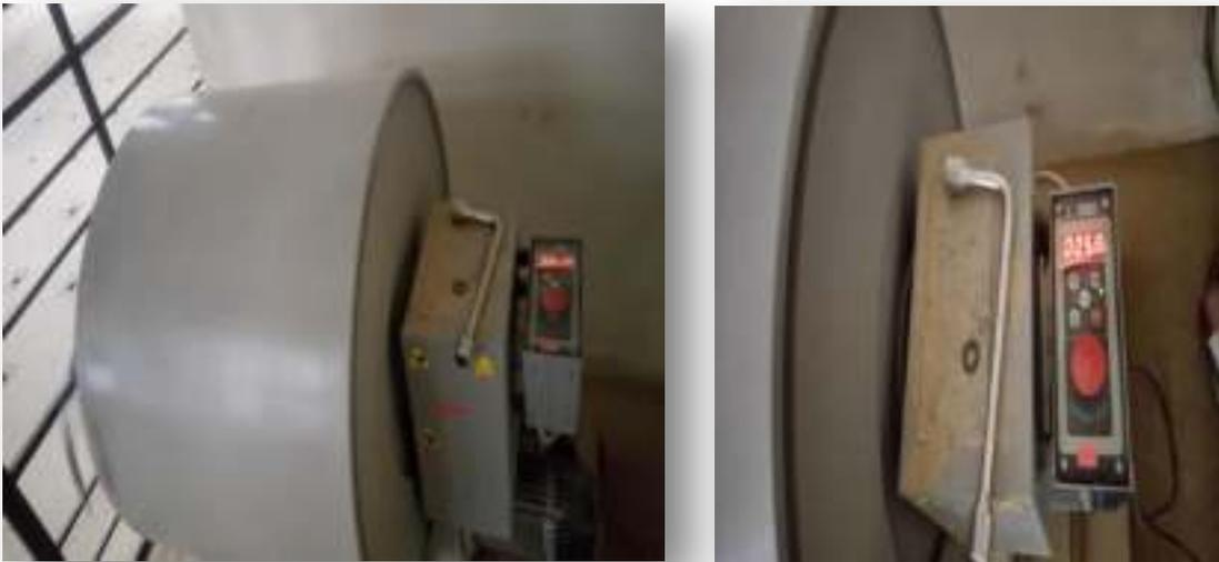
Finalización del ensayo de Desgaste de Los Ángeles
