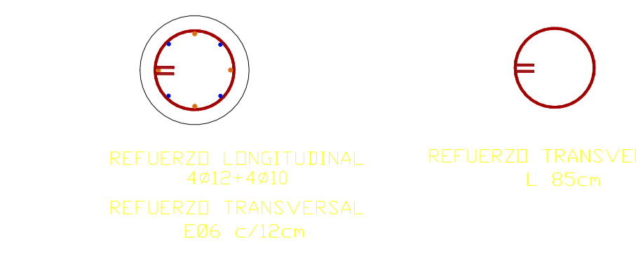
SECCIÓN TRANSVERSAL COLUMNA (D 30) ESCALA 1:15
