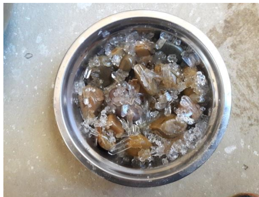
Figura 3.19: Ensayo por sulfato de sodio
