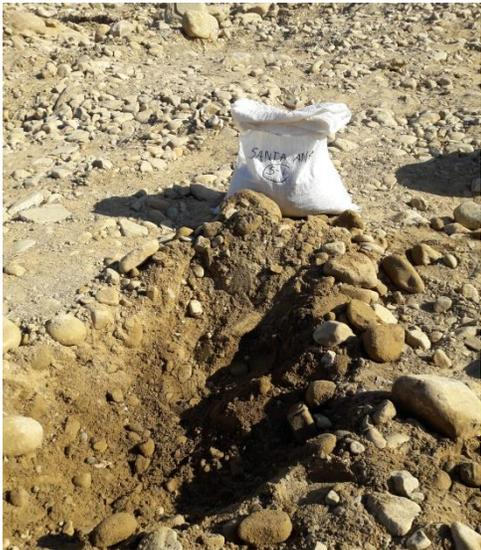
**Obtención de muestras de agregados Rio Sola**
