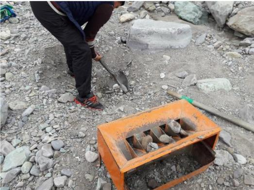
**Obtención de muestras de agregados Quebrada Saire**
