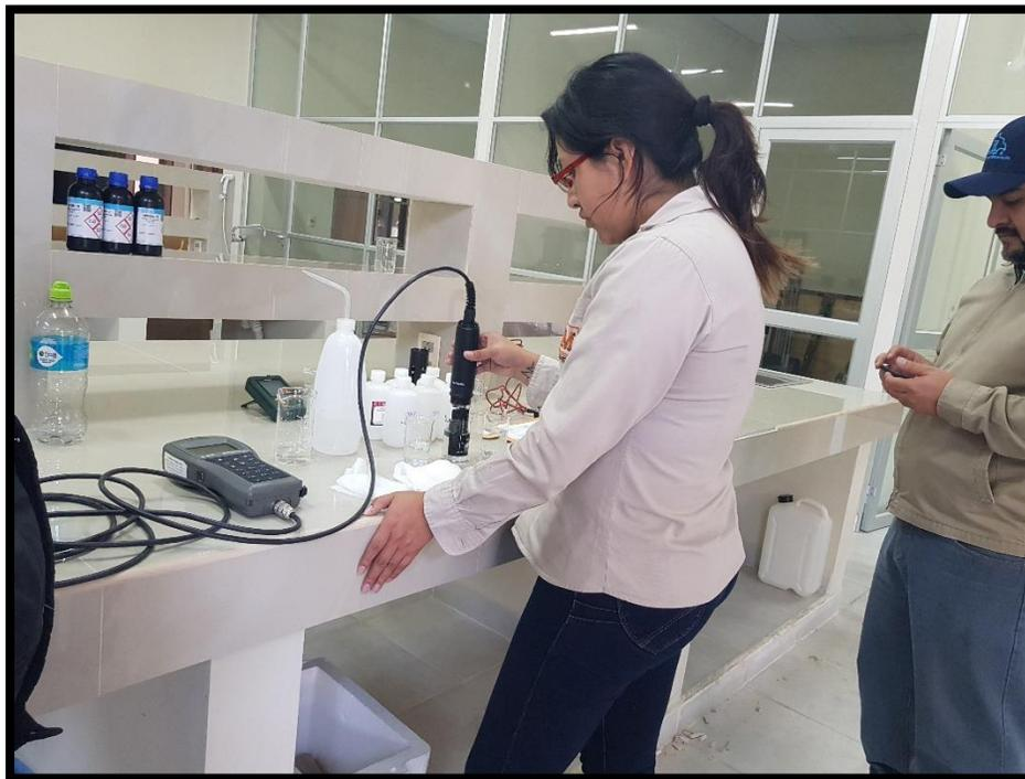
FIGURA N° 4.5: CALIBRACIÓN DE ELECTRODOS, POR PARTE DE IBMETRO
