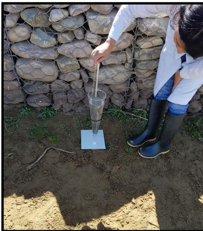
FIGURA N° 4.4: MEDICIÓN DE SÓLIDOS SEDIMENTABLES
