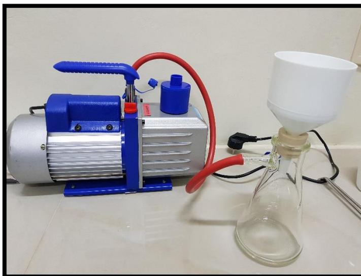
FIGURA N°3.12: EQUIPO DE FILTRADO AL VACÍO
