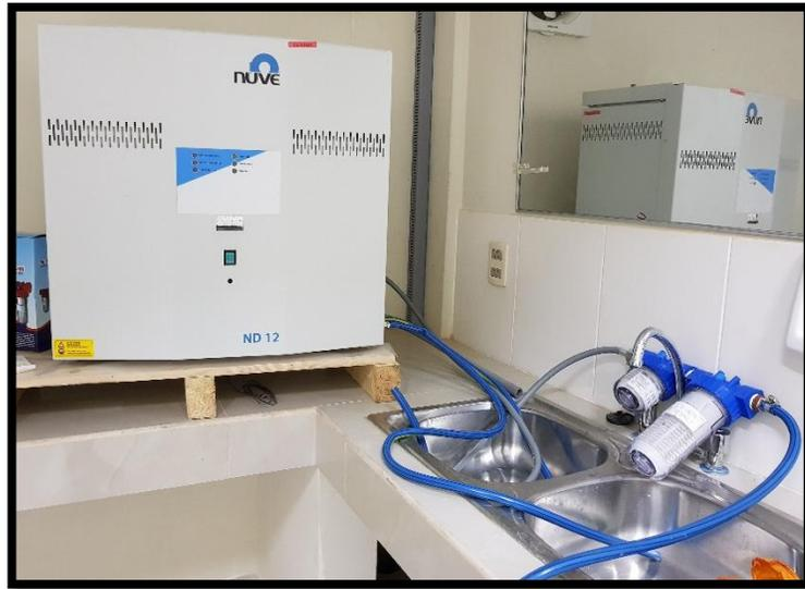
FIGURA N°3.18: DESTILADOR DE AGUA
