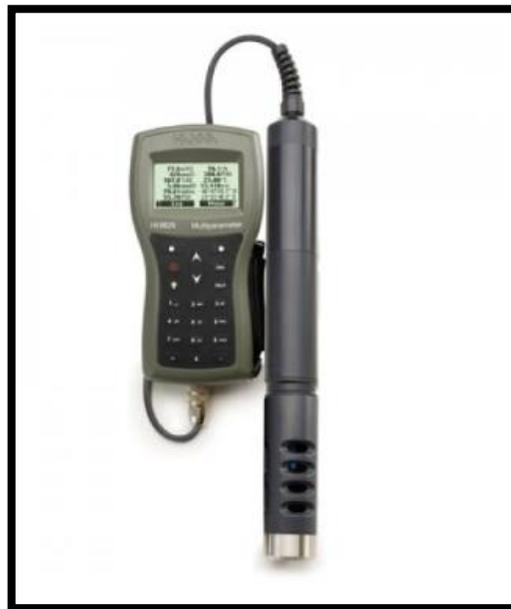
FIGURA N°3.5: MEDIDOR MULTIPARÁMETRO HI 98290
