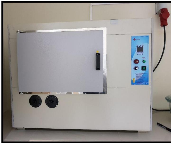
FIGURA N°3.10: ESTUFA DE SECADO Y CALENTAMIENTO DE CONVECCIÓN FORZADA
