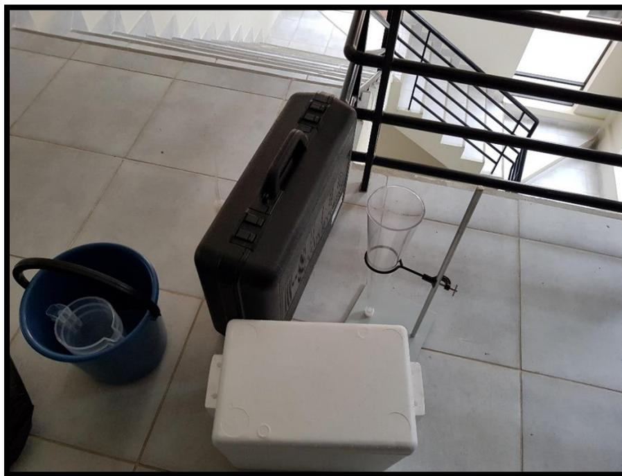
FIGURA N° 4.3: EQUIPO Y MATERIAL NECESARIO PARA LA MEDICIÓN DE PARÁMETROS
