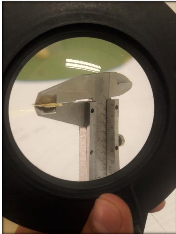
Figura 2.14 : Lectura del espesor de la pintura
