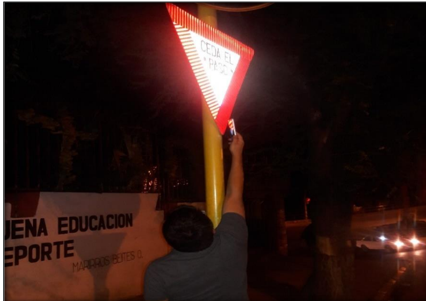
Figura 3.26: Medición de la retroreflectancia en señales verticales en calles
