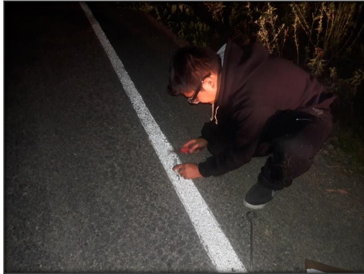
Figura 3.29: Extracción de pintura en carreteras
