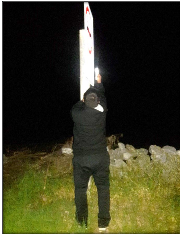
Figura 3.30: Medición de la retrorreflectancia
