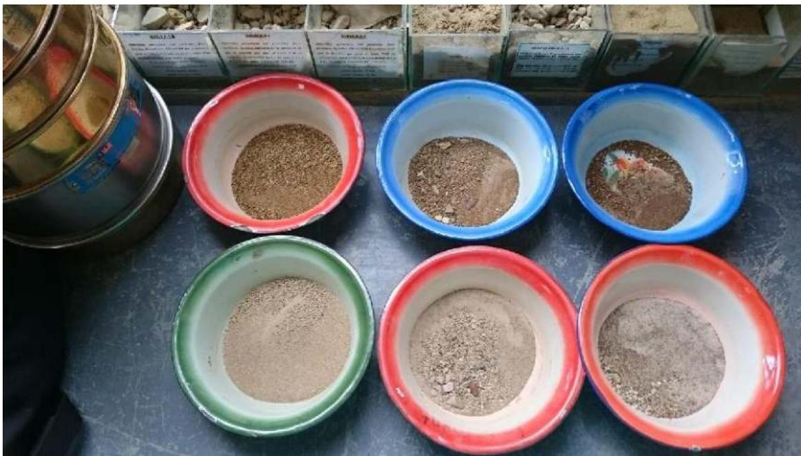
*Muestras de suelo antes de ser tamizadas después de haber usado el método del lavado para determinar su granulometría.*
