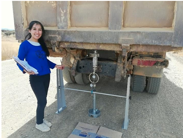
Figura 8 – Montaje para ensayo CBR in situ
