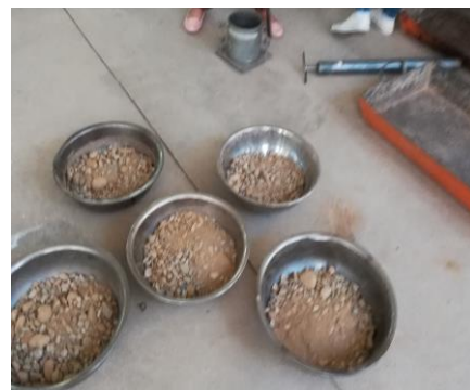
Dividir el suelo en 5 fracciones iguales, a cada uno se le incrementa un % de agua.
