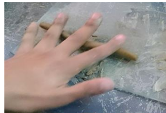
Figura 22 – Esquema del ensayo de límite plástico
