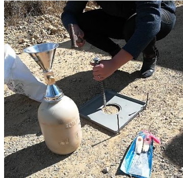
Figura 4 – Densidad in situ, método cono de arena.
