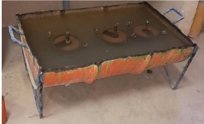
Figura 7 – Montaje de molde dentro de un depósito lleno de agua
