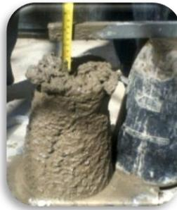
Figura 3.15. Ensayo de cono de Abrams para el 30% de reemplazo de grava
