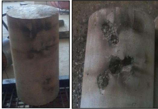
Figura 3.20. Probetas al 30% de reemplazo de grava, después de 30 minutos de estar en contacto con el fuego
