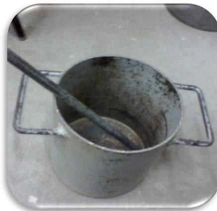
Figura 3.6 Molde cilíndrico de 3 lt
