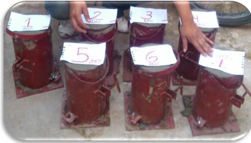
Figura 3.9. Pasta de hormigón colocada en moldes cilíndricos
