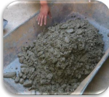
Figura 3.14. Pasta de hormigón aligerado a base de EPS
