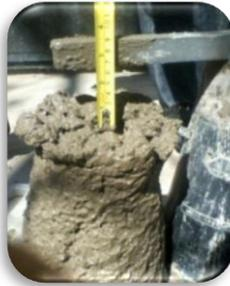
Figura 3.17. Ensayo de cono de Abrams para el 40% de reemplazo de grava
