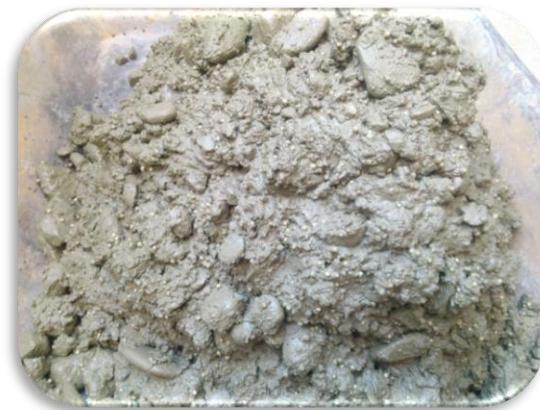
Figura 3.16. Pasta de hormigón aligerado a base de EPS
