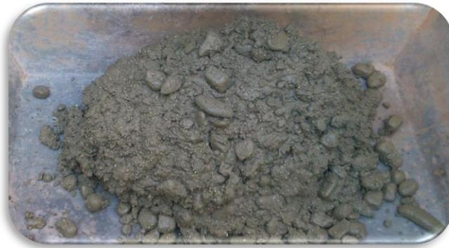
Figura 3.12. Pasta de hormigón aligerado a base de EPS
