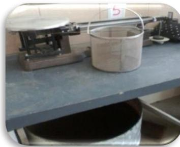
Figura 3.4. Equipo para realizar peso específico aparente de la grava
