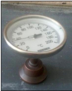
Figura 3.24. Termómetro de contacto
