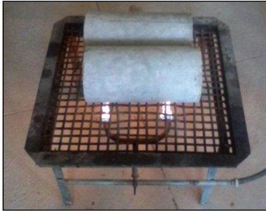
Figura 3.18. Probetas en contacto con fuego
