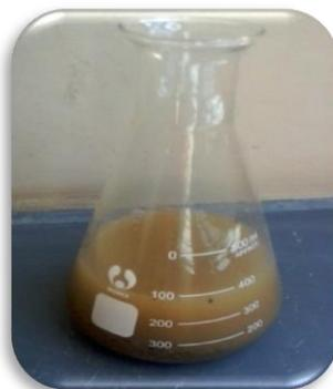
Figura 3.7. Matraz graduado para peso específico aparente de la arena
