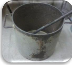
Figura 3.3. Molde cilíndrico de 14 lt
