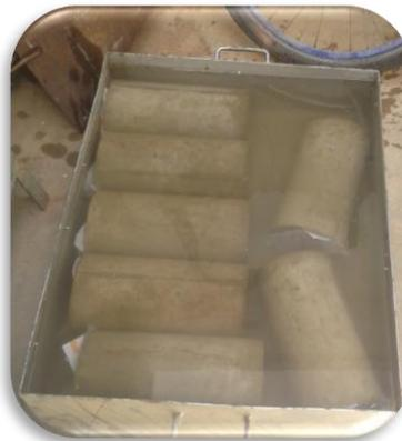
Figura 3.10. Curado de probetas en agua
