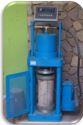
Figura 3.11. Equipo de rotura de probetas
