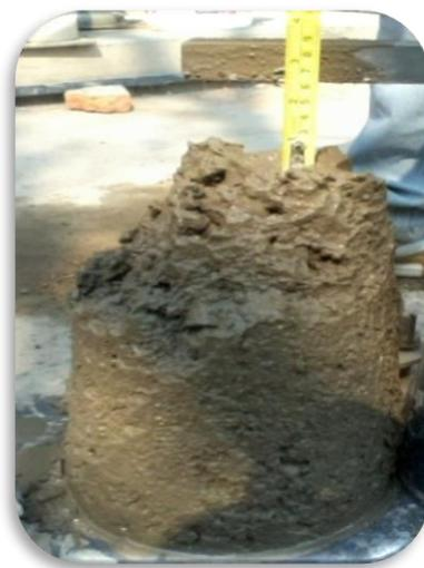
Figura 3.10. Ensayo de cono de Abrams del hormigón patrón
