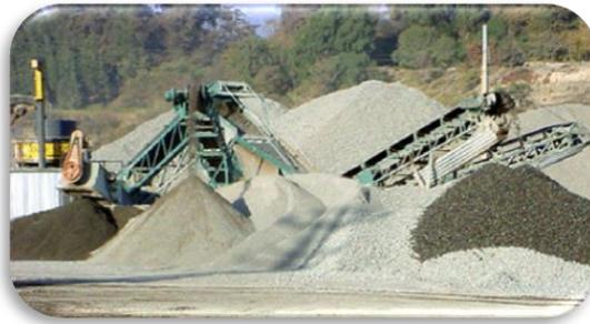
Figura 2.4. Planta chancadora de áridos
