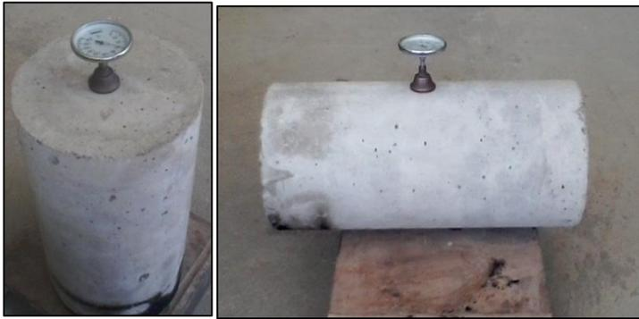
Figura 3.26. Medición de la temperatura
