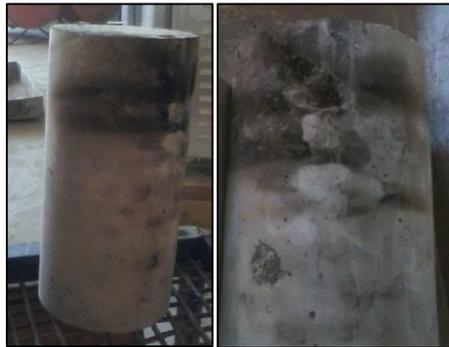
Figura 3.21. Probetas al 40% de reemplazo de grava, después de 30 minutos de estar en contacto con el fuego
