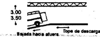
Area de manejo en desnivel de Vans ligeras y tope de descarga
