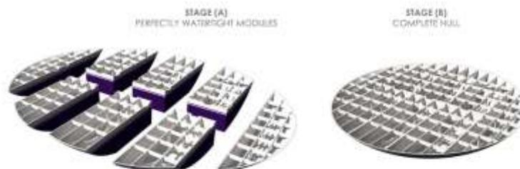
El WaterNest 100 casco está hecho completamente de aluminio, una aleación ligera, altamente resistente a los impactos, a la corrosión y 100 % reciclable, que no requiere mantenimiento. La forma cónica se consigue por medio de placas de aluminio que se cortan usando máquinas CNC compatibles con un sistema CAD / CAM y se preparó con mamparos de refuerzo. Además de garantizar una excelente flotabilidad, el casco contiene las instalaciones técnicas necesarias para la unidad residencial.
