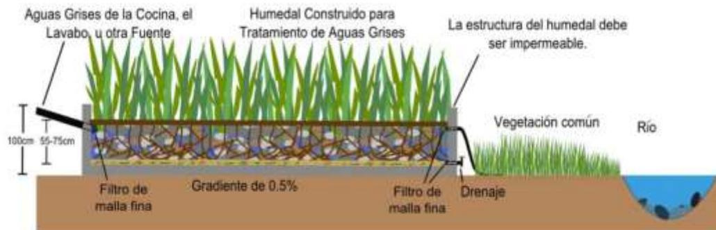
Figura 1. Un sistema subterráneo típico de humedales construidos
