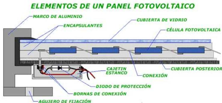
Los paneles fotovoltaicos de silicio (los más utilizados), tienen un rendimiento medio del 10%. Esto quiere decir que convierten en electricidad el 10% de energía que reciben del sol. Dependiendo del lugar del planeta, la radiación solar que llega a la superficie de la tierra en la hora punta de un día soleado es de unos 1000wattios por metro cuadrado. Con un rendimiento del 10%, en un panel solar de un metro cuadrado tendríamos 100wattios de potencia eléctrica.
