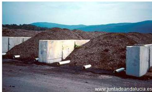
Las medidas óptimas oscilan entre 1,2 - 2 m de altura, por 2-4 m de ancho, siendo la longitud variable. La sección tiende a ser trapezoidal, aunque en zonas muy lluviosas es semicircular para favorecer el drenaje del agua. Las pilas son ventiladas por convección natural y se voltean con una frecuencia que depende del tipo de material, de la humedad y de la rapidez con que se desea realizar el proceso, siendo habitual realizarlo cada 6 - 10 días.
