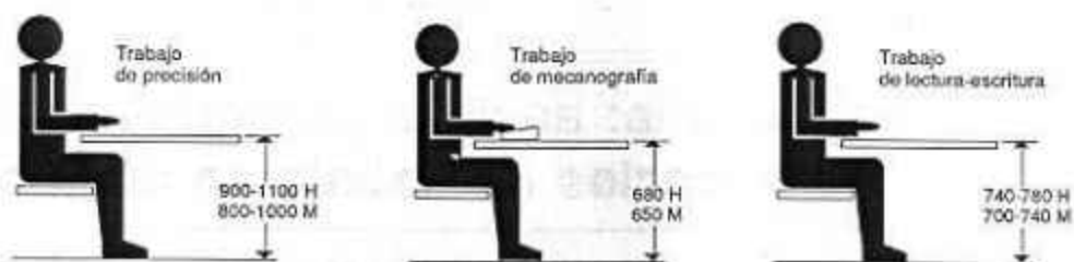
Altura del plano de trabajo para puestos de trabajo sentado (cotas en mm)
