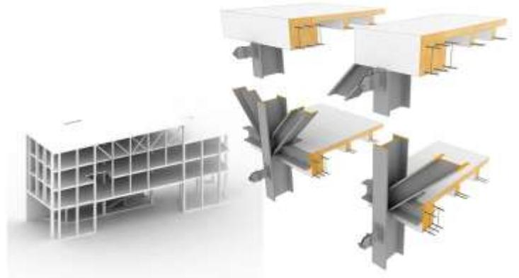
Debido a la continuidad de las esquinas del pórtico, la deformación de la viga puede reducirse mediante el grado de rigidez de los pilares.
