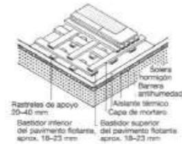
7 Construcción de un pavimento flotante
