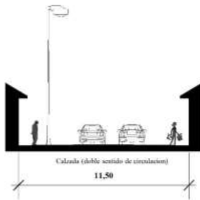
Figura 38: perfil actual Calle s/n secundaria
