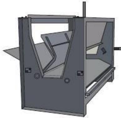
a) cajón de noqueo de ACERO INOXIDABLE. CUANDO EL CERDO ENTRA AL INMOVILIZADOR, LA PUERTA DE LA ENTRADA SE REDUCE. DESPUÉS DEL INGENIERIZADO, LA PUERTA SE ABRE PARA QUE EL ANIMAL CAIGA A UNA MESA DONDE ES USADO, TODO ELLO POR MEDIO DE UN PISTÓN HIDRÁULICO.
