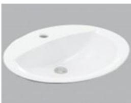
La instalación comprenderá: la colocación del artefacto, la grifería, un sifón o sifones de PVC conectados al sistema de desagüe y la conexión del grifo a la instalación de agua potable mediante el uso de piezas especiales adecuadas flexibles y cromadas, quedando prohibido el uso de " chicotillos de plomo o de plástico ".
