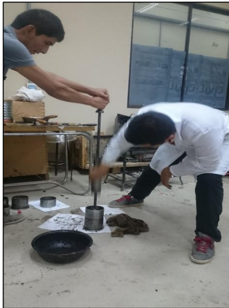
Imagen N° 4.7. Compactación de briquetas Marshall
