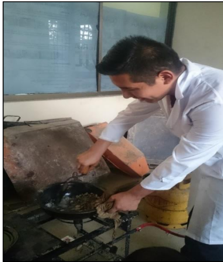
Imagen N° 4.4. Mezclando el mix de agregados con ligante asfáltico
