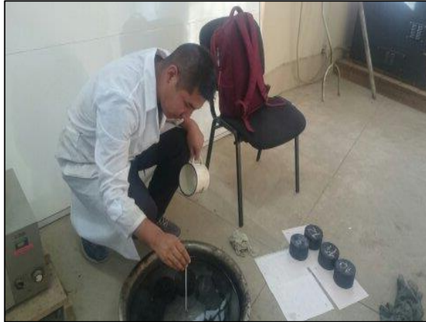
Imagen N° 4.11. Briqueta sumergida en agua a 25 °C
