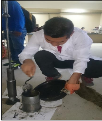
Imagen N° 4.5. Agregando la mezcla a los moldes precalentados
