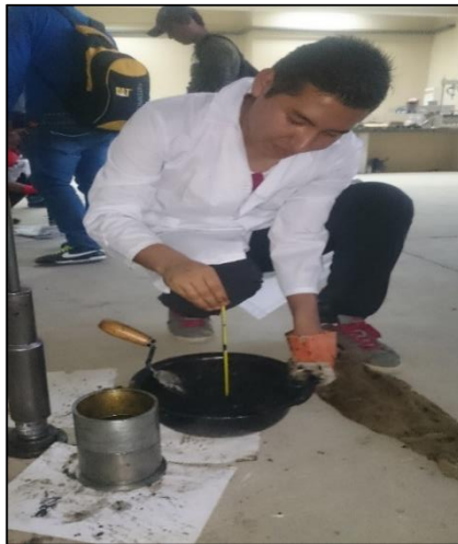
Imagen N° 4.6. Control de temperatura de la mezcla
