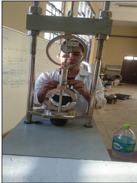
Imagen N° 4.14 Ensayo Marshall de estabilidad-flujo
