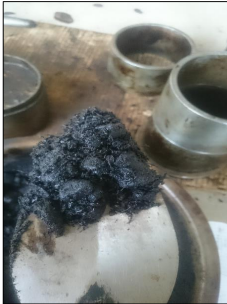
Imagen N° 4.19. Mezcla de agregados, ligante asfáltico y alambre metálico
