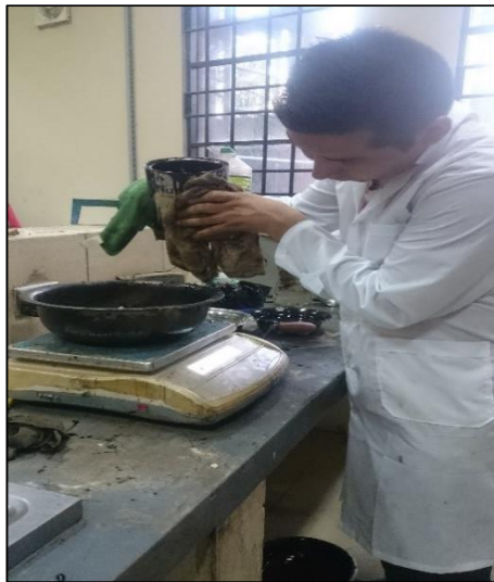
Imagen N° 4.3. Adición de ligante asfáltico al mix de agregados
