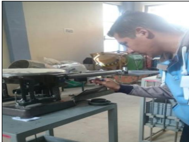
Imagen N° 4.12. Registro del peso sumergido
