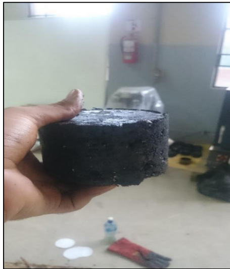
Imagen N° 4.17. Briqueta elaborada adicionando limadura metálica
