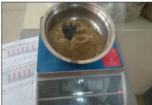
Imagen N° 4.15. Agregados pétreos adicionando limadura metálica
