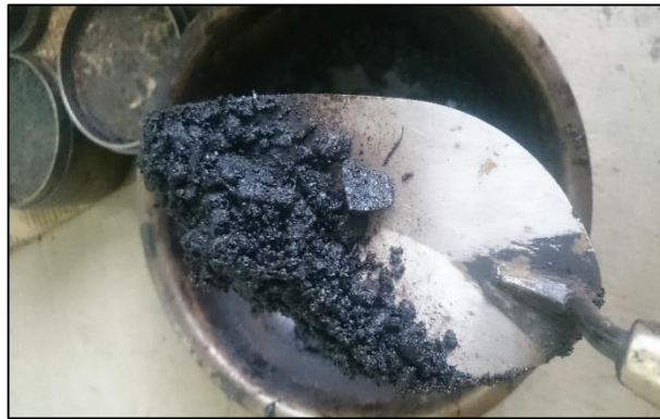
Imagen N° 4.16. Mezcla de agregados, ligante asfáltico y limadura metálica
