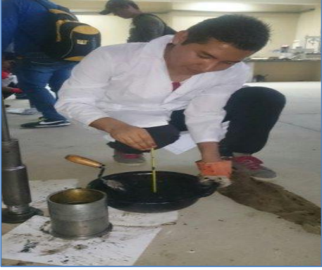
Imagen 41 Colocación de la mezcla asfáltica a los moldes a temperatura indicada
