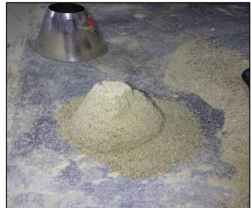
Imagen 9: Secado superficial con secadora
