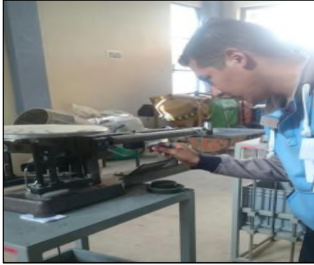
Imagen 44 Pesos de la muestra, peso sumergido y peso con superficie seca
