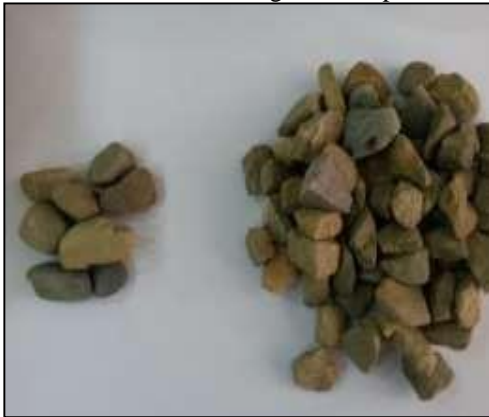
Imagen 12: Separación de fracciones según los tamices especificados
