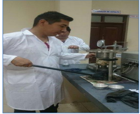
Imagen 42 Compactación y extracción de la briqueta
