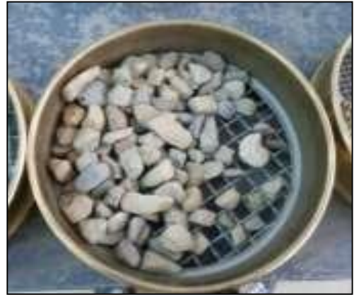
Imagen 12: Separación de fracciones según los tamices especificados
