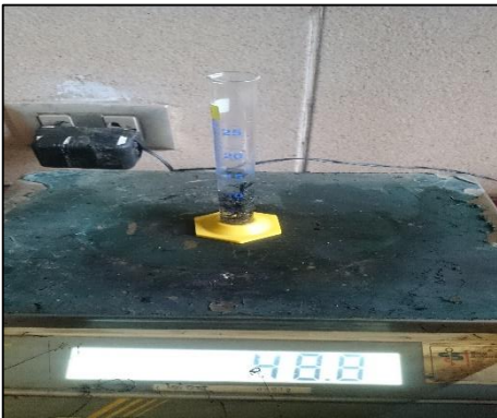
Imagen 37: Procedimiento para el peso específico del alambre metálico
