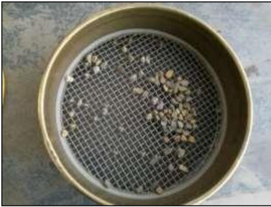
Imagen 2: Procedimiento de tamizado del agregado grueso
