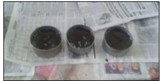
Imagen 24: Preparación de los especímenes de cemento asfáltico
