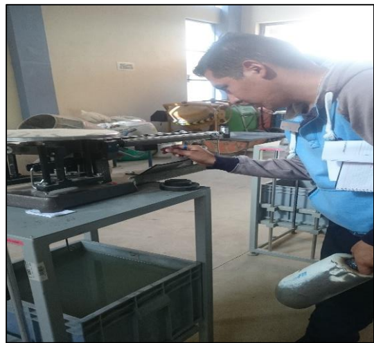
Imagen 6: Secado superficialmente del árido grueso
