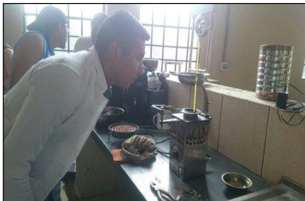
Imagen 23: Procedimiento para determinar el punto de inflamación
