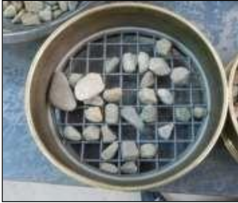
Imagen 12: Separación de fracciones según los tamices especificados
