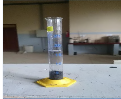
Imagen 38: Procedimiento para el peso específico del alambre metálico
