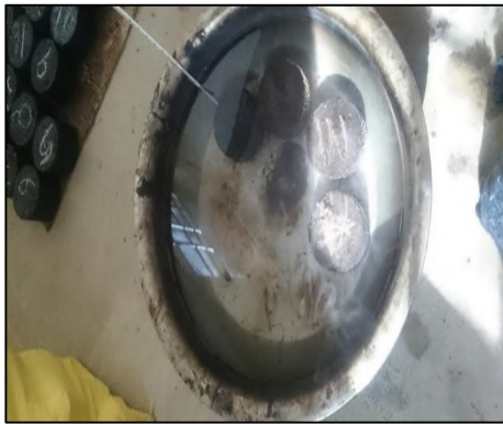
Imagen 44 Pesos de la muestra, peso sumergido y peso con superficie seca
