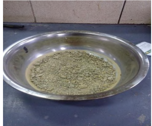
Imagen 11: Contenido del matraz que será secada en el horno, obtención del peso de la muestra seca
