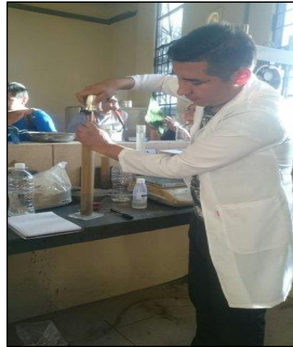
Imagen 21: Colocación del pisón en la prueba
