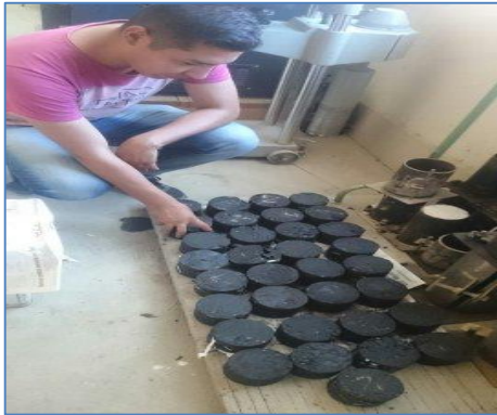
Imagen 42 Compactación y extracción de la briqueta
