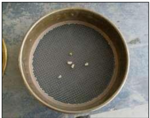
Imagen 2: Procedimiento de tamizado del agregado grueso
