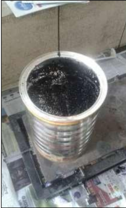
Imagen 24: Preparación de los especímenes de cemento asfáltico
