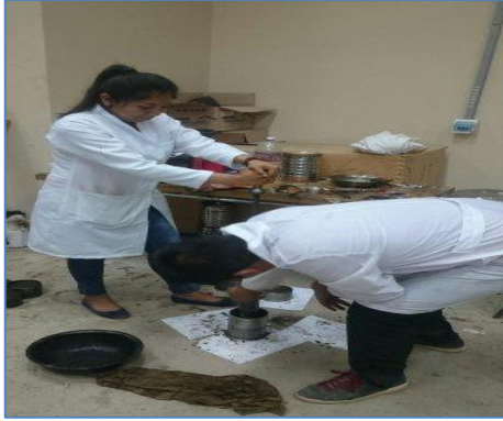
Imagen 42 Compactación y extracción de la briqueta
