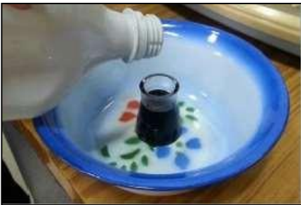
Imagen 27: Procedimiento de calibración del picnómetro
