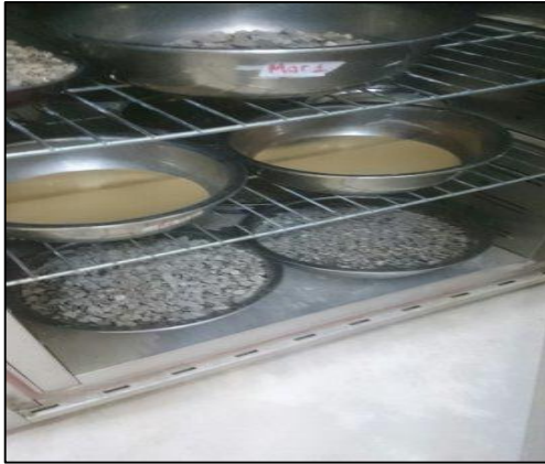
Imagen 14: Muestra de ensayo tamizado según lo especificado y secado al horno
