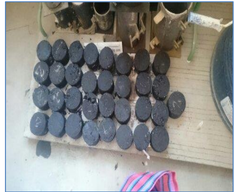
Imagen 42 Compactación y extracción de la briqueta
