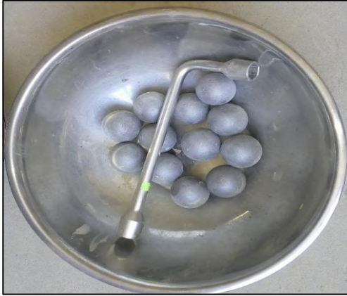
Imagen 16: Bolas de acero y el material resultante del desgaste
