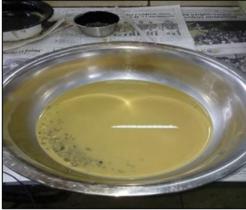
Imagen 11: Contenido del matraz que será secada en el horno, obtención del peso de la muestra seca
