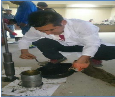
Imagen 41 Colocación de la mezcla asfáltica a los moldes a temperatura indicada
