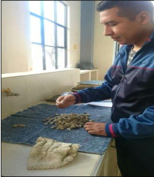
Imagen 6: Secado superficialmente del árido grueso
