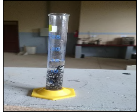
Imagen 37: Procedimiento para el peso específico del alambre metálico
