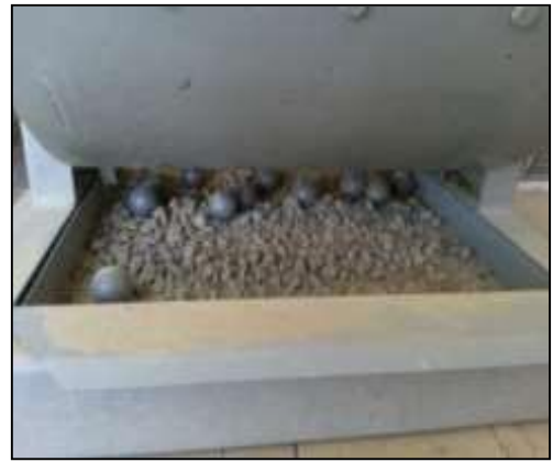
Imagen 16: Bolas de acero y el material resultante del desgaste
