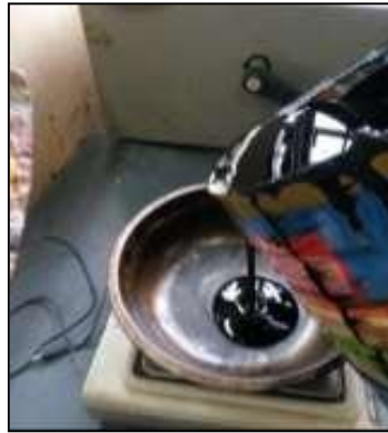
Imagen 29: Preparación de la muestra en platos correspondientes para el ensayo
