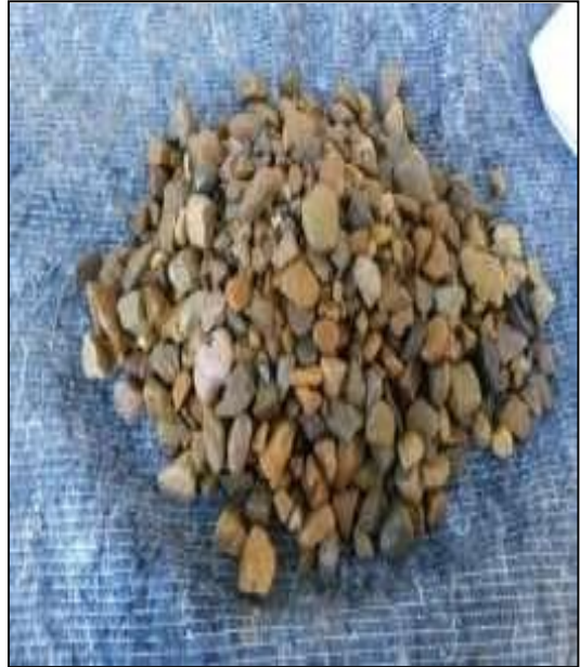
Imagen 6: Secado superficialmente del árido grueso
