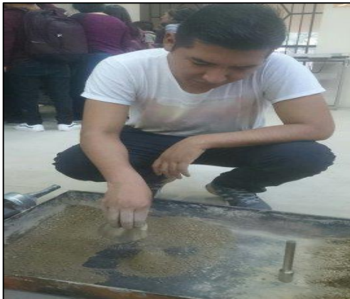
Imagen 9: Secado superficial con secadora
