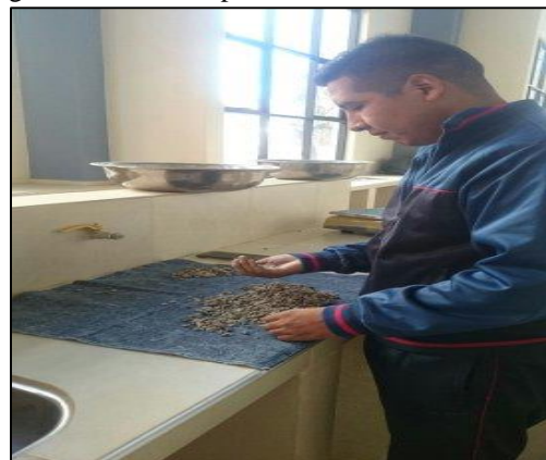
Imagen 12: Separación de fracciones según los tamices especificados
