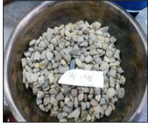
Imagen 14: Muestra de ensayo tamizado según lo especificado y secado al horno
