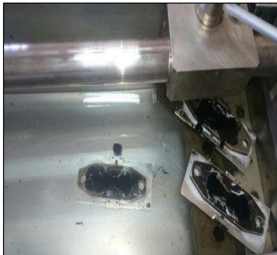
Imagen 34: Procedimiento del armado del aparato para el ensayo de ductilidad
