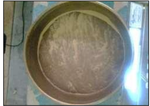
Imagen 3: Procedimiento de tamizado del agregado fino (arena)
