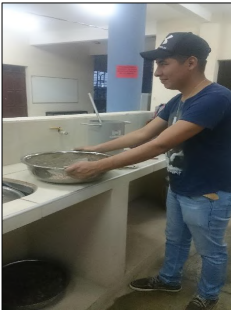
Imagen 5: Árido grueso expuesto en remojo durante 24 horas
