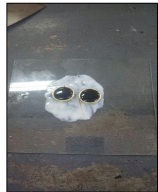
Imagen 32: Preparación de la muestra de ensayo, y posterior vertido a los anillos correspondientes
