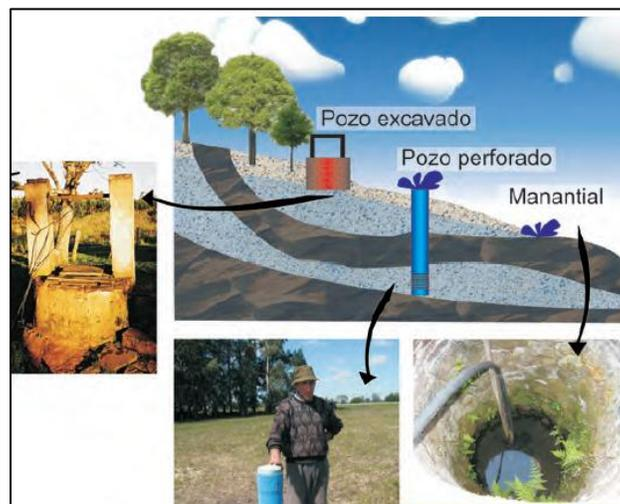
*Figura 4: Pozos excavados y perforados*
