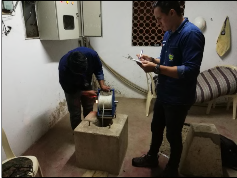
TOMA DE DATOS DE NIVELES PIEZOMÉTRICOS EN HORAS DE LA NOCHE EN EL POZO STADIUM B
