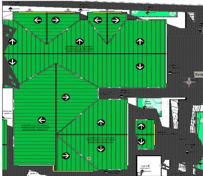
*Figura 36. Vista en planta de la cubierta del bloque principal*
