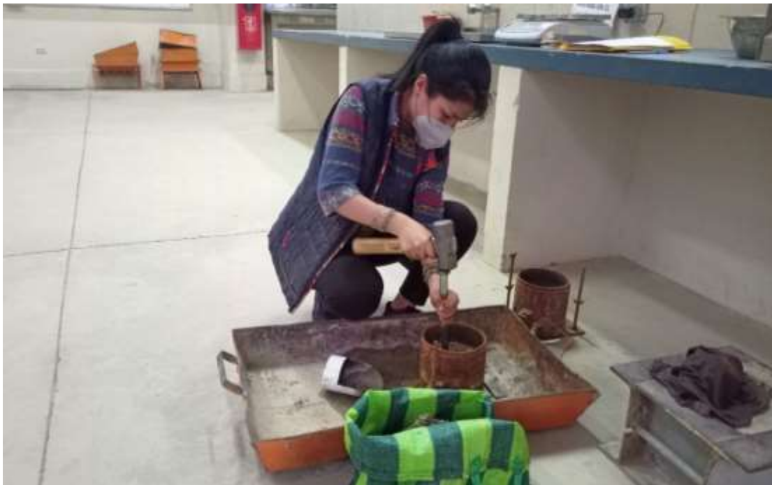
Figura 3.23. Extracción de las muestras del C.B.R.
