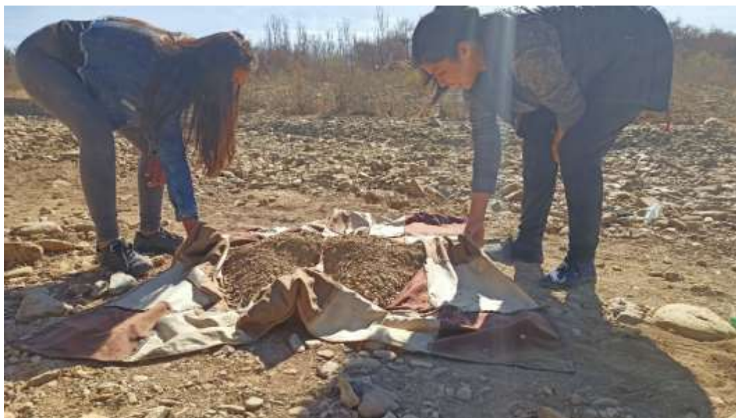
Figura 3.11. Cuarteando la muestra en el Río Pajchani
