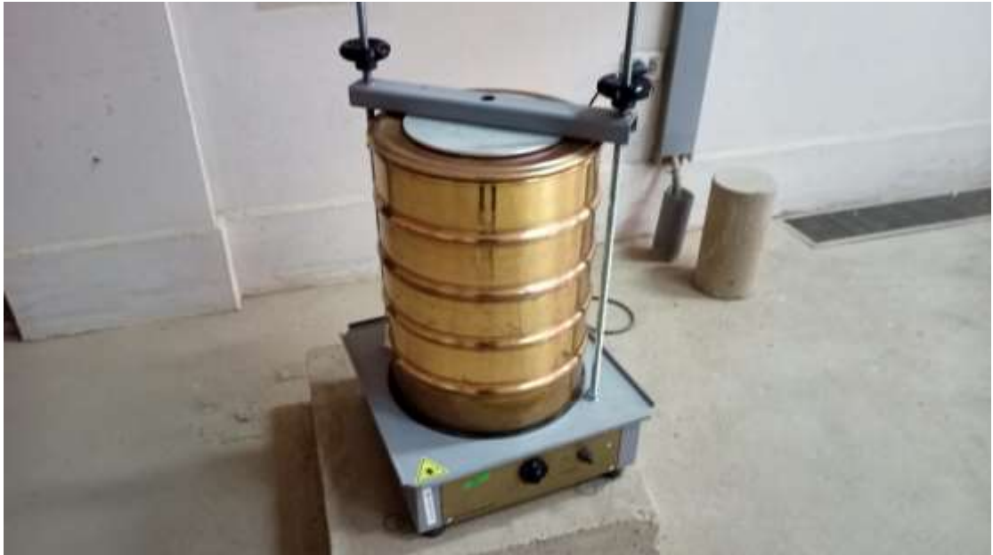
Figura 3.14. Uso del equipo de vibración automática
