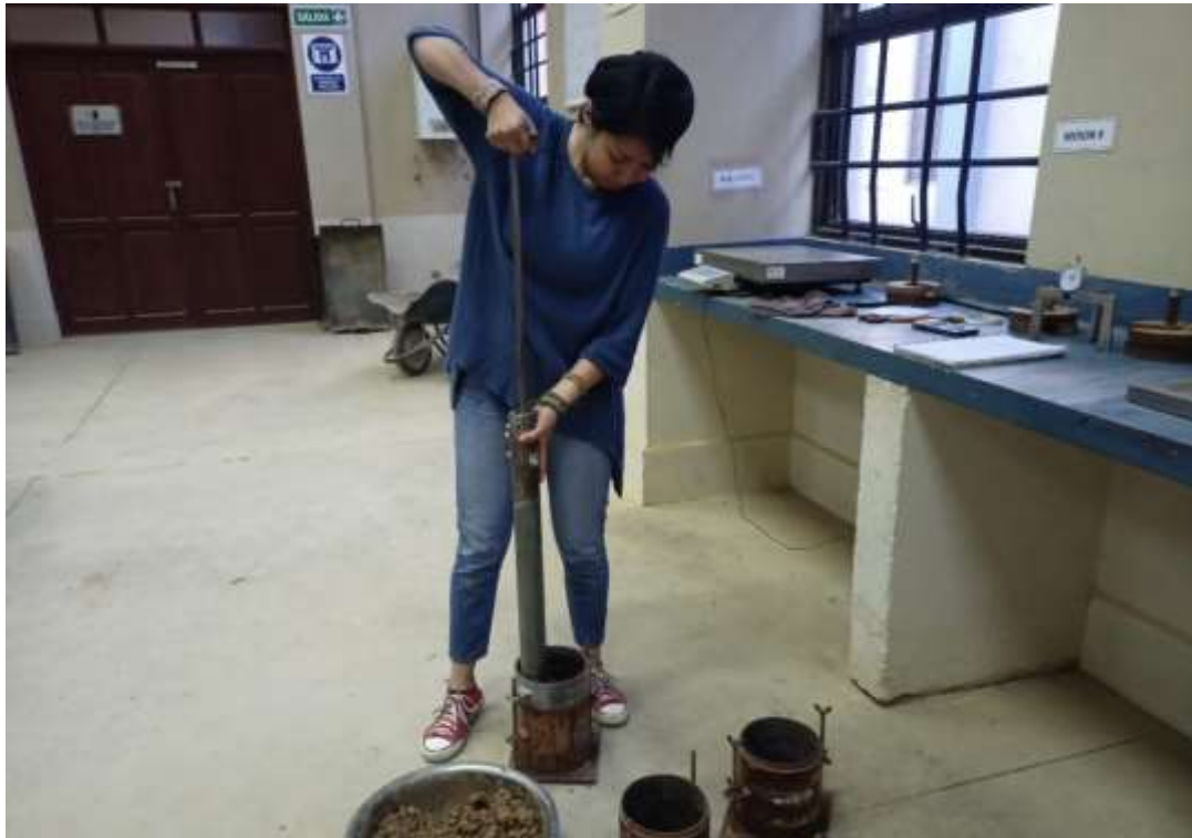
Figura 3.20. C.B.R. suelo granular.
