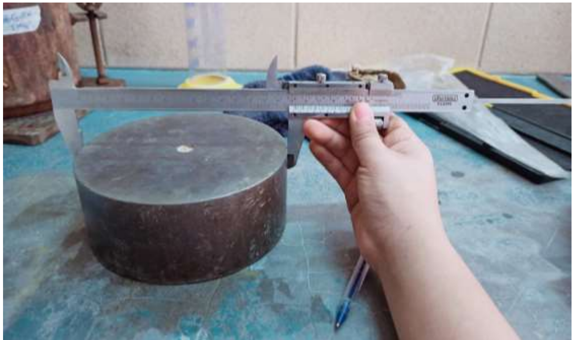
Figura 3.19. Medición de diámetro del disco espaciador.
