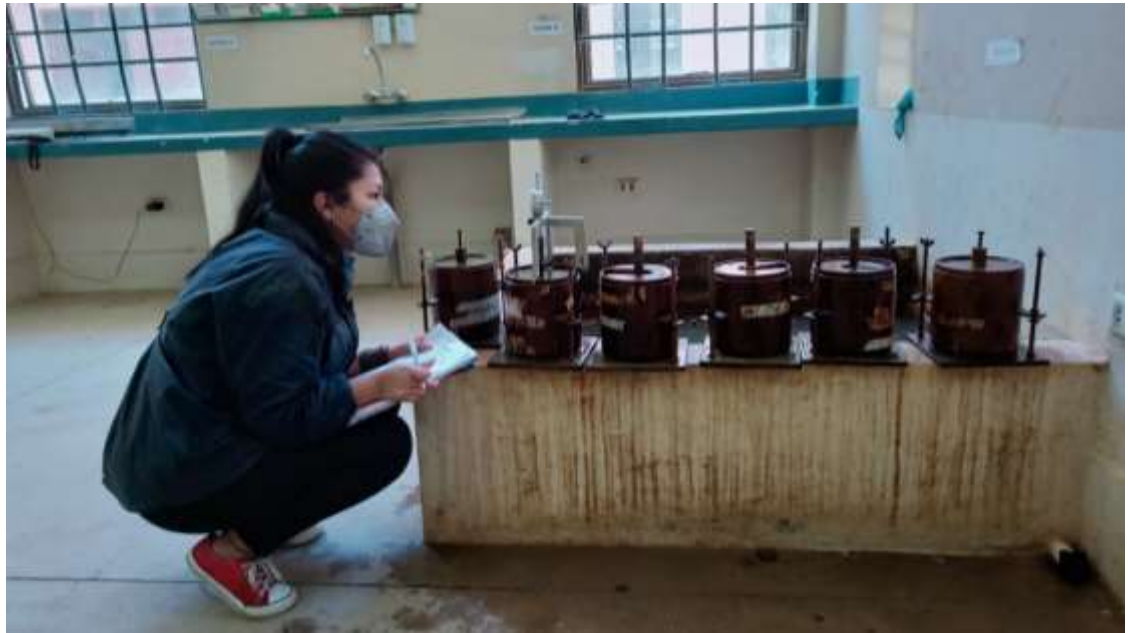
Figura 3.21. Lectura de C.B.R. con el extensómetro
