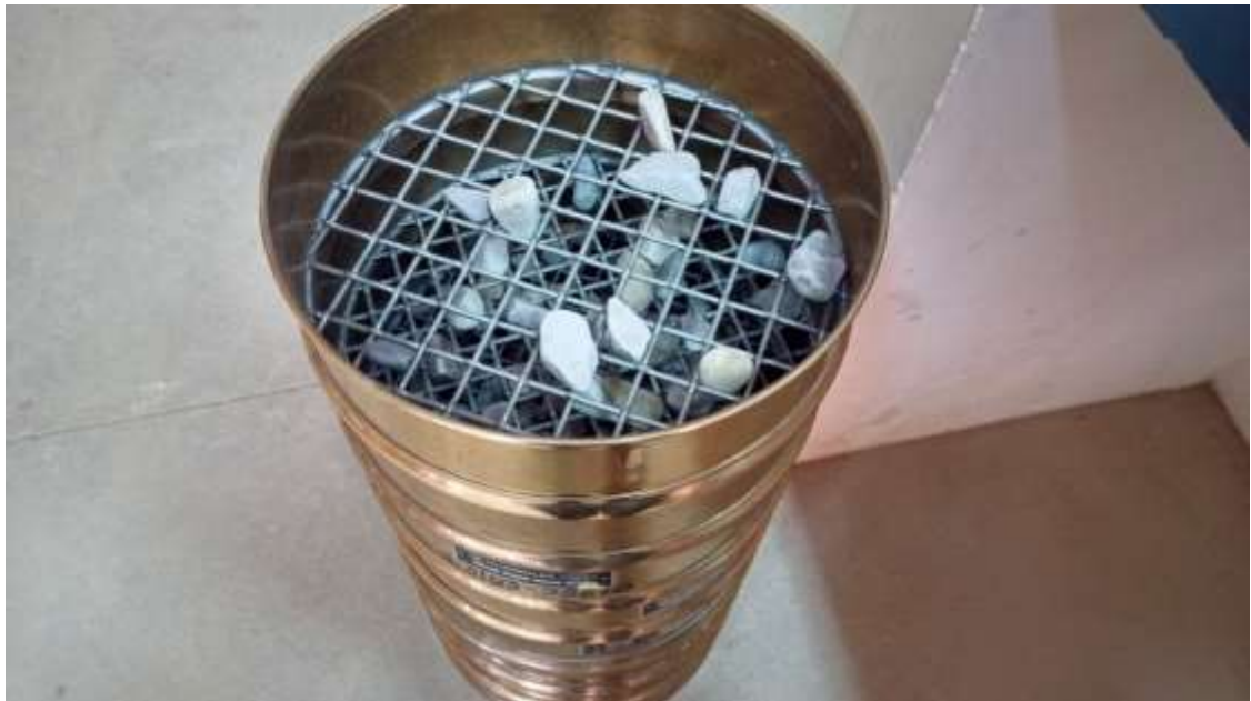
Figura 3.15. Muestra retenida del tamiz 1”
