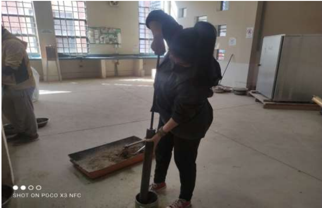
Figura 3.17. Compactación del Río Pajchani
