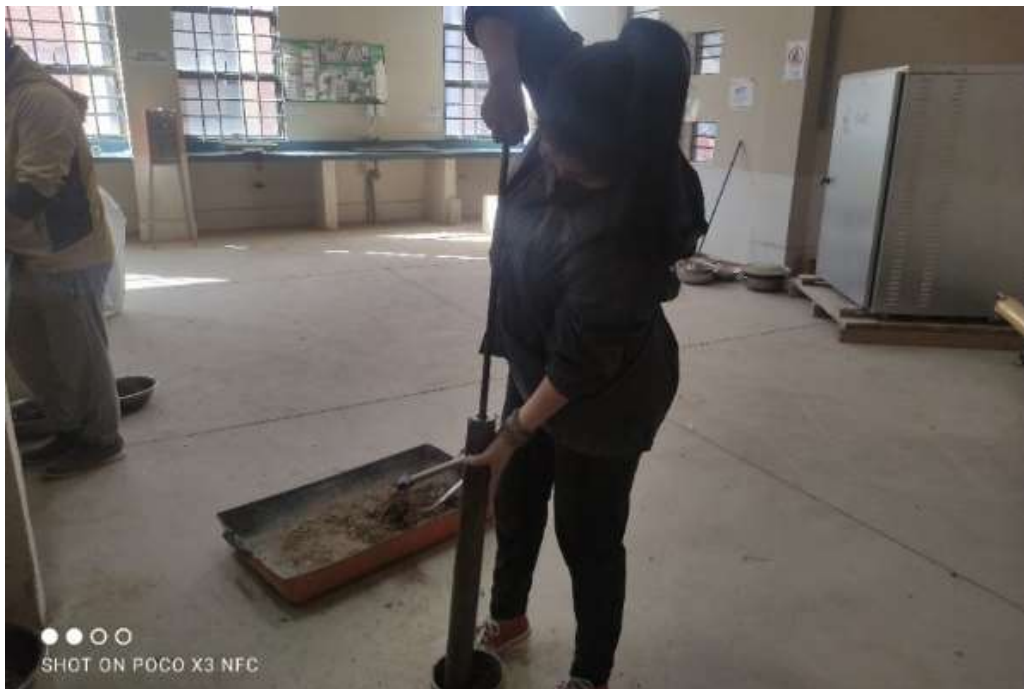
Figura 2.1. Compactación de suelo granular.
