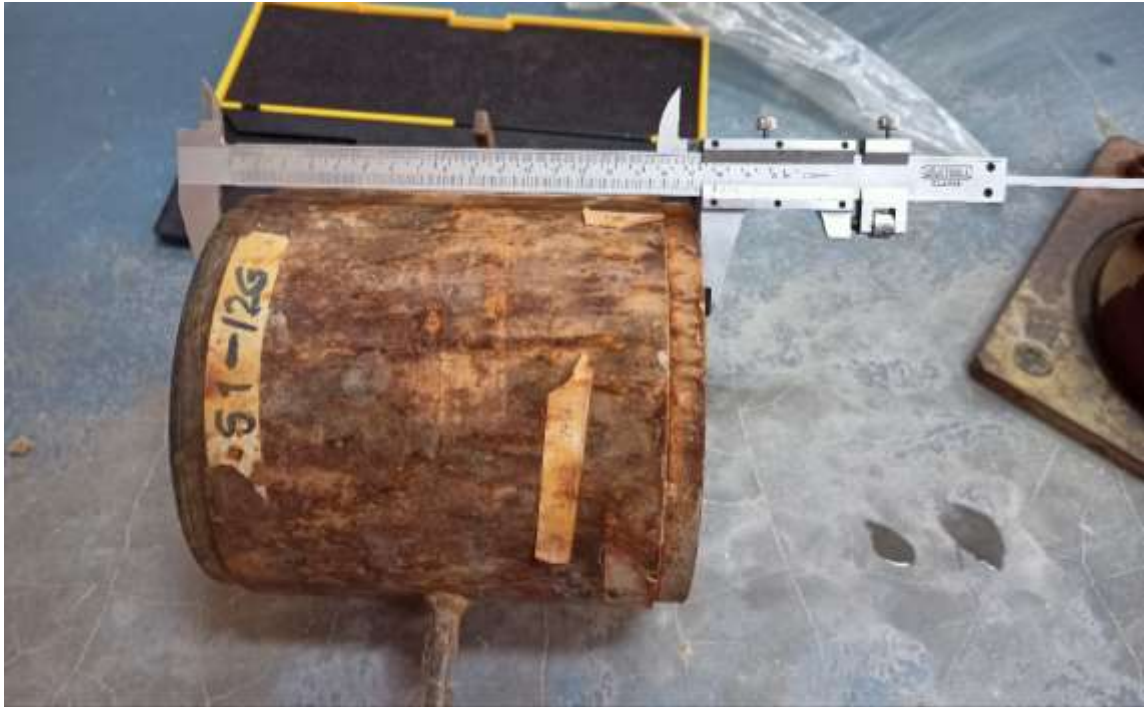
Figura 3.18. Medición de la altura del molde C.B.R.
