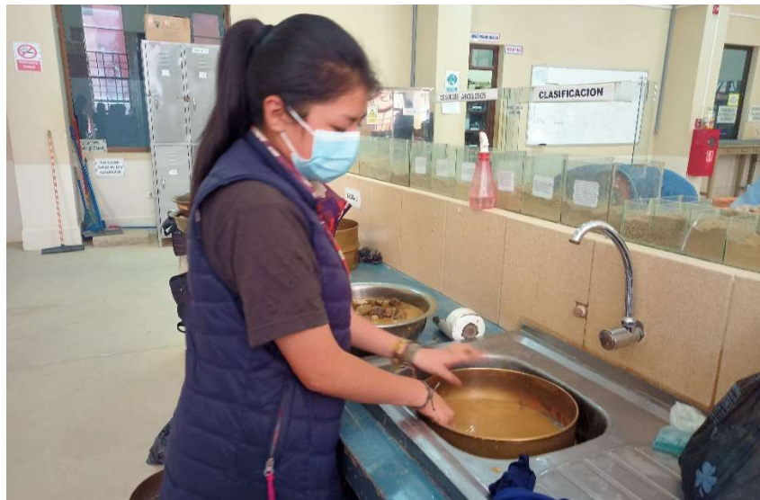
Método de lavado, usando el tamiz N°200
