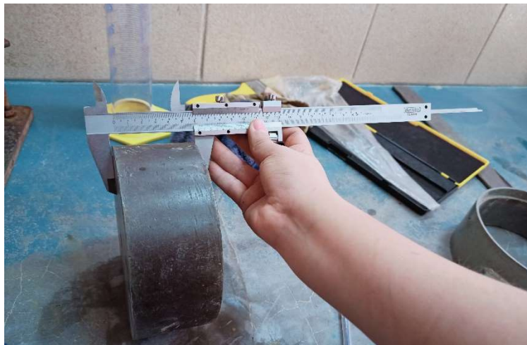
Medición de disco espaciador tanto de la altura como base.
