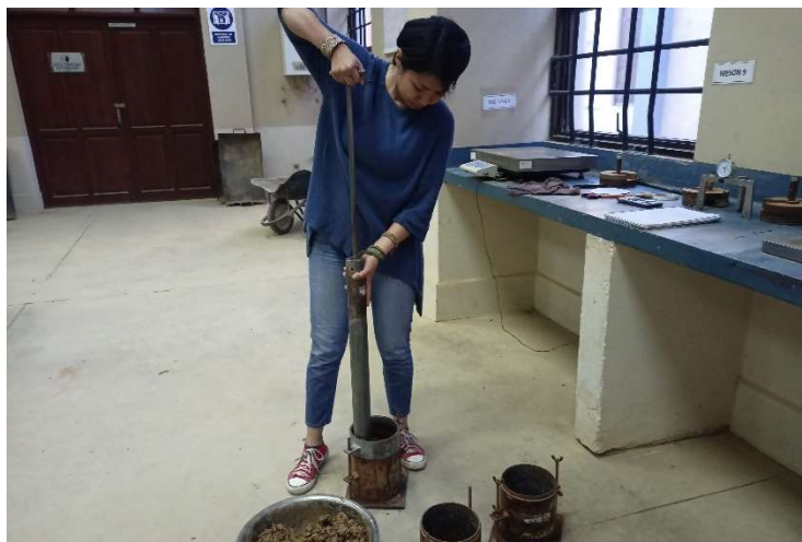
Compactación del CBR.
