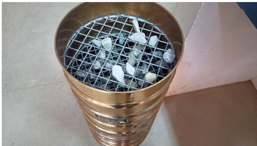
Vista en planta de la muestra retenidas en cada tamiz.
