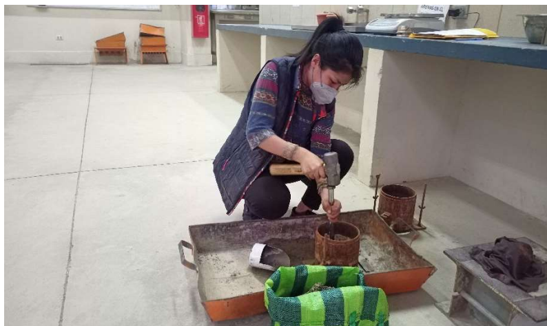
Extracción de muestras del molde luego del uso de la prensa.
