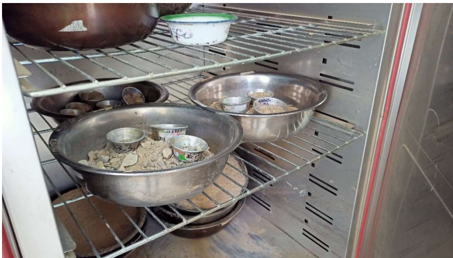
Muestra representativa para determinar el contenido de humedad
