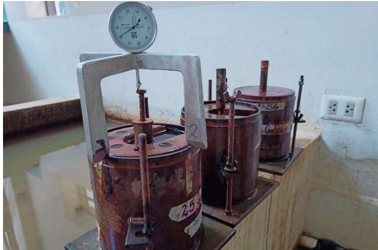
Medición de la expansión con ayuda del extensómetro.
