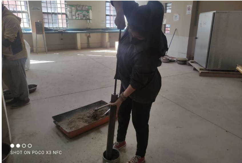
Compactación de la muestra.
