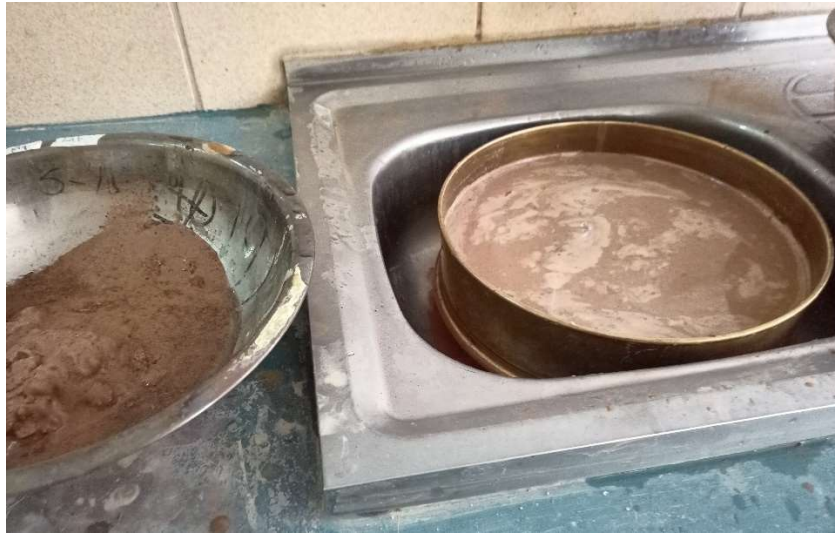
Método de lavado, usando el tamiz N°200
