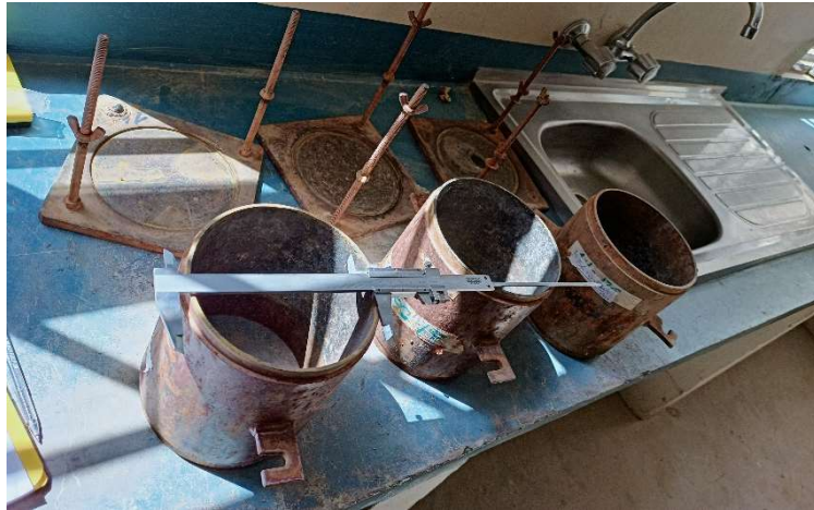
Medición de los moldes para la obtención del volumen del molde.
