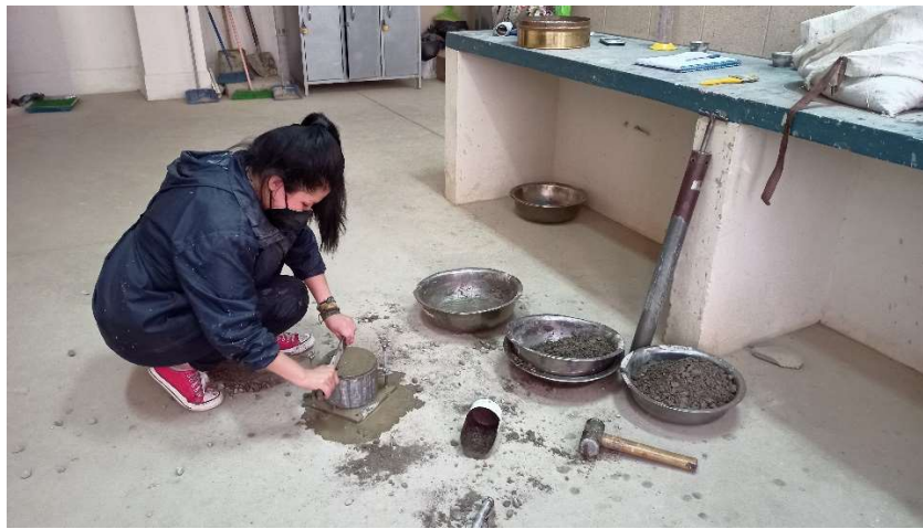
Enrasamiento con la regla metálica.
