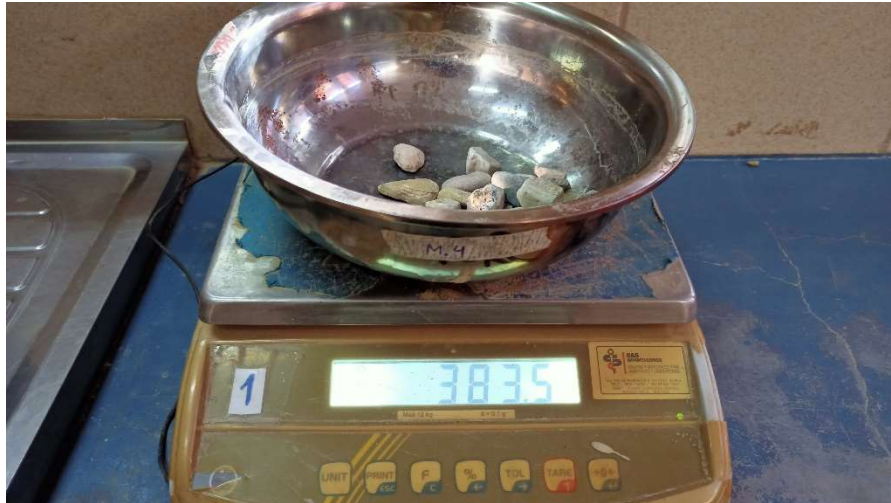
Peso de las partículas retenidas en el tamiz 1''
