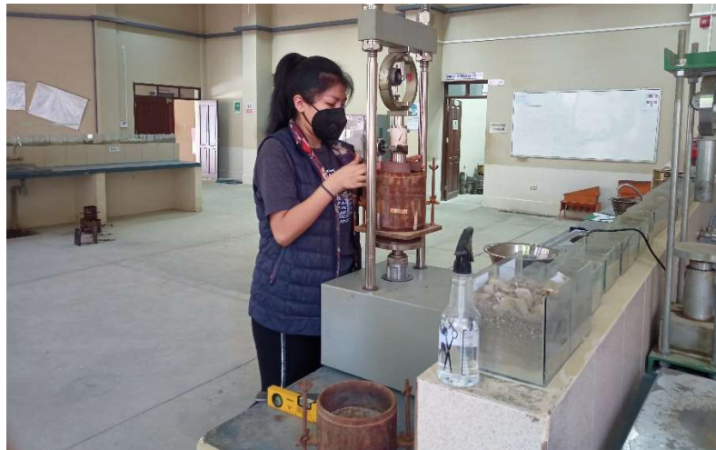
Colocación del molde en la prensa de CBR.
