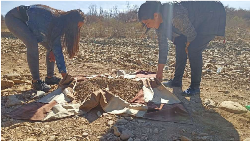
Cuardeado de la muestra para su toma representativa de todo del suelo.
