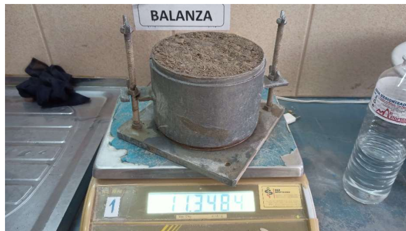
Peso de la muestra más molde luego de ser enrasada.
