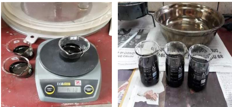
Figura 3.36. Peso del frasco + cemento asfáltico + agua
