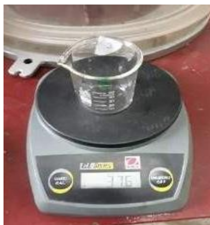
Figura 3.33. Pesaje de cada frasco para peso específico
