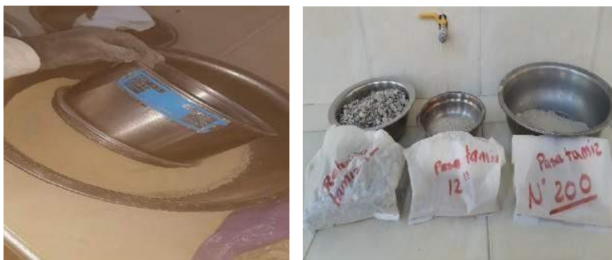
Figura 3.14. Guardado del polvo de roca que pasa tamiz N°200, para filler
