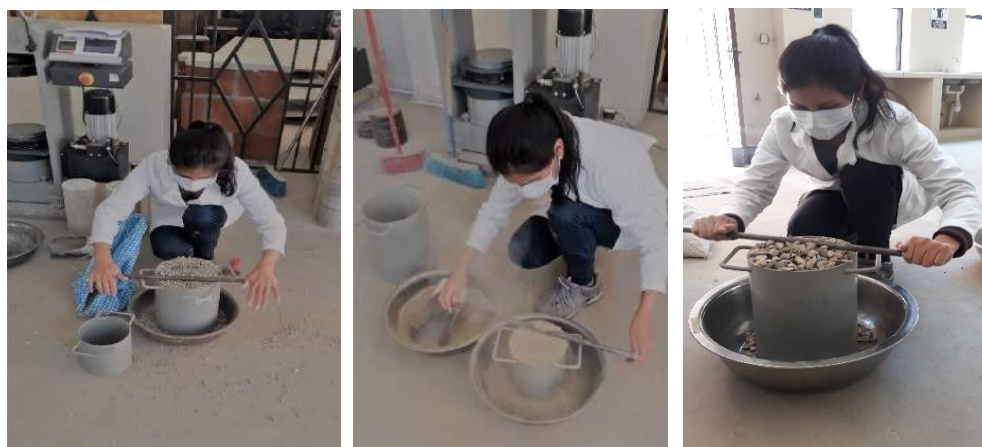
Figura 3.25. Enrasado de la muestra
