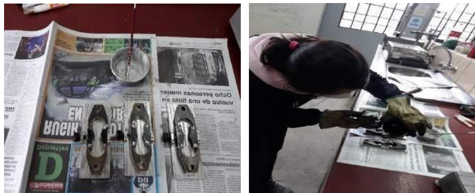
Figura 3.29. Moldes de ductilidad llenos con el cemento asfáltico
