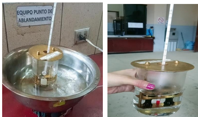
Figura 3.40. Ensayo puesto en calor con las esferas de acero
