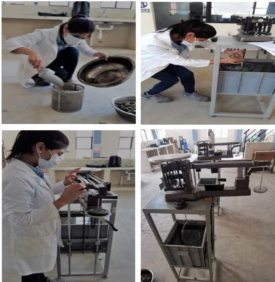
Figura 3.17. Determinación del peso sumergido
