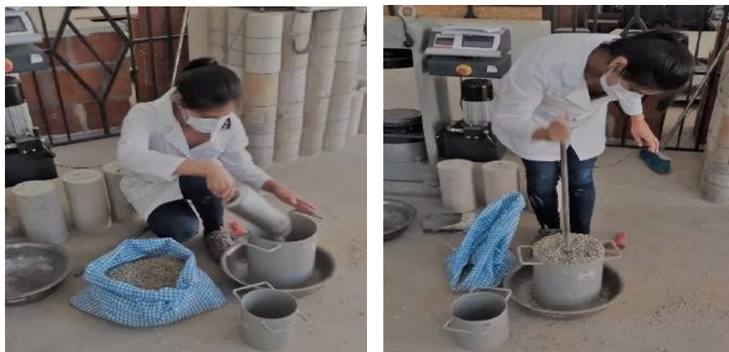
Figura 3.24. Compactado del agregado grueso en el molde de peso unitario
