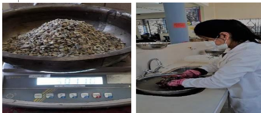
Figura 3.15. Ensayo de peso específico del agregado grueso
