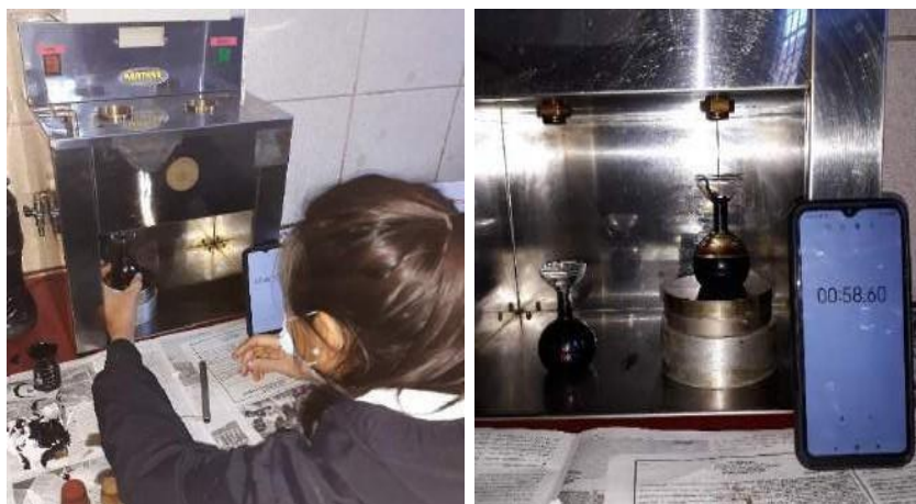
Figura 3.28. Determinación del tiempo que tarda en llenar 60 ml
