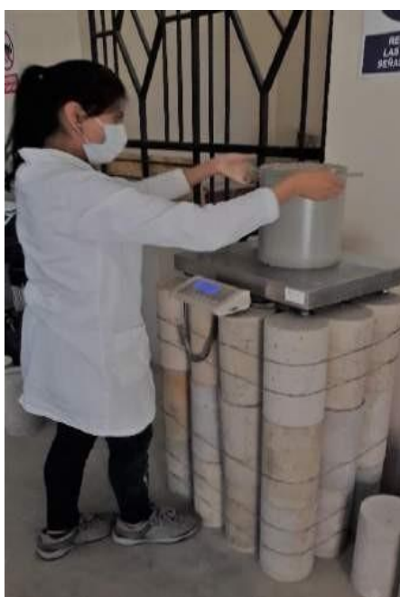
Figura 3.26. Pesaje de la muestra + molde
