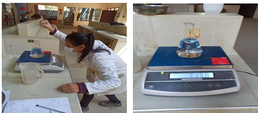
Figura 3.20. Calibración del matraz
