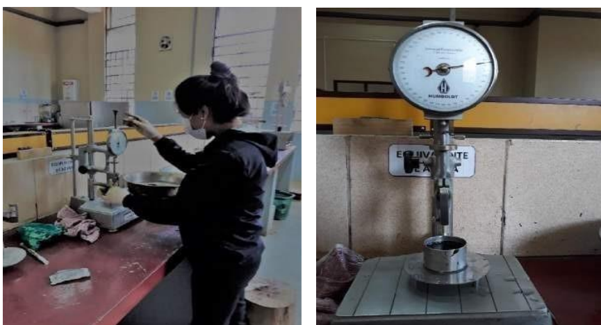
Figura 3.35. Realización del ensayo de penetración
