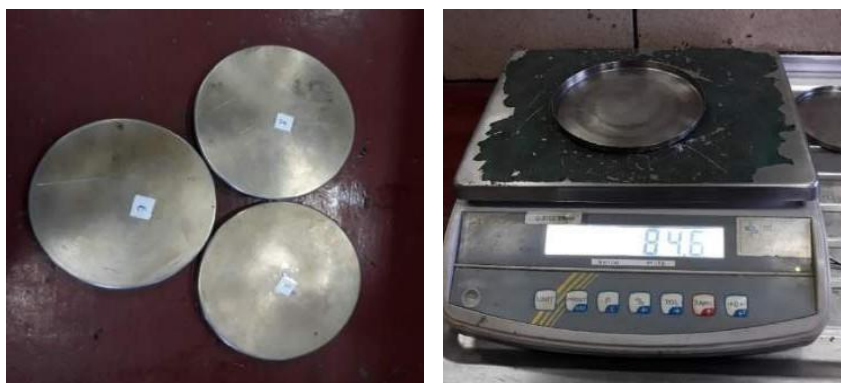
Figura 3.41. Pesaje de platillos para horno rotatorio de película delgada
