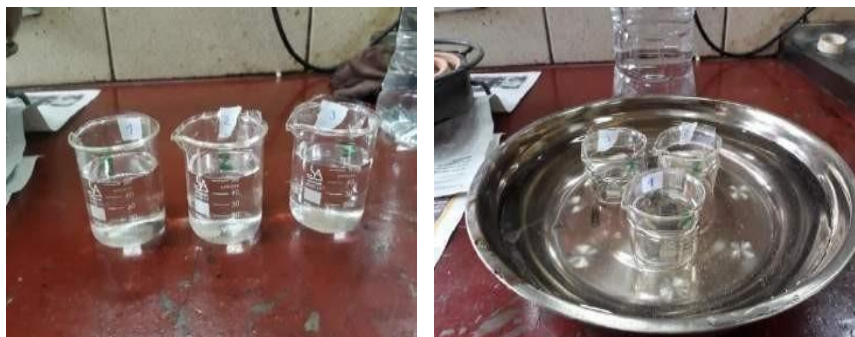
Figura 3.34. Calibración de los frascos con agua destilada en baño María a 25°C
