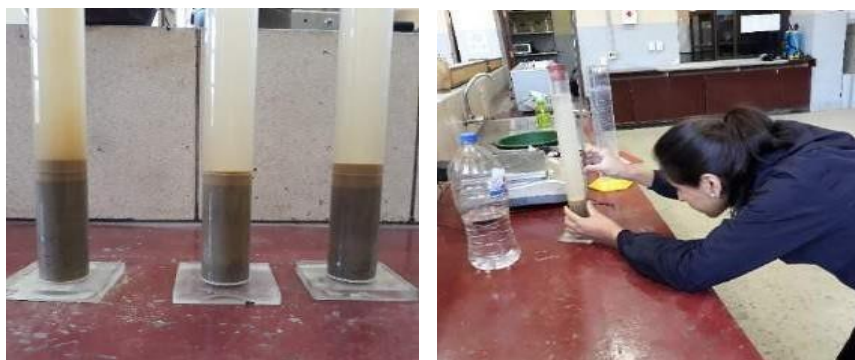
Figura 3.9. Medición de la altura de la arena
