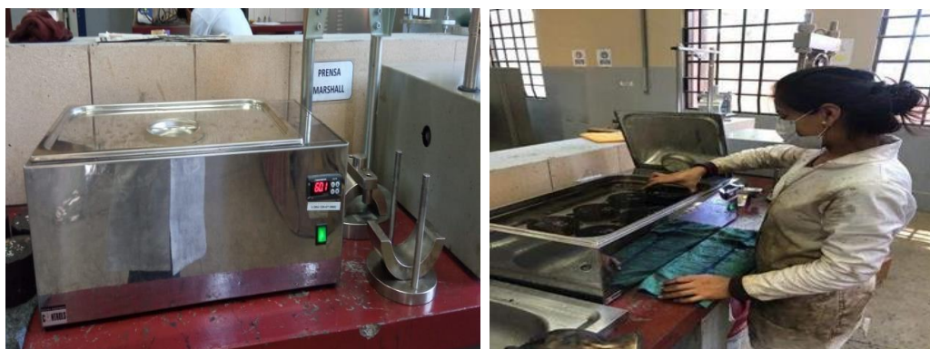
Figura 3.55. Baño María a 60 °C, previo a la rotura de las briquetas
