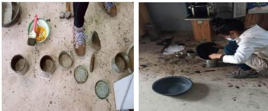
Figura 3.48. Preparación del molde con la mezcla para su compactación
