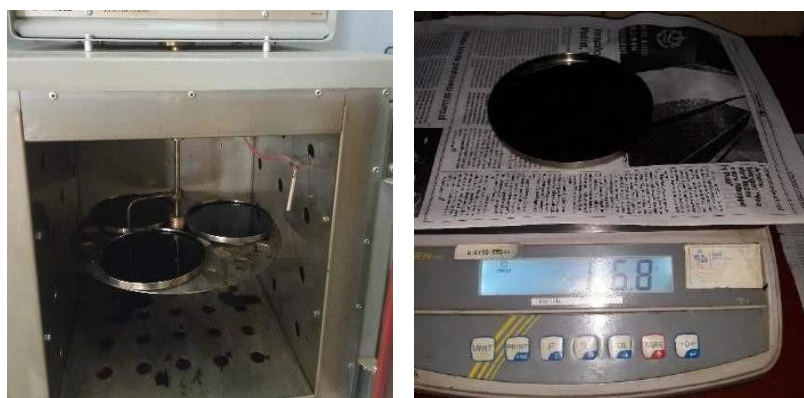
Figura 3.44. Pesado del platillo + muestra después de 5 hr en el horno
