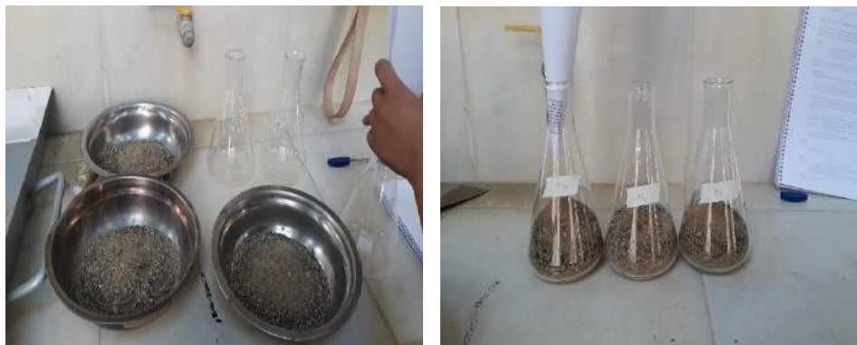
Figura 3.21. Peso superficialmente seco de cada muestra en un matraz
