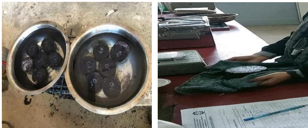
Figura 3.53. Determinación del peso saturado con superficie seca
