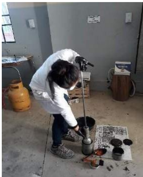
Figura 3.49. Compactado de la mezcla
