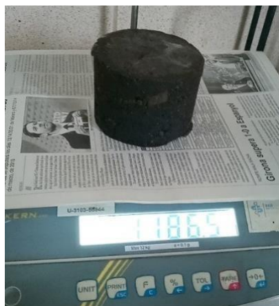
Figura 3.52. Determinación del peso seco de la muestra
