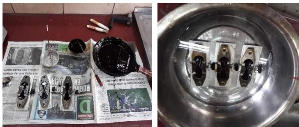
Figura 3.30. Moldes en baño María a 25°C
