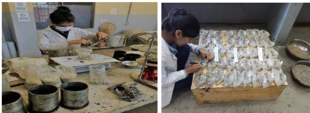
Figura 3.44. Pesaje de los agregados para la elaboración de briquetas
