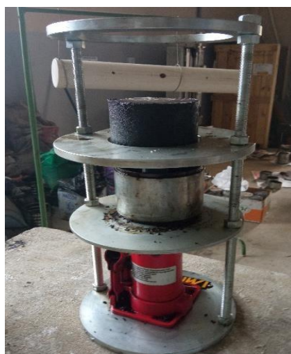
Figura 3.50. Extracción de las briquetas de los moldes
