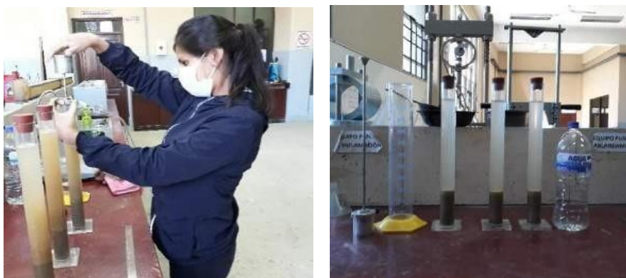
Figura 3.8. Defloculante actuando en la separación del filler de la arena
