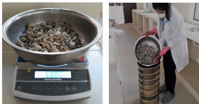
Figura 3.4. Peso del agregado y vaciado a los tamices
