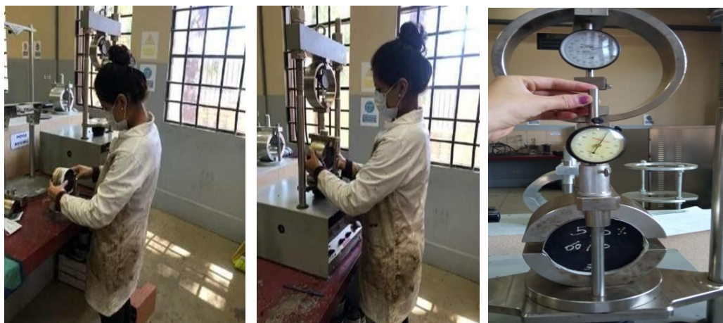
Figura 3.57. Rotura de briquetas en la prensa Marshall
