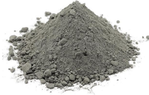
Figura 2.10. Llenante mineral cemento Portland IP-30
