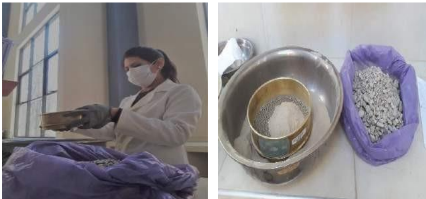
Figura 3.13. Tamizado del agregado triturado en el tamiz N°12
