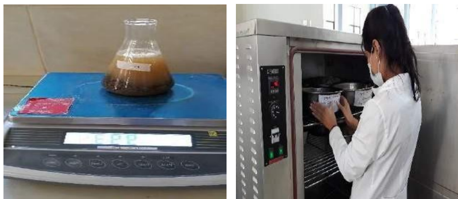
Figura 3.22. Pesaje del matraz + agua + muestra y secado por 24h
