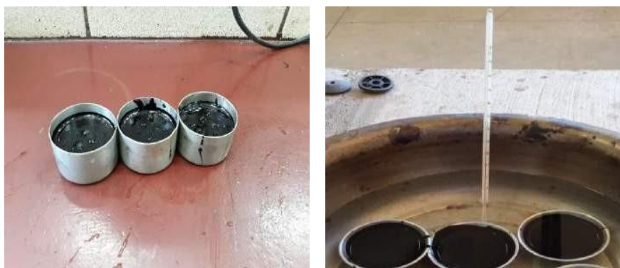
Figura 3.37. Cemento asfáltico en los moldes de penetración a 25°C en baño María
