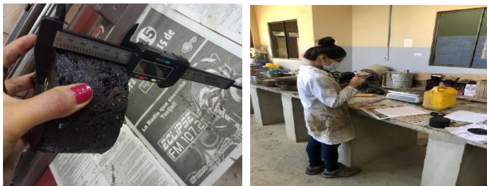
Figura 3.51. Determinación de las dimensiones de la briqueta
