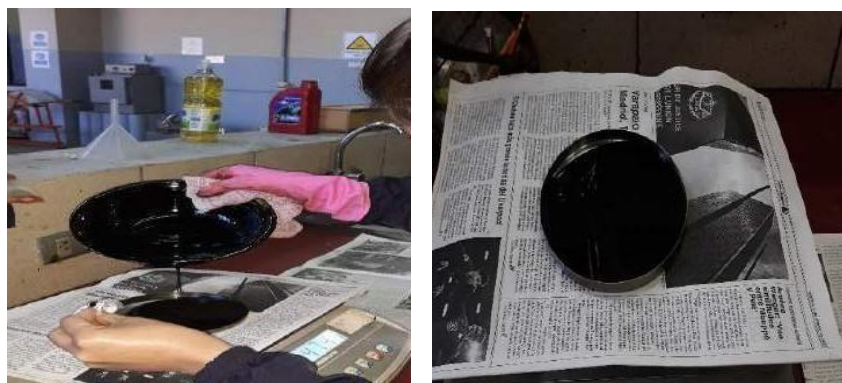
Figura 3.42. Peso del cemento asfáltico + planillo antes de llevar al horno
