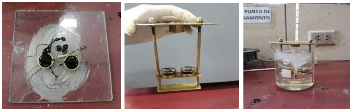
Figura 3.39. Anillos con cemento en baño María invertido a 5°C
