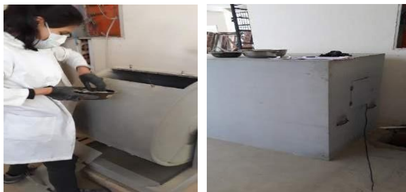
Figura 3.11. Introduciendo la muestra y las cargas abrasivas
