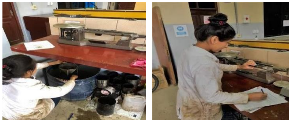
Figura 3.54. Determinación del peso sumergido de las briquetas
