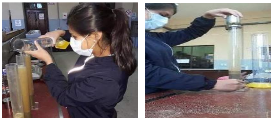
Figura 3.7. Defloculante para el ensayo equivalente de arena
