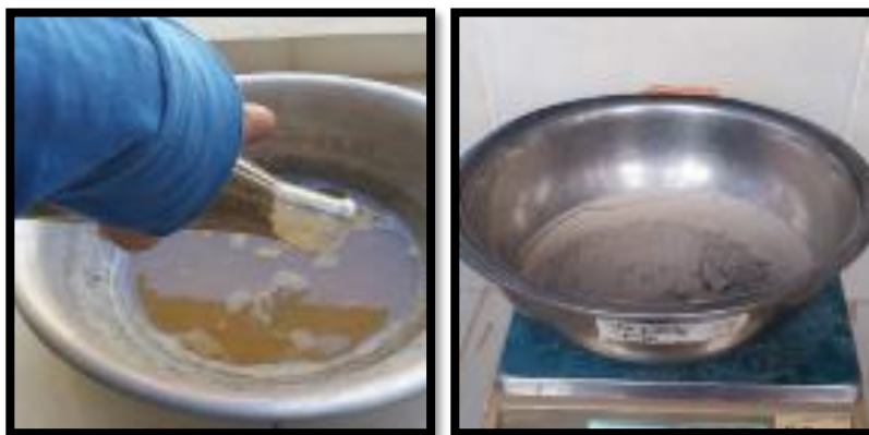
Figura 4.26 Agitando el matraz y vaciando en un plato toda la muestra esté listo para introducir al horno y pesar posteriormente
