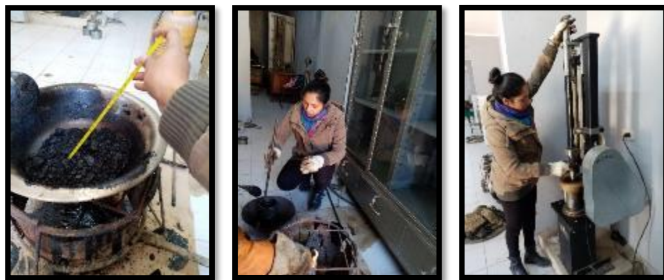
Figura 4.52 Preparación de la mezcla y compactación de la briqueta.
