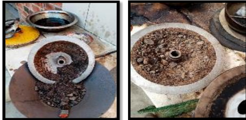
Figura 4.49 Contenido de cemento asfáltico del RAP.
