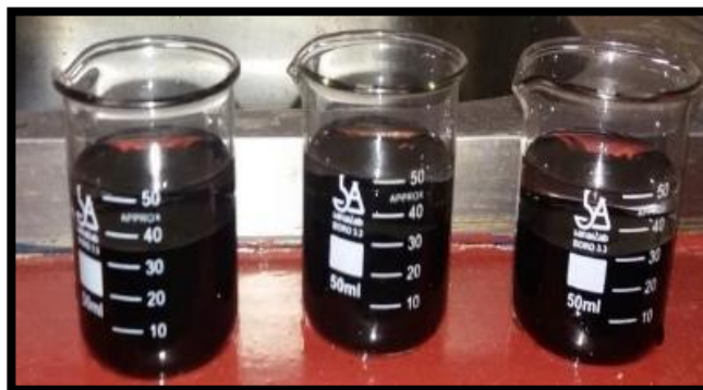
Figura 4.40 Luego se procede agregar el agua destilada hasta los 50 ml y se deja por 30 minutos en agua y luego se procede al pesaje
