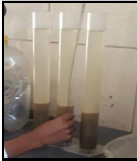
Figura 4.14 Mezclando de la muestra con agua y el defloculante
