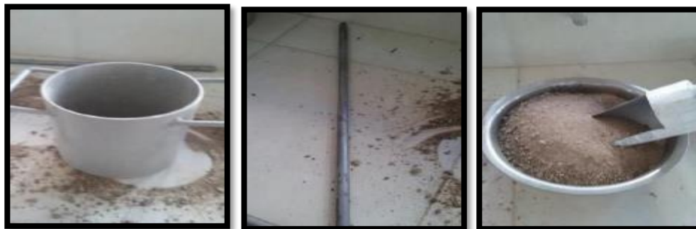
Figura 4.15 Materiales para el ensayo, molde de 3 L, varilla y la muestra de arena
