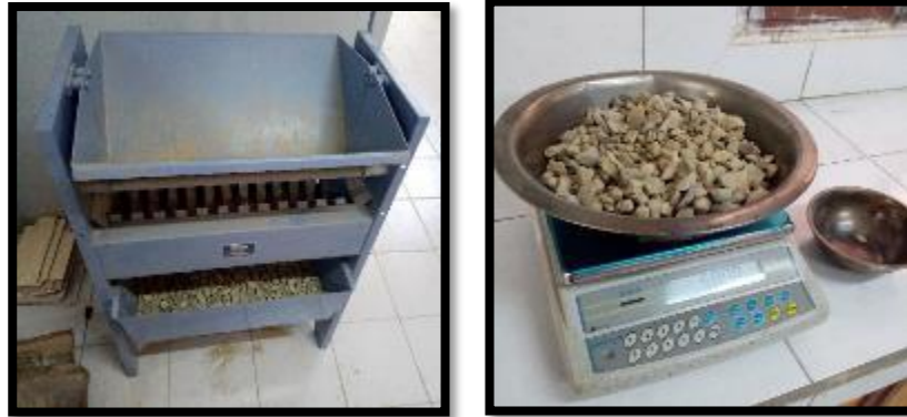
Figura 4.10 Cuarteo del agregado grueso “grava” y pesaje
