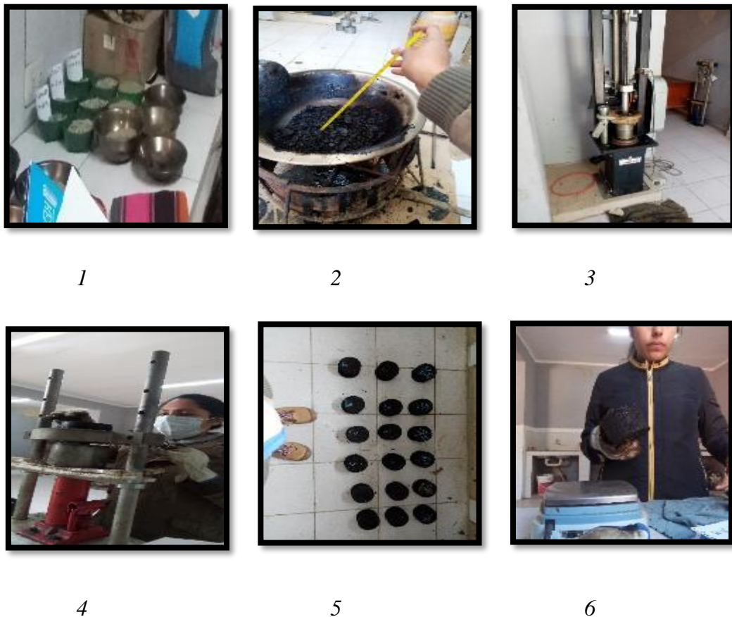
Figura 4.41 Procedimiento del ensayo de Marshall para la determinación del óptimo de cemento asfáltico
