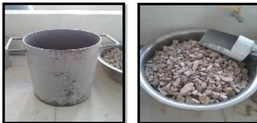
Figura 4.17 Materiales para el ensayo, molde de 10 L, varilla y la muestra de grava
