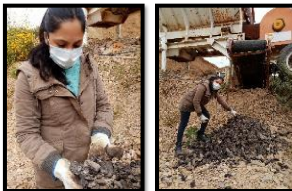
Figura 4.45 Materiales triturados RAP.
