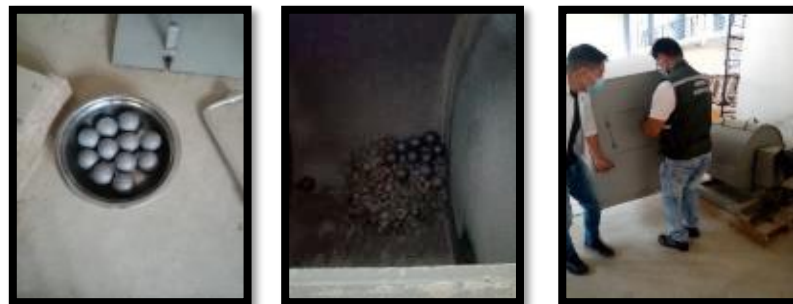
Figura 4.31 Máquina de los Ángeles donde introducimos las muestras de los 2 recipientes.
