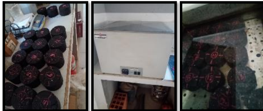
Figura 4.57 Reposo previo a la ruptura de briqueta en la prensa Marshall
