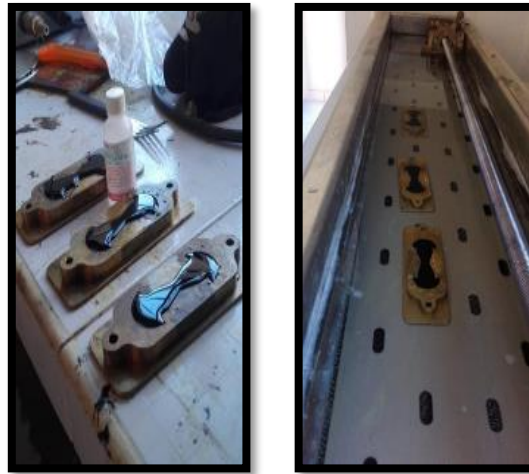
Figura 4.36 Colocar cemento asfáltico en los moldes dejando por 30 minutos secando; enrasar y posteriormente dejarlo en el agua por 30 minutos.
