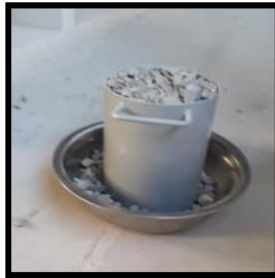
Figura 4.19 Volumen compactado de la grava
