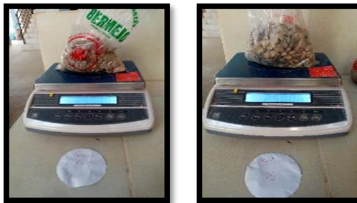
Figura 4.30 Tamizado de muestra por los tamices 1/2" y 3/8" peso retenido de 2500 gr.
