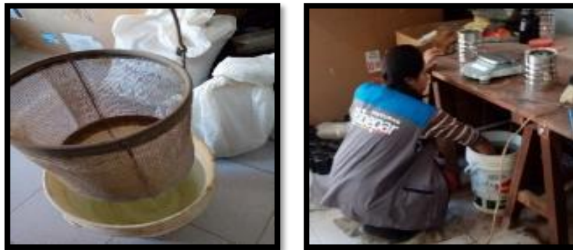
Figura 4.28 Introducción la muestra al canastillo para luego obtener el peso de la muestra saturada, peso sumergido y con superficie seca.
