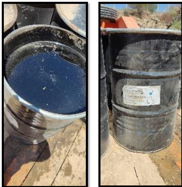
Figura 4.9 Cemento asfáltico 85/100 procedencia colombiana.
