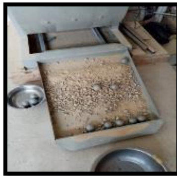
Figura 4.32 Una vez terminado las 500 revoluciones, hacemos girar la máquina para que salga la muestra desgastada.
