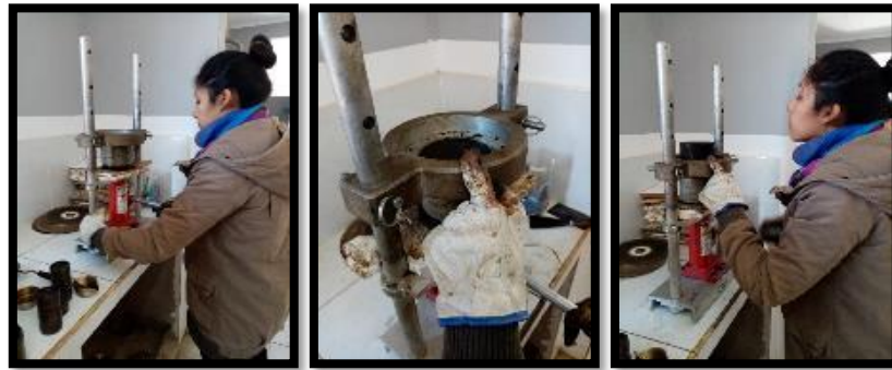
Figura 4.53 Extracción de la briqueta del molde
