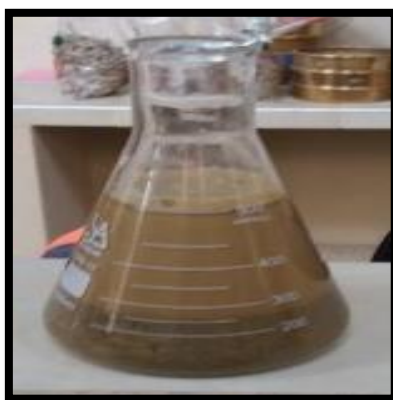
Figura 4.25 Llenando de agua al matraz con muestra
