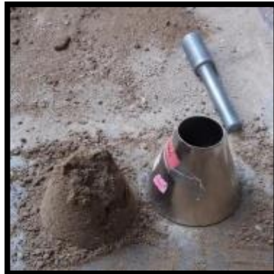
Figura 4.22 Introduciendo la muestra en el cono en 3 capas con 25 golpes y enrasando después del secado
