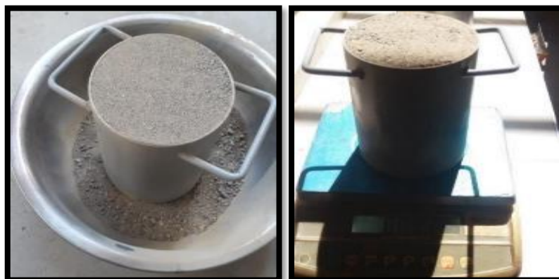
Figura 4.16 Volumen suelto de arena
