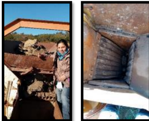
Figura 4.43 Se procedió a triturar el material en la chancadora de Santa Ana Chancadora de mandíbulas
