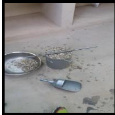
Figura 4.18 Volumen suelto de la grava
