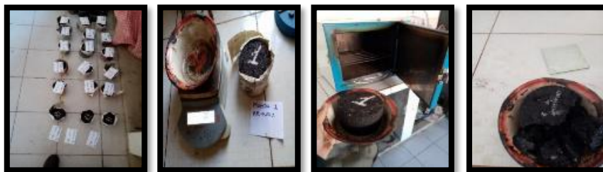
Figura 4.59 Pesaje y ablandamiento de la briqueta con mezcla reciclada
