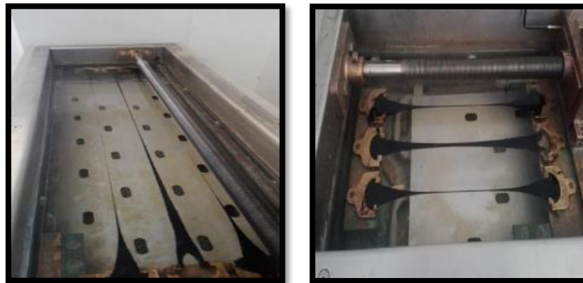
Figura 4.37 Colocando los moldes en el ductilímetro después de los 30 min en agua.
