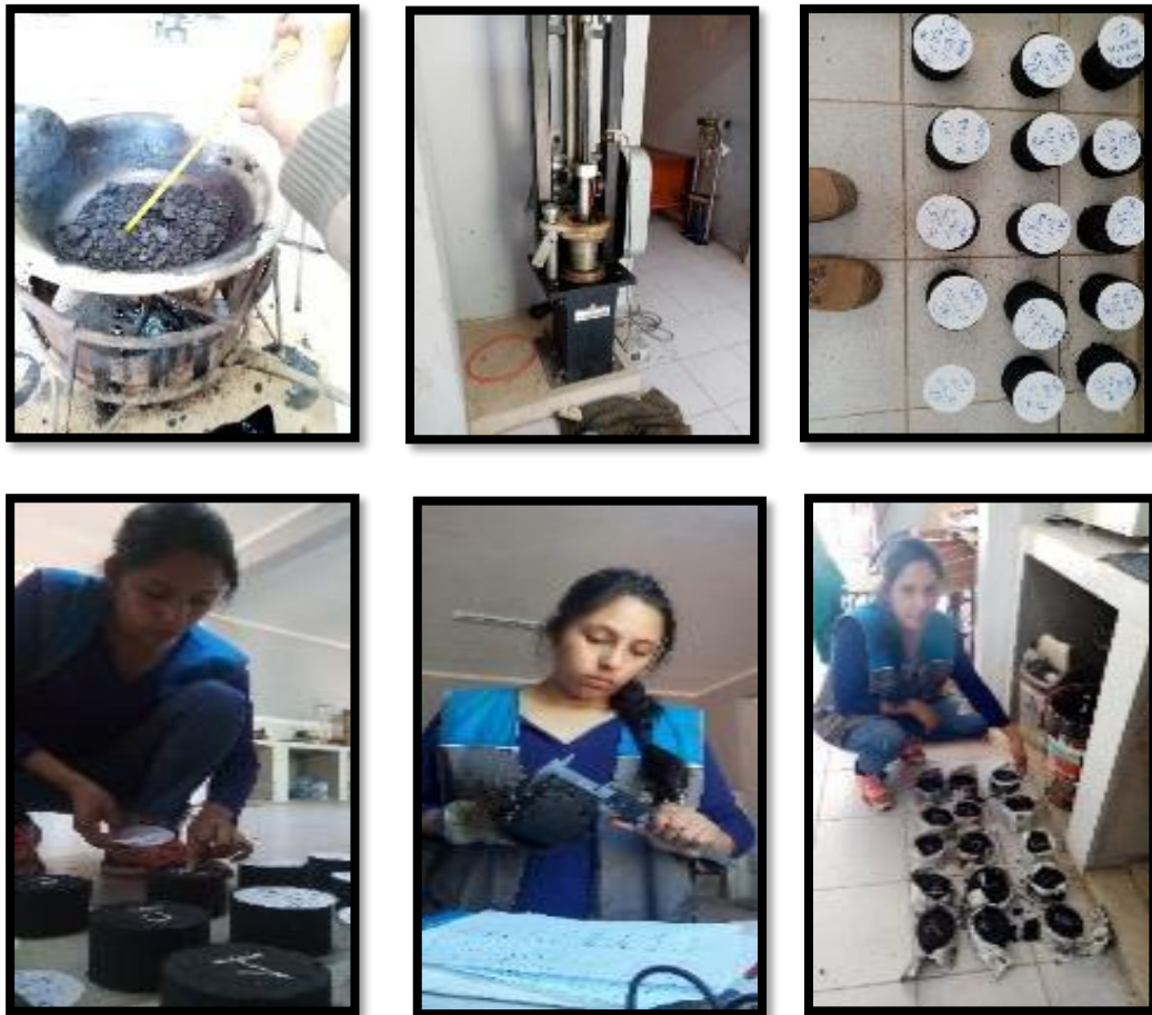
Figura 4.63 Procedimiento ensayo Marshall mezcla reciclada con 20% de RAP.
