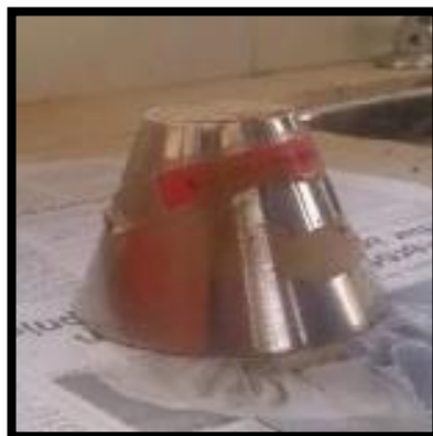
Figura 4.23 Verificación que la Muestra de Arena seca
