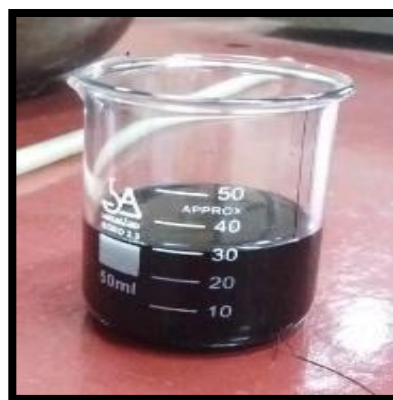
Figura 4.39 Se debe llenar el vaso precipitado del ligante asfáltico y dejarlo por 30 minutos
