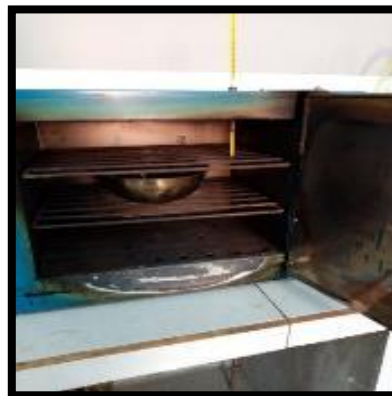
Figura 4.29 Vaciado de la muestra saturada en un recipiente para secado en horno y proceder al pesaje.
