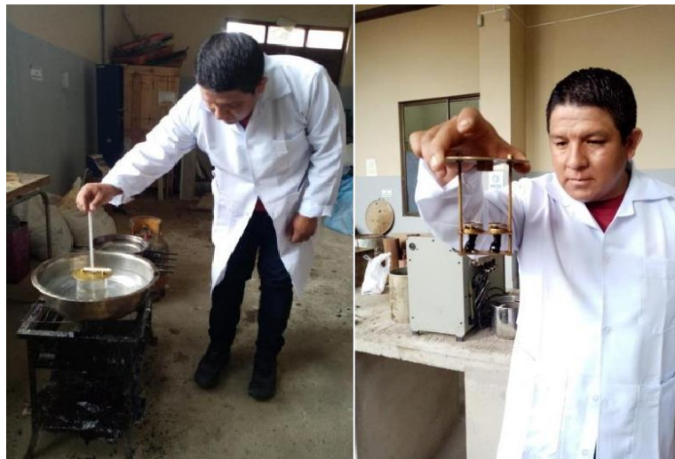
Figura N° 3.22: Ensayo de punto de ablandamiento.
