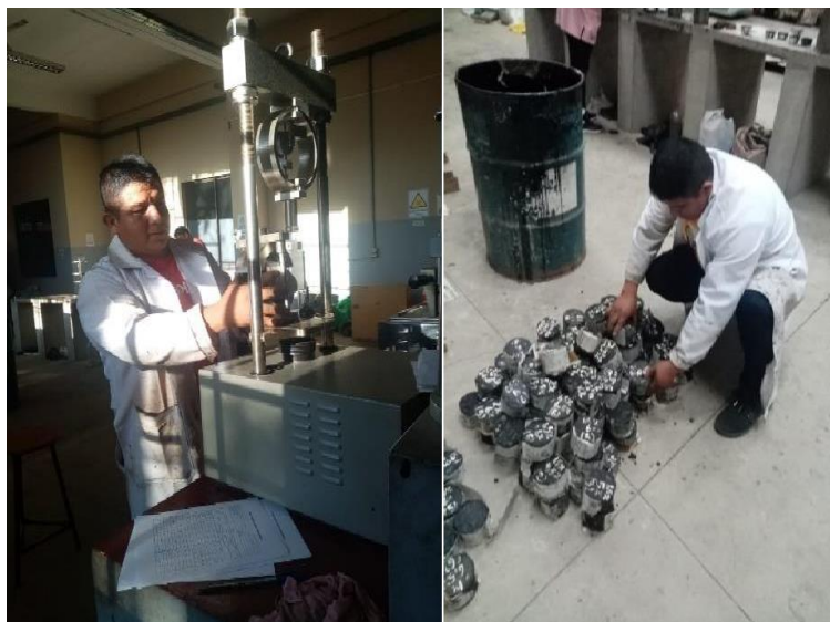
Figura N° 3.33: Lectura de briquetas a una temperatura 60°C.
