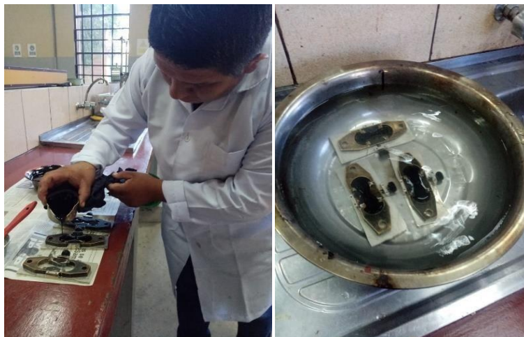
Figura N° 3.23: Ensayo de ductilidad del cemento asfáltico
