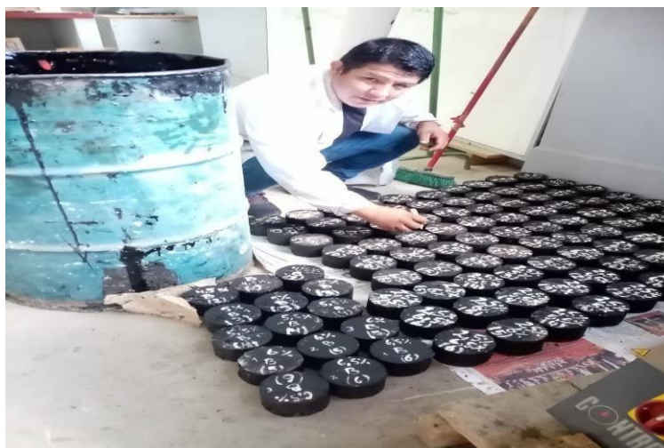
Figura N° 3.31: Marcación de las briquetas para realizar ensayo Marshall.
