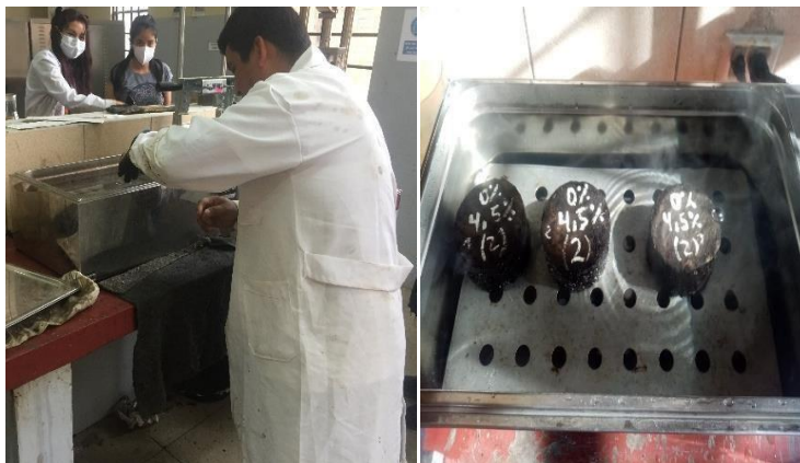
Figura N° 3.32: Inmersión de briquetas a una temperatura 60°C.
