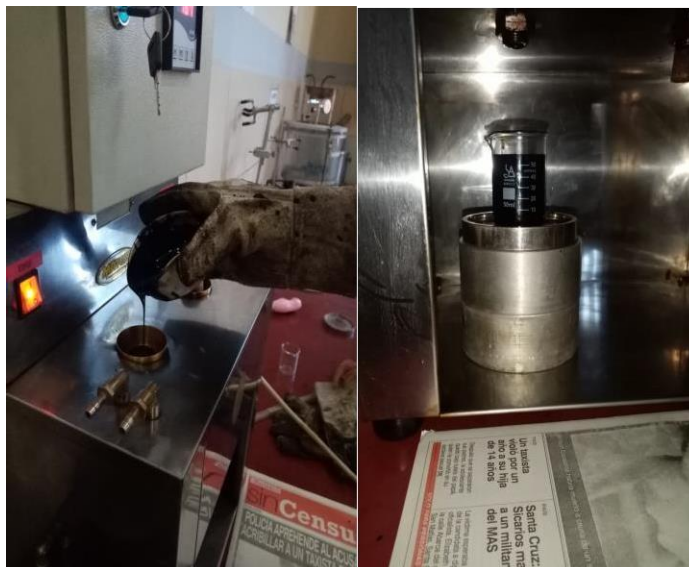
Figura N° 3.25: Realización del ensayo viscosidad saybolt del cemento asfáltico.
