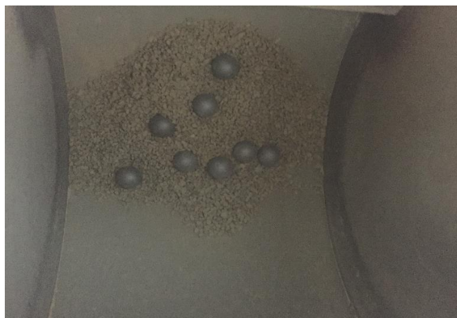
Figura N° 3.16: Agregado grueso – gravilla y las 8 esferas.
