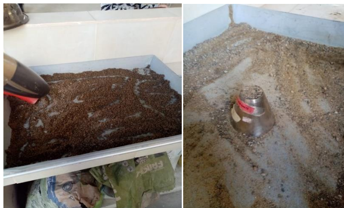
Figura Nª 3.8: Secado superficial del material
