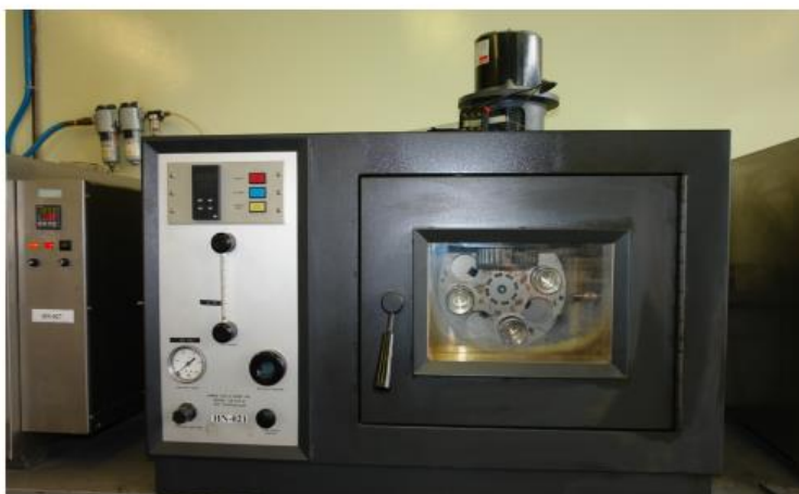
Figura N° 3.20: Horno rotatorio para ensayo película delgada
