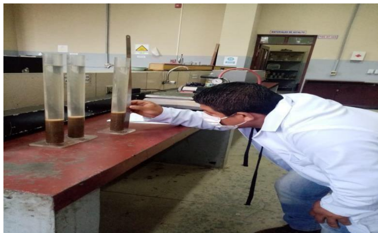
Figura N° 3.11: Lectura de la altura de arena que contiene
