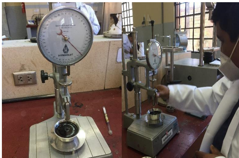
Figura N° 3.17: Realización del ensayo de penetración del cemento asfáltico.
