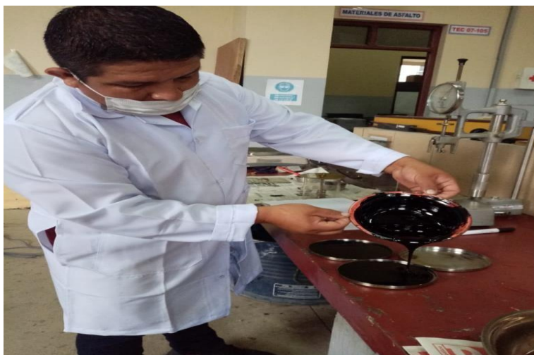
Figura N° 3.19: Realización del ensayo película delgada.
