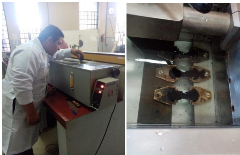
Figura N° 3.24: Colocación de moldes con cemento asfáltico en baño María.
