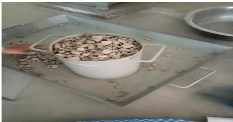
Figura N° 3.12: Peso unitario compactado del agregado 3/4".
