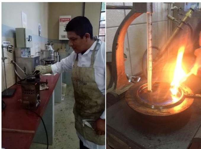
Figura N° 3.18: Realización del ensayo punto de inflamación del cemento asfáltico.
