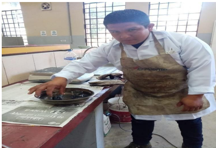
Figura N° 3.21: Realización del ensayo peso específico del cemento asfáltico.
