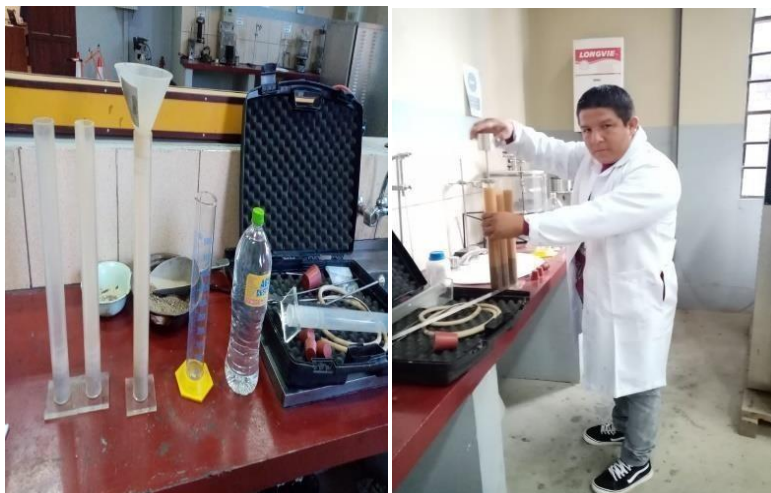
Figura N° 3.10: Equivalente de arena y agitación del cilindro graduado con la muestra.
