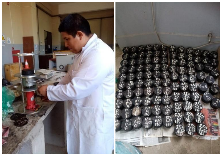
Figura N° 3.28: Extracción de las briquetas con extractor hidráulico.
