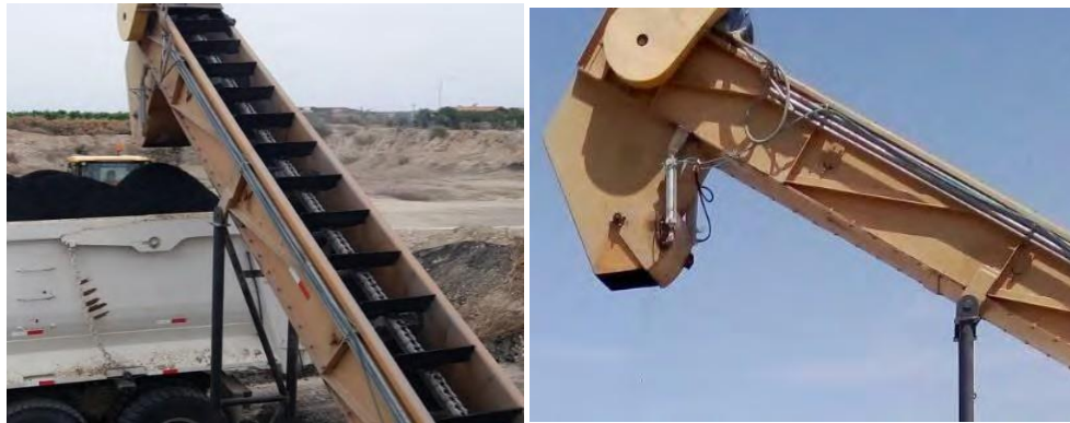
Figura 4.4: Transportador y elevador de la mezcla asfáltica en caliente.
