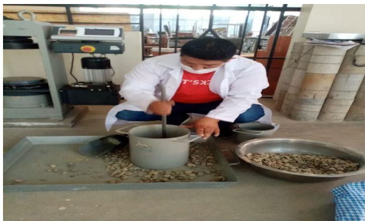
Figura N° 3.13: Compactado del agregado suelto 3/4" apisonado.
