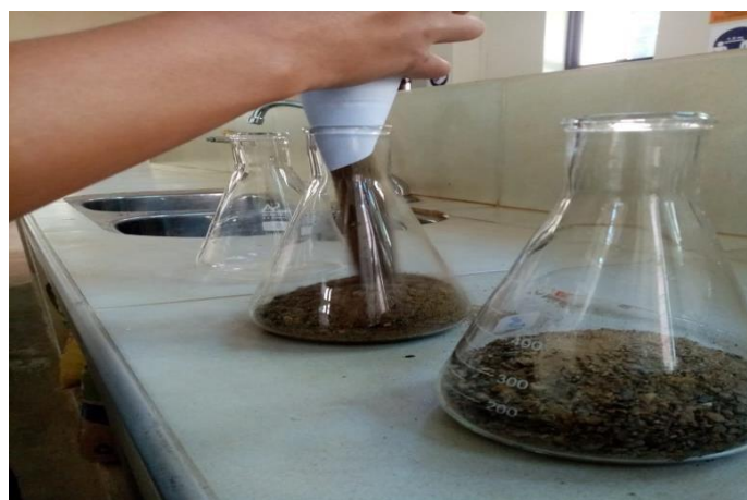
Figura N° 3.9: Preparación del matraz para el pesado de la muestra
