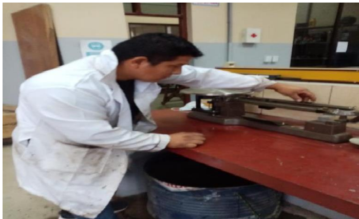
Figura N°3.7: Obtención del peso sumergido en agua
