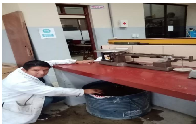
Figura N° 3.30: Briquetas sumergidas y pesadas en balanza con canastillo.
