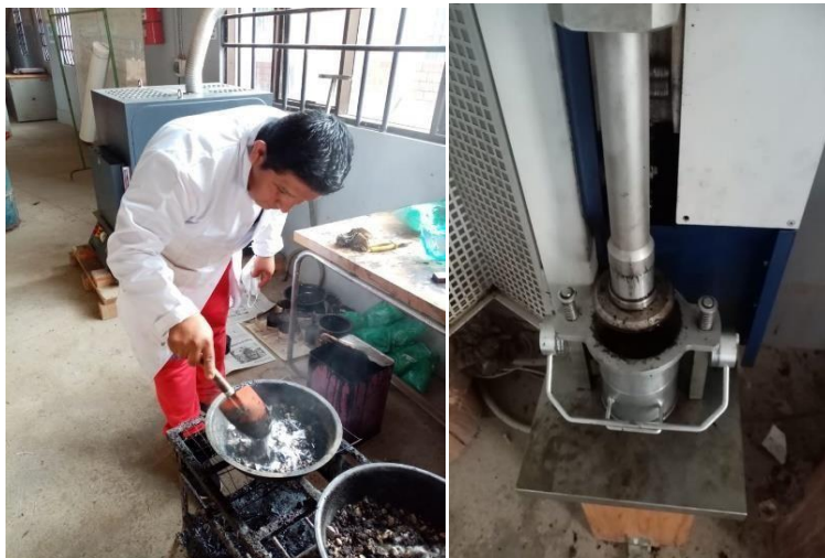
Figura N° 3.27: Elaboración y compactado de las briquetas.
