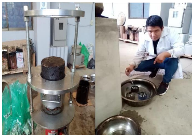
Figura N° 3.29: Proceso de medición y pesaje de briquetas sumergidas
