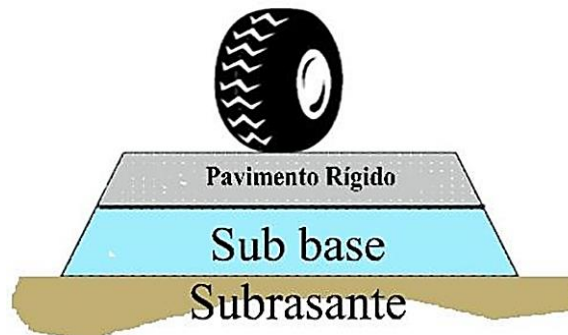
Figura 2.6 Pavimento rígido sobre capa subbase
