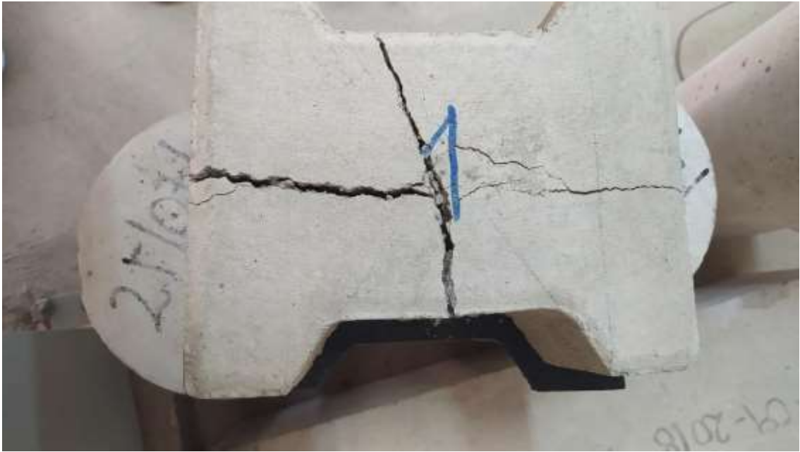
Resultado de la muestra doble t N°1 después de haber realizado en ensayo de resistencia a compresión
