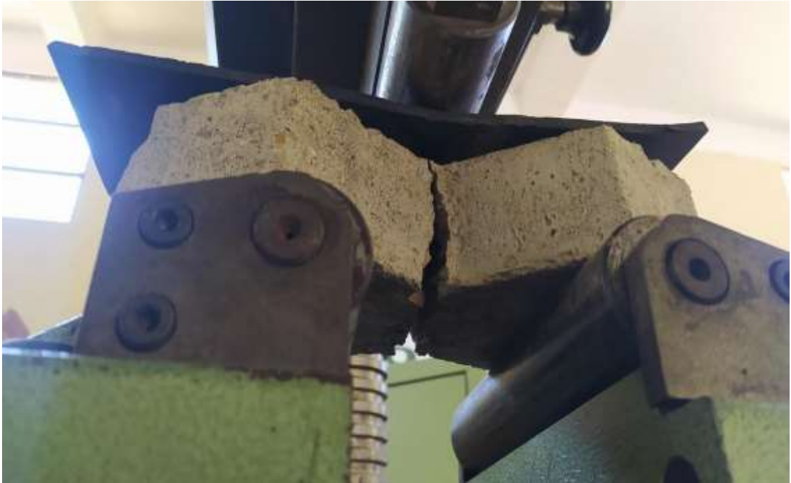
Momento exacto del fallo de la loseta doble hexagonal
