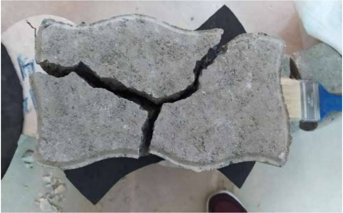
Resultado de la muestra doble s después de haber realizado en ensayo de resistencia a compresión
