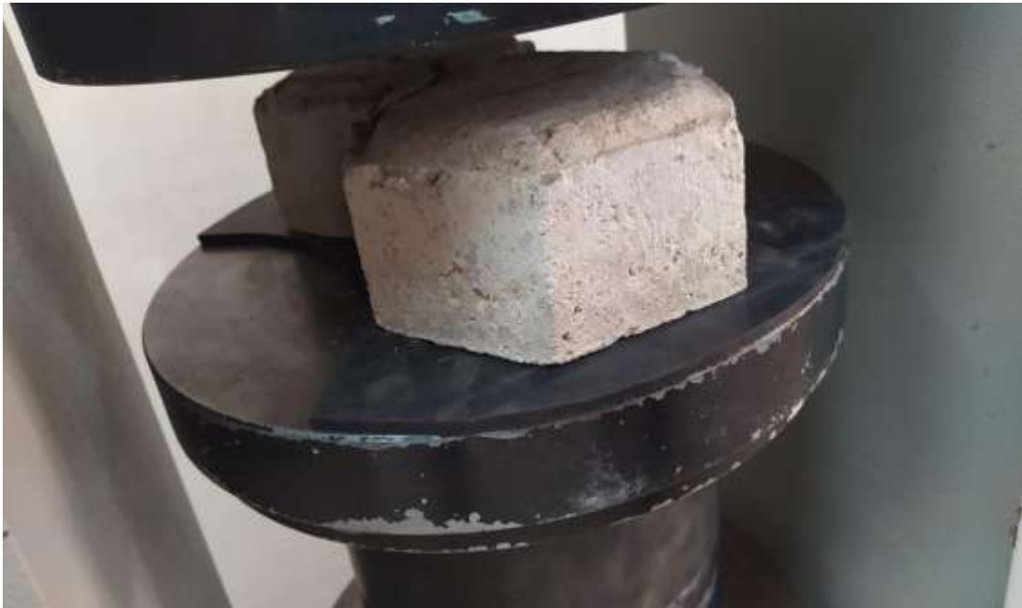
Loseta doble hexagonal después de haber realizado en ensayo a compresión
