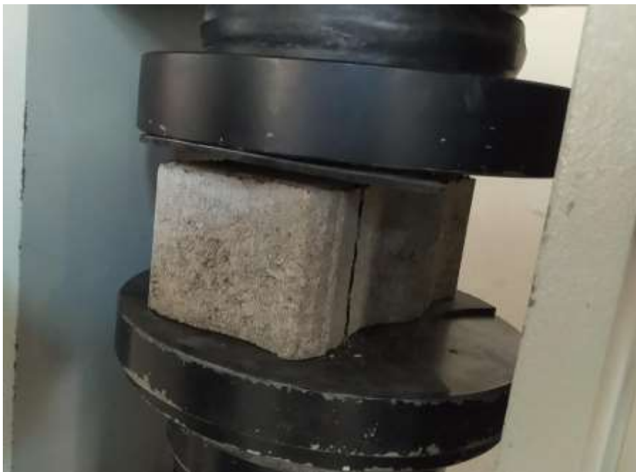
Ensayo de resistencia a compresión de la loseta doble s
