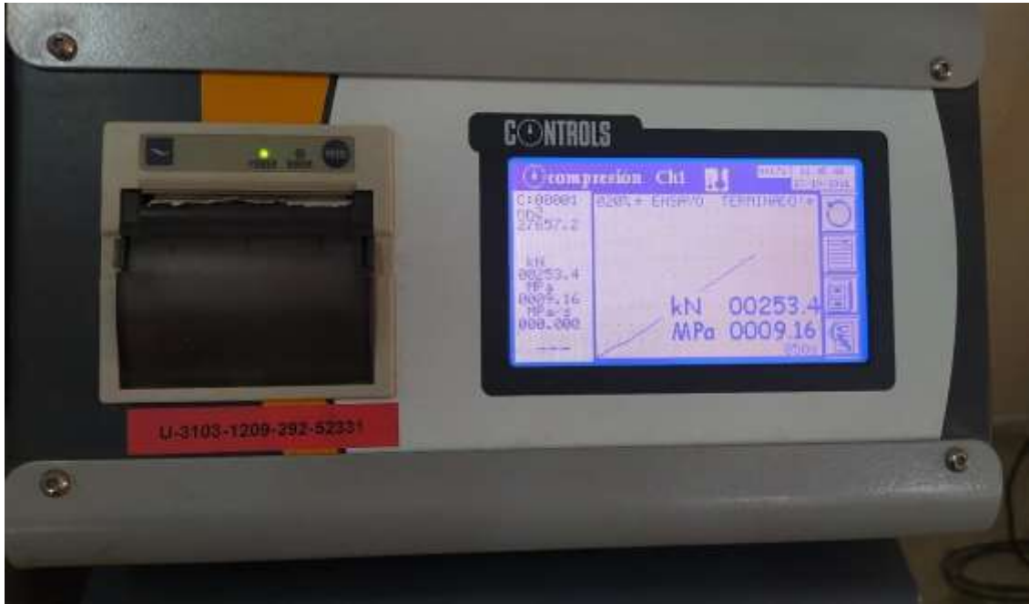
Resultado de la carga aplicada a compresión de una loseta
