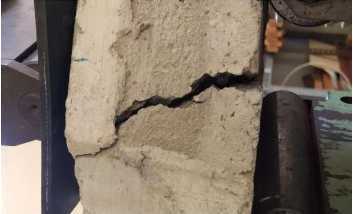
Momento exacto del fallo de la loseta hexagonal
