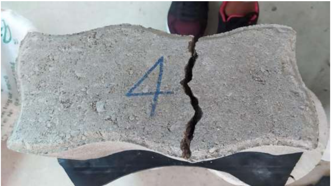
Resultado de la muestra doble s N°4 después de haber realizado en ensayo de resistencia a compresión
