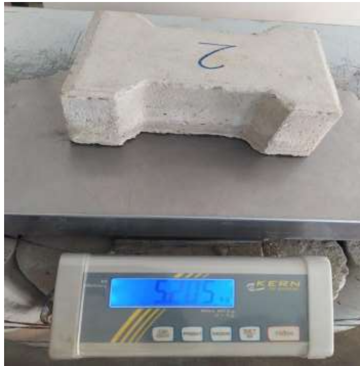
Pesaje de las losetas doble t
