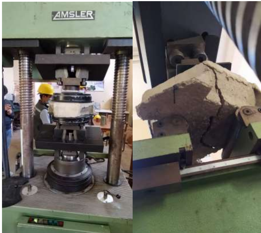
Ensayo de resistencia a compresión de la loseta hexagonal
