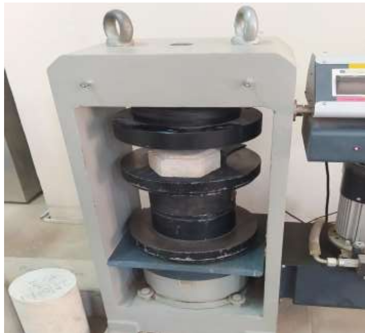
Posicionamiento de la loseta en la prensa a compresión
