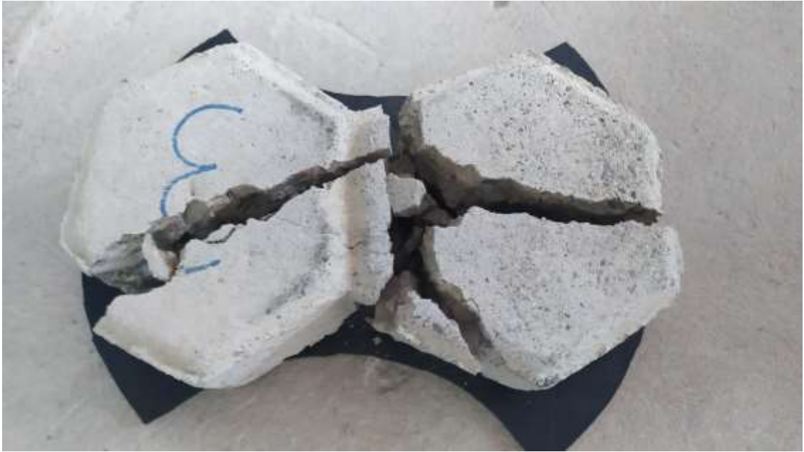
Resultado de la muestra doble hexagonal N°3 después de haber realizado en ensayo de resistencia a compresión
