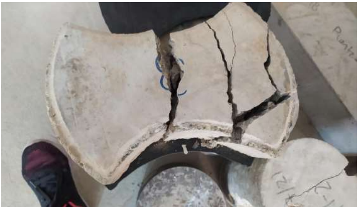
Resultado de la muestra media luna N°1 después de haber realizado en ensayo de resistencia a compresión
