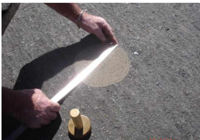
Figura N° 5 Circulo de arena (ASTM E-965)
