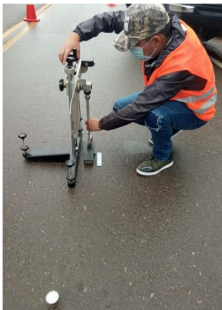
Figura N° 20 Verificación del área de contacto
