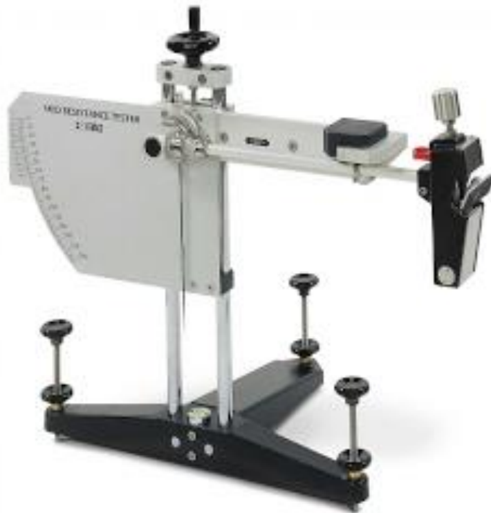
Figura N° 8 Péndulo Británico TRRL
