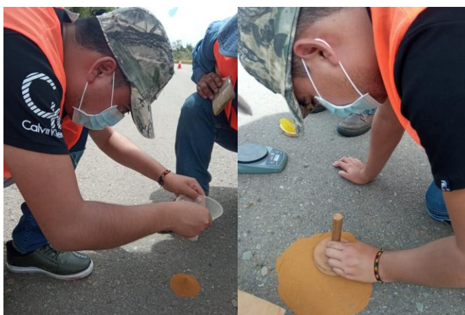
Figura N° 17 Esparcido del material
