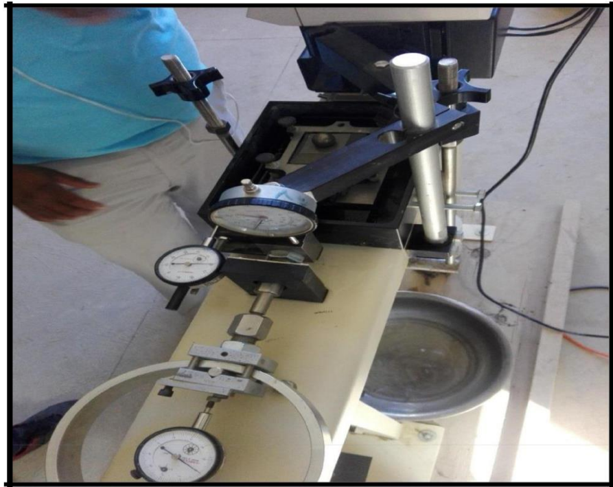
Figura 3.18. Equipo de consolidación y corte directo
