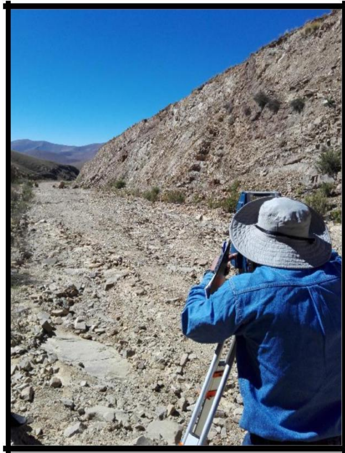
Figura 3.9. Levantamiento topográfico con estación total
