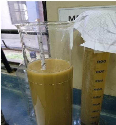
Figura 3.7. Hidrómetro 152 H
