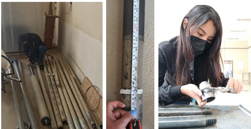
Figura 13. Preparación del equipo SPT
