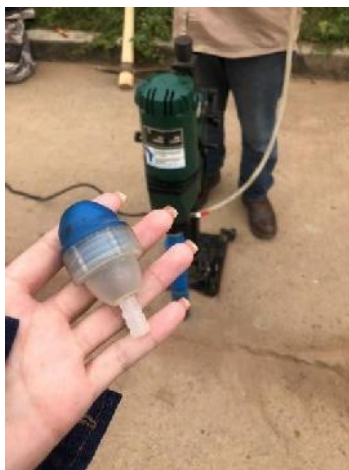
Figura 3.34 Equipo de extracción de testigos (Manguera para el agua).
