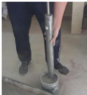
Figura 3.77 Compactación del material.
