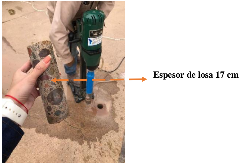
Figura 3.43 Espesor de losa.
