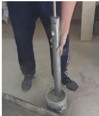
Figura 3.156 Compactación del material.
