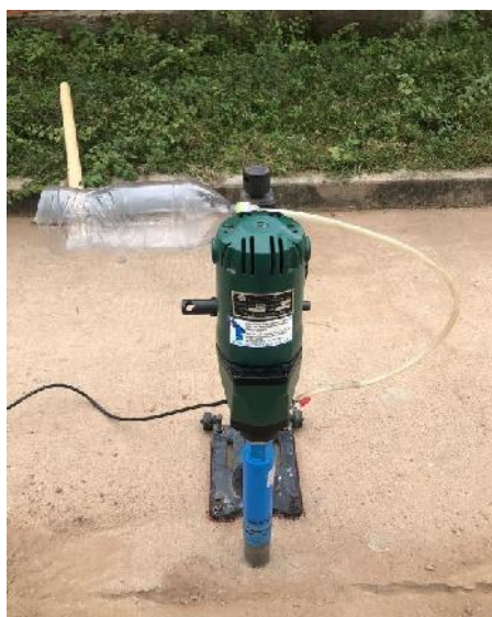
Figura 3.35 Equipo de extracción de testigos (Manguera para el agua).
