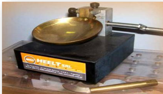
Figura 3.62 Aparato Casagrande con su ranurador.
