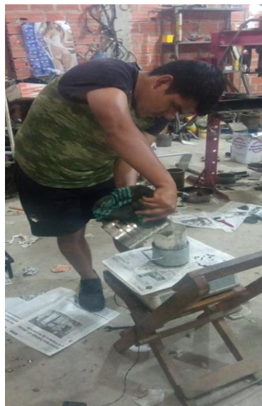
Figura 3.36: Aplicando el cemento asfáltico
