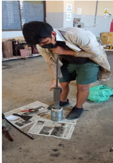
Figura 3.32: Compactando la sobrecapa
