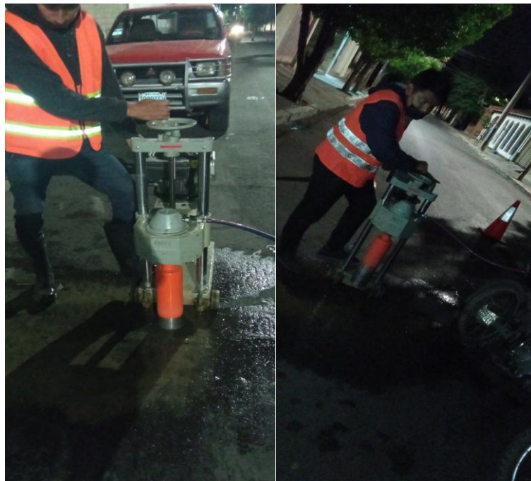
Figura 3.24: Extracción de núcleos en calles urbanas
