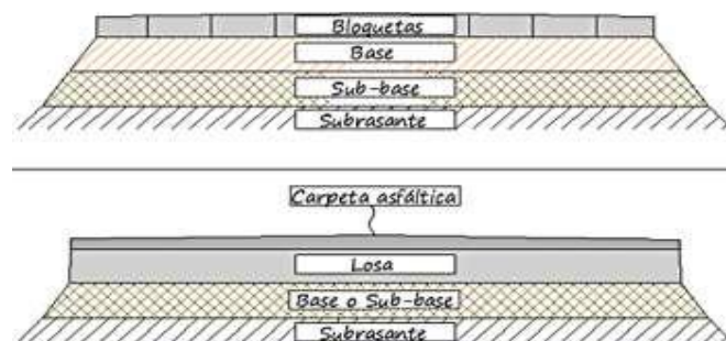
Figura 2.3: Estructura típica del pavimento híbrido
