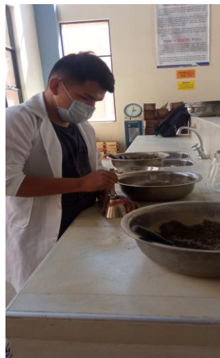
Figura 3.6: Eliminación de vacíos de la muestra
