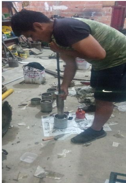
Figura 3.38: Compactando el tratamiento superficial doble
