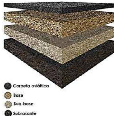
Figura 2.1: Estructura típica del pavimento flexible
