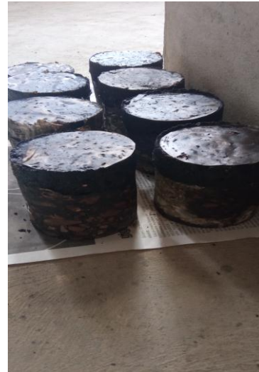
Figura 3.33: Núcleos con sobrecapa
