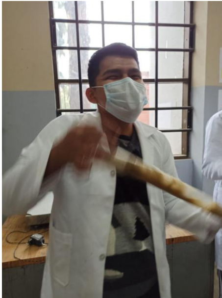
Figura 3.9: Agitando y eliminando vacíos de la muestra
