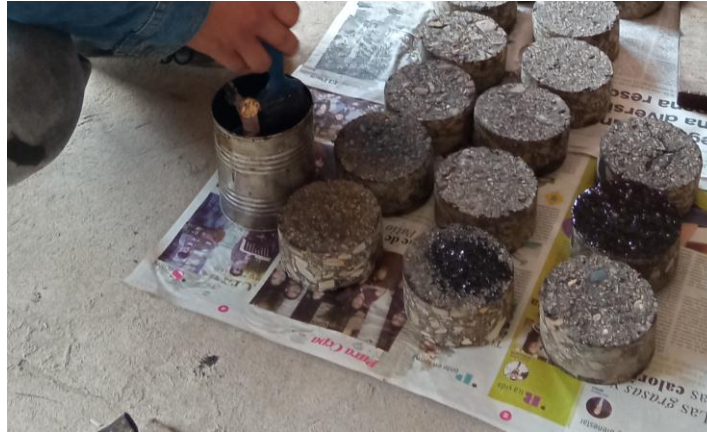
Figura 3.35: Pintando los núcleos con riego de liga
