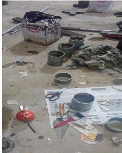
Figura 3.39: Moldes con tratamientos ya compactados
