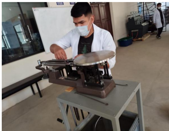
Figura 3.5: Lectura del peso en la balanza con canastillo
