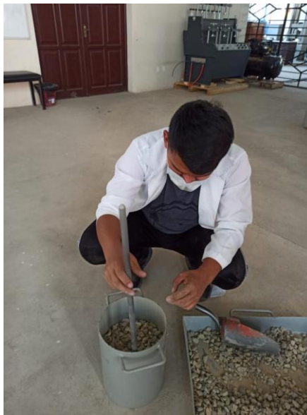
Figura 3.10: Compactando la muestra
