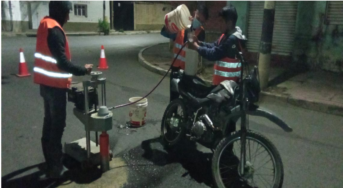
Figura 3.25: Suministrando agua al extractor de núcleos
