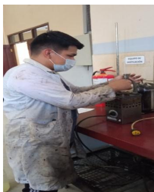
Figura 3.16: Ajustando el termómetro para el punto de inflamación
