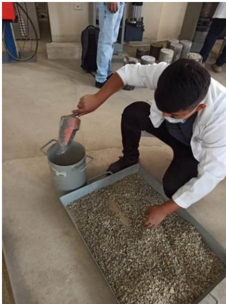
Figura 3.11: Vaciando la muestra en el molde
