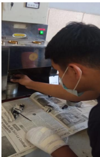
Figura 3.21: Observando la caída del asfalto y controlando el tiempo
