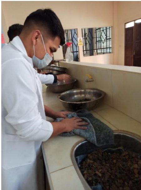
Figura 3.4: Saturación de la grava
