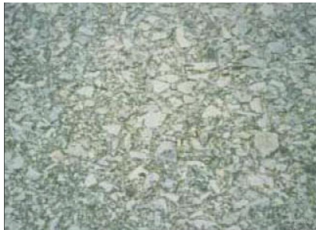
Figura 2.23: Pulimiento de agregado
