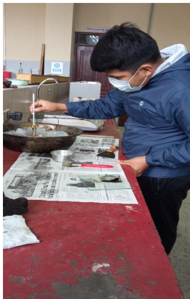
Figura 3.19: Controlando la temperatura para el punto de ablandamiento
