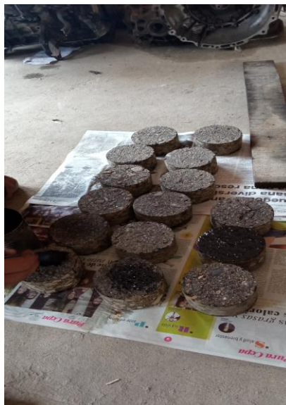
Figura 3.28: Aplicación del riego de liga
