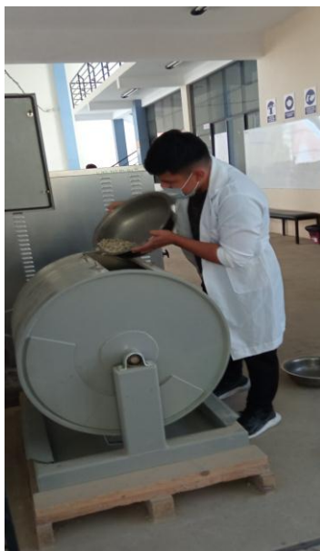
Figura 3.7: Introduciendo la grava a la máquina de desgaste de los ángeles
