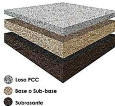
Figura 2.2: Estructura típica del pavimento rígido
