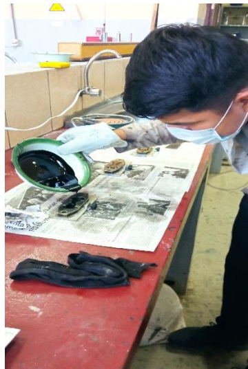
Figura 3.18: Vertiendo el asfalto en los moldes
