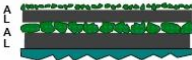
Figura 2.39: Tratamiento superficial doble (A: árido y L: ligante)
