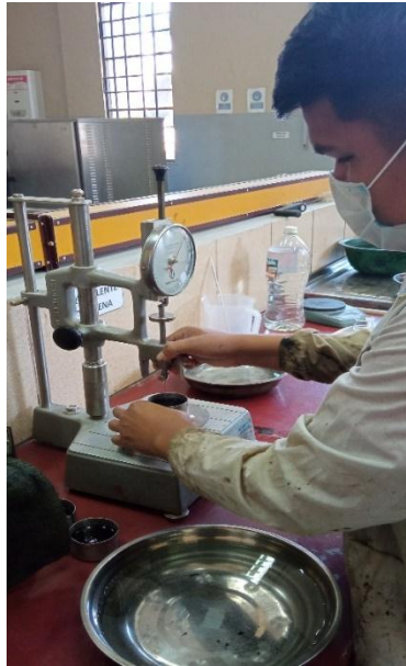
Figura 3.17: Ajuste de la aguja para ensayar la penetración
