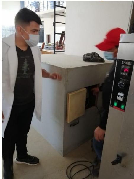
Figura 3.8: Alistando la máquina de desgaste de los ángeles
