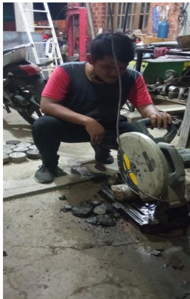
Figura 3.27: Nivelando los núcleos con amoladora
