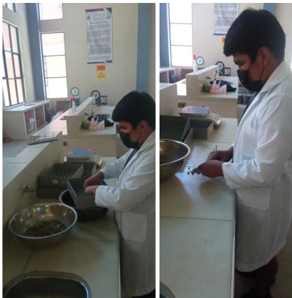
Figura 3.14: Calibrando la muestra en aplanamiento y alargamiento
