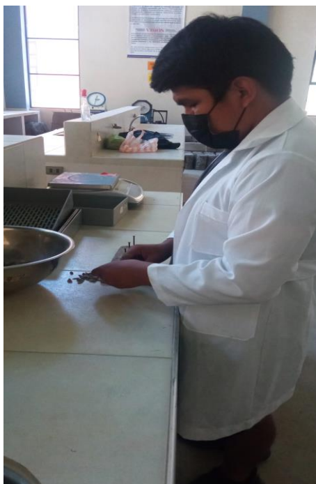
Calibrando el alargamiento de la grava.
