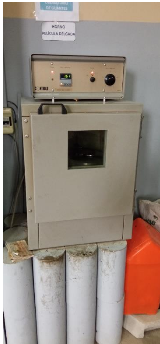
Película delgada, muestras en el horno.
