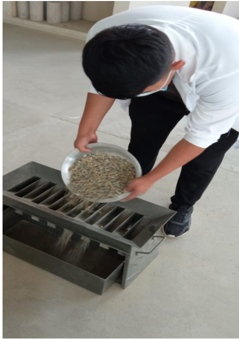
Cuarteo del agregado grueso.
