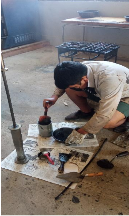
Colocado de la mezcla en la briqueta con el núcleo.
