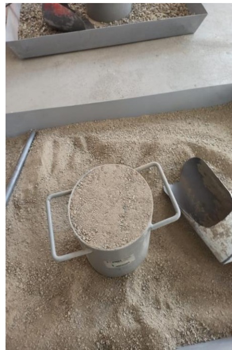
Peso unitario de la arena, muestra ya arrasado.
