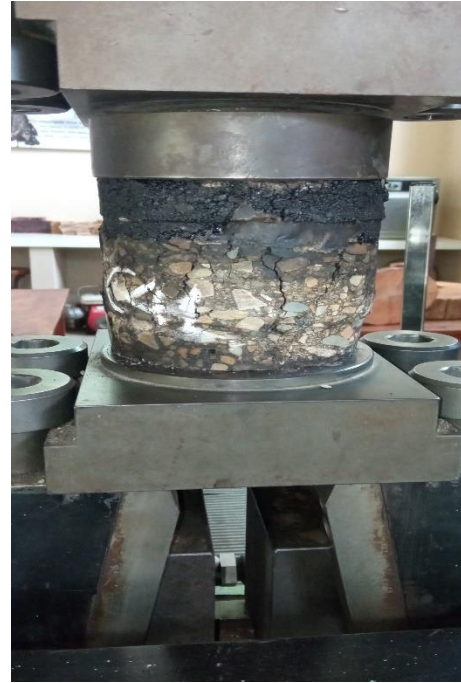
Núcleo con sobre capa sometido a compresión.
