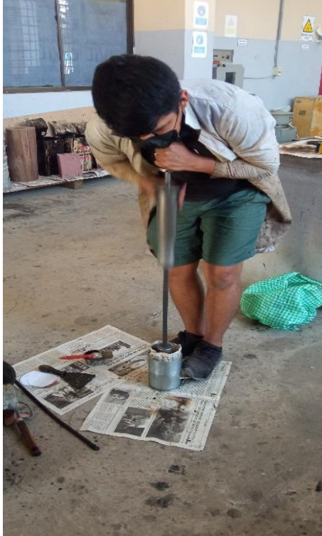
Compactado de la mezcla sobre el núcleo.
