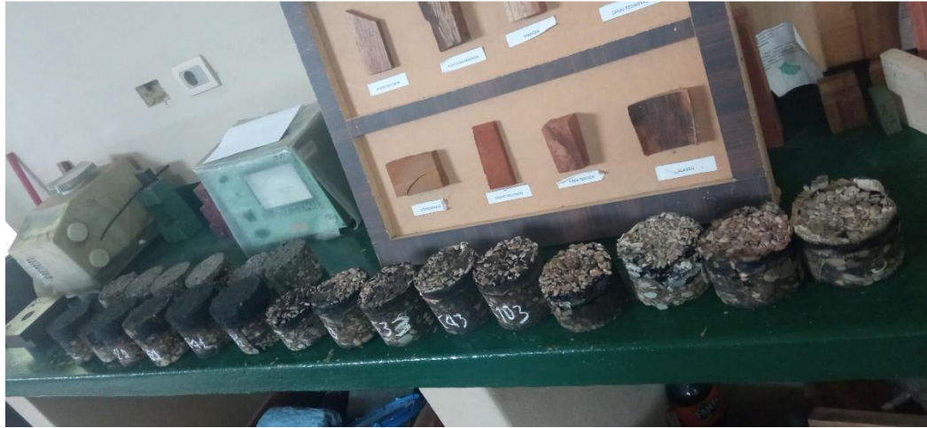
Núcleos con y sin rehabilitación.
