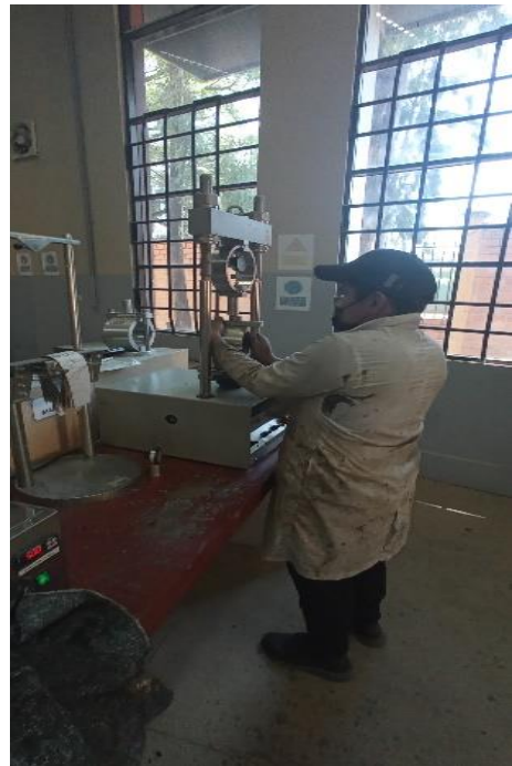
Colocado de la briqueta en el Marshall.
