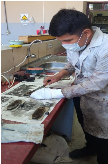
Ductilidad, enrasado de la muestra.
