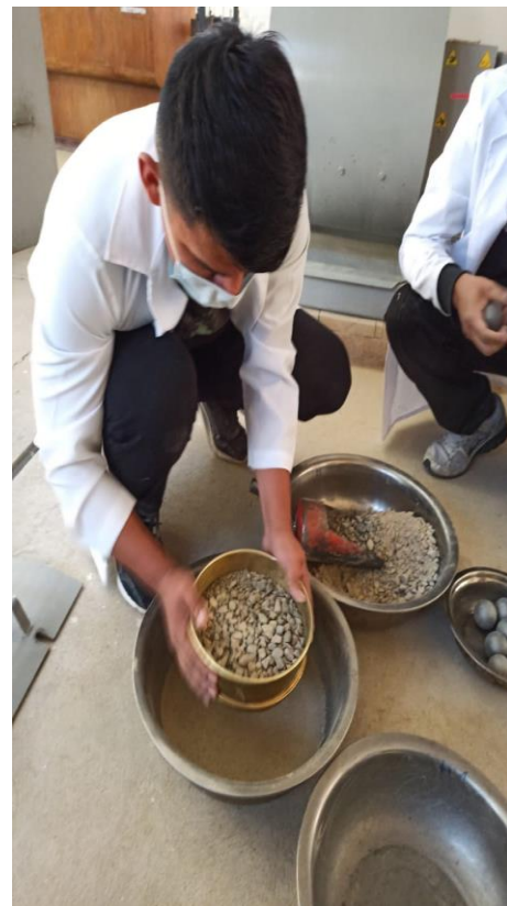
Desgaste de los ángeles, tamizado de la grava.
