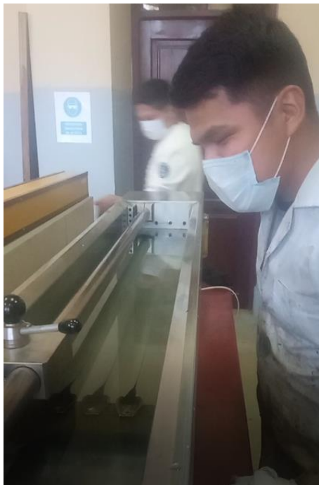
Ductilidad, esperando la ruptura del asfalto.
