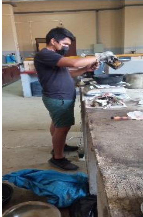
Pesando la cantidad del cemento asfáltico.
