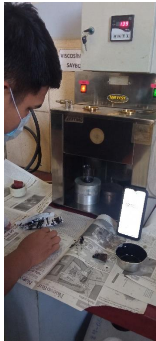
Viscosidad, controlando el tiempo de caída.
