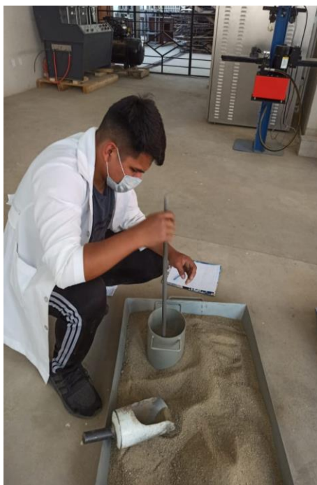
Peso unitario de la arena, golpeando con la varilla.
