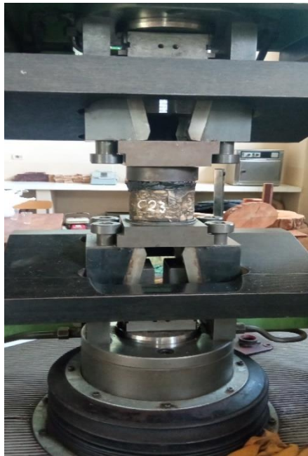
Núcleo con tratamiento superficial doble sometido a compresión.
