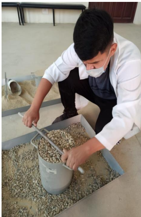
Peso unitario de la grava, arrasado con la varilla.
