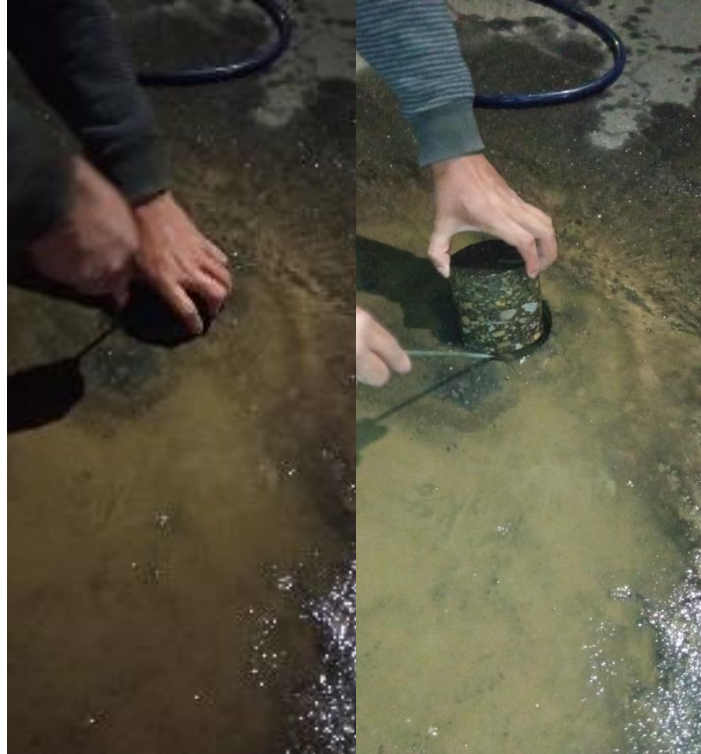
Extracción de la muestra de pavimento.
