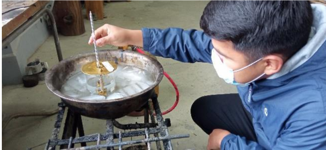
Punto de ablandamiento, controlando la temperatura en el baño maría.
