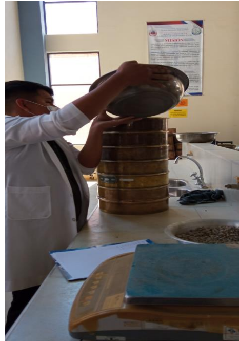
Granulometría del agregado grueso.
