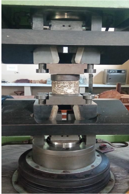
Núcleo sin rehabilitación sometido a compresión.
