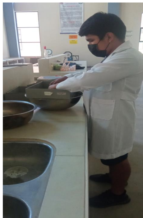
Calibrando el achatamiento de la grava.
