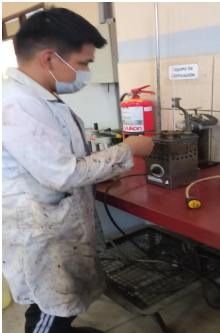
Punto de inflamación, medida de la temperatura.
