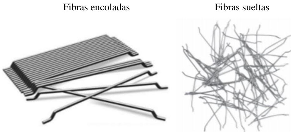
Figura 2.29: Fibras encoladas y sueltas de acero
