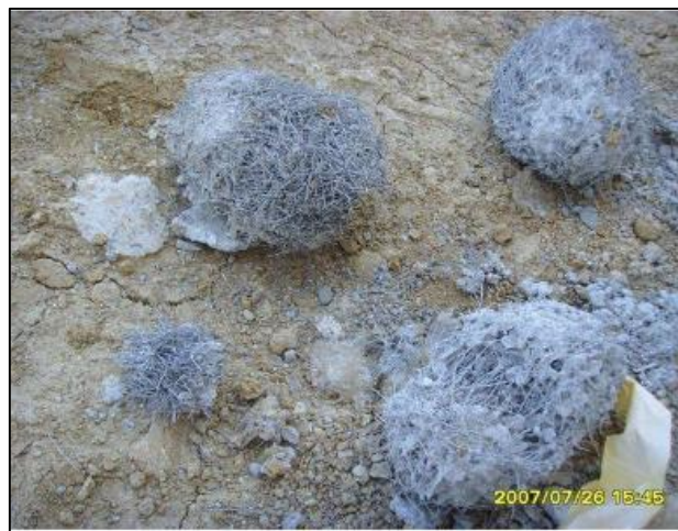
Figura 2.26: Formación de "erizos" o aglomeración de fibras
