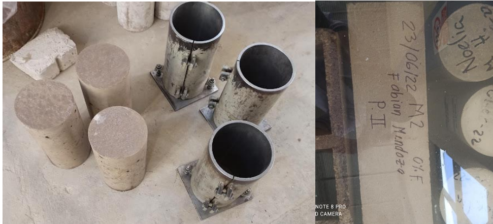
Figura 3.15: Desmolde y curado de probetas
