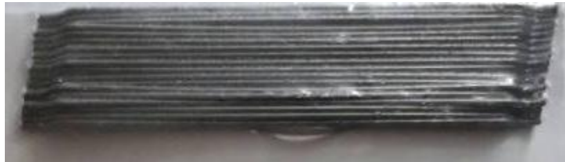
Figura 2.38: Fibras de acero Dramix 3D
