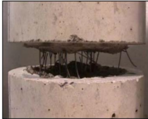
Figura 2.31: Rotura de probeta de concreto reforzado con fibras de acero
