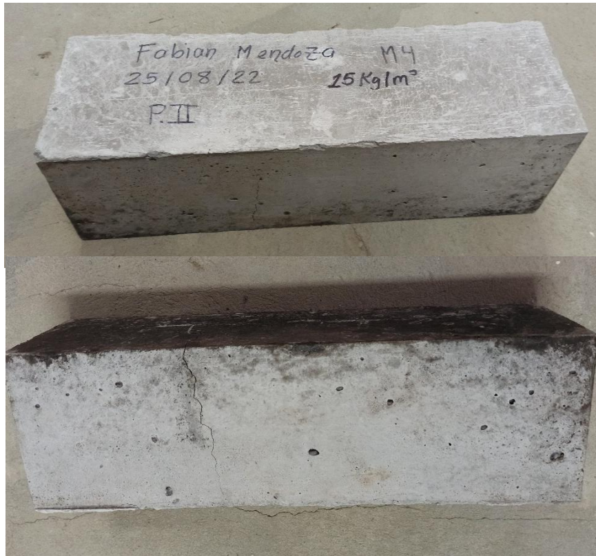
Figura 3.24: Falla de la viga reforzada con fibra
