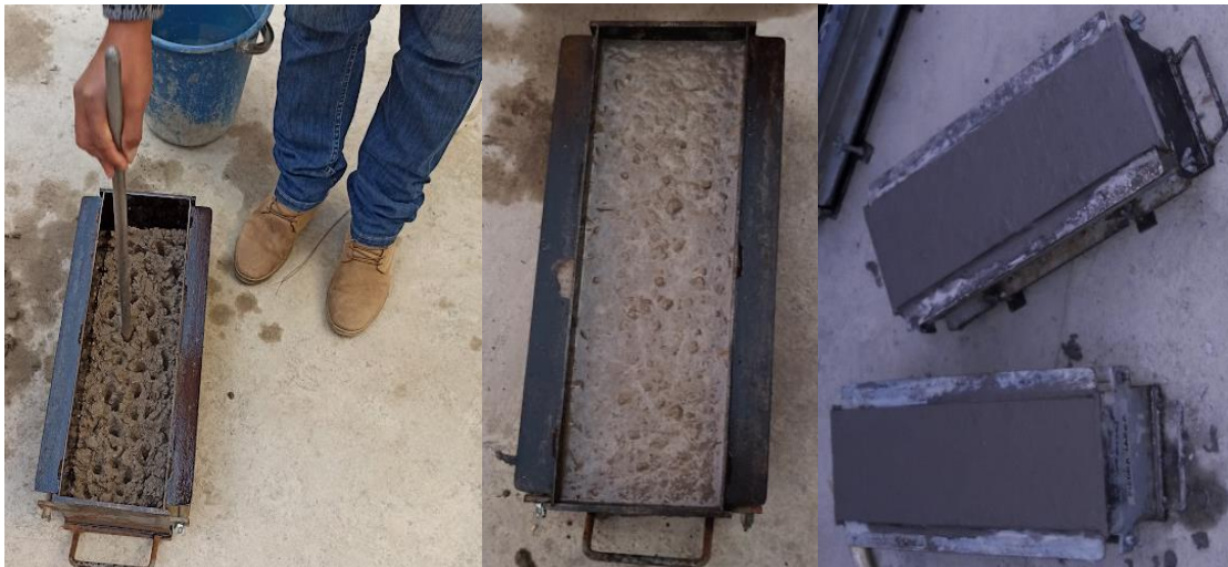
Figura 3.14: Llenado de moldes de probetas rectangulares
