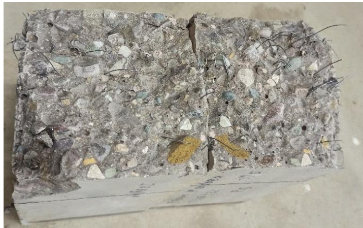
Figura 3.30: Distribución de la fibra de acero
