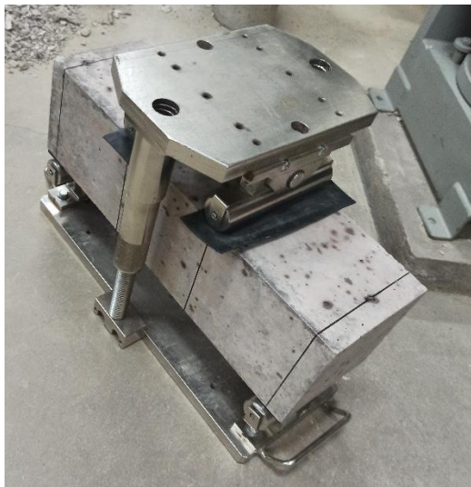
Figura 3.18: Colocado de viga en el soporte de ensayo a flexión
