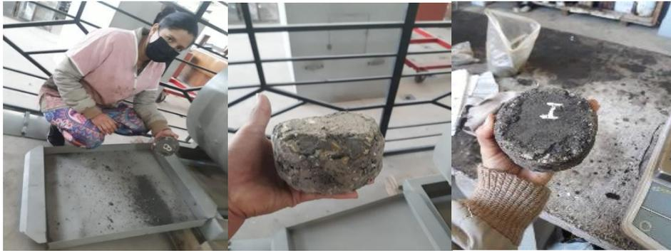
Al momento de sacar las briquetas de la máquina de los Ángeles se pudo observar que las briquetas sometidas a temperaturas frías salían con polvo, y las sometidas a temperaturas calientes, el cemento asfáltico se pegaba en las paredes de la máquina.
