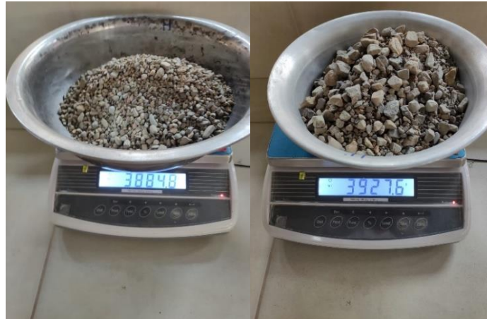
Figura 33. Peso final de los agregados ensayados en la máquina de los ángeles
