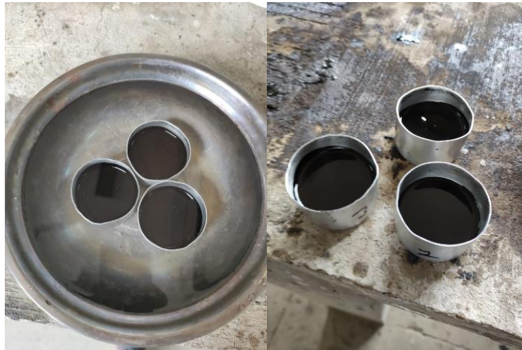
Figura 36. Ensayo de penetración del cemento asfáltico
