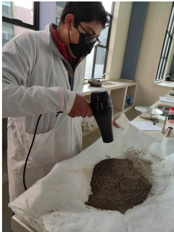
Figura 24. Secado superficial del agregado fino (Arena)
