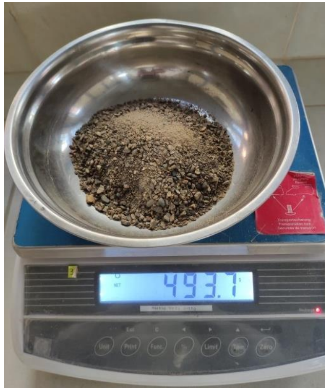
Figura 27. Peso del agregado fino secado en el horno por 24 horas
