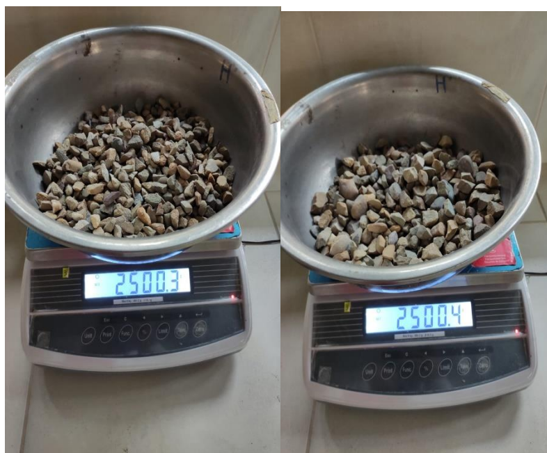
Figura 28. Muestra de agregado grueso (Grava) lavado y tamizado
