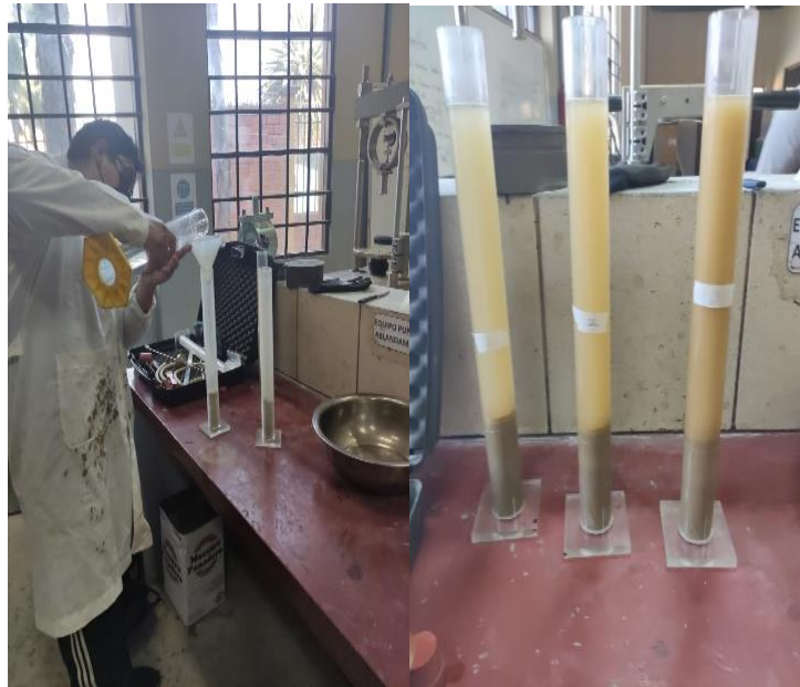
Figura 35. Sedimentación del agregado fino (Arena)
