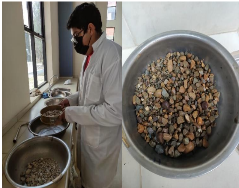
Figura 32. Tamizado y lavado de las muestras de agregado
