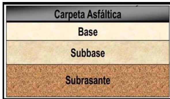
Figura 1. Estructura del pavimento flexible
