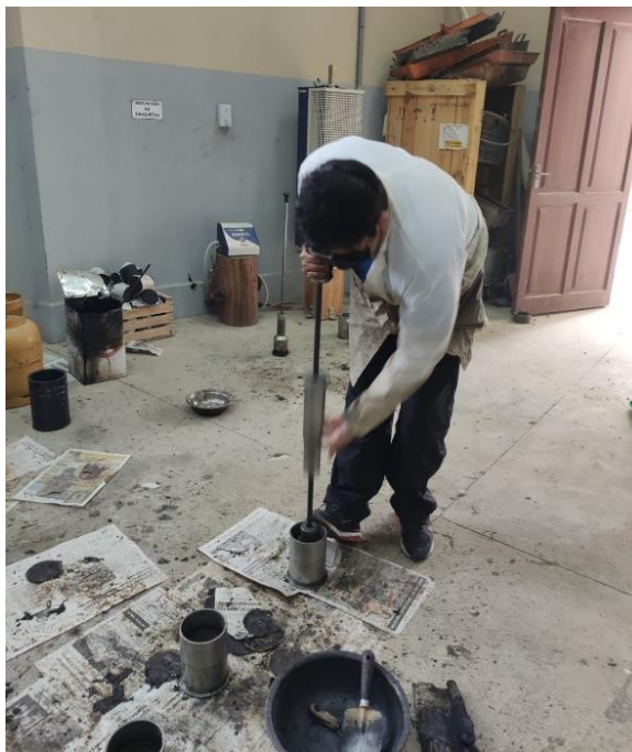
Figura 44. Compactado de las briquetas
