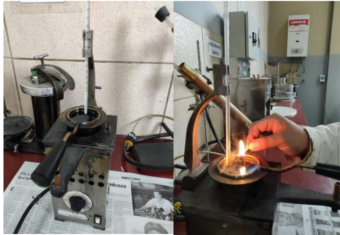
Figura 40. Ensayo de punto de inflamación
