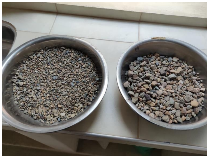
Figura 23. Muestras secas al horno por 24 horas
