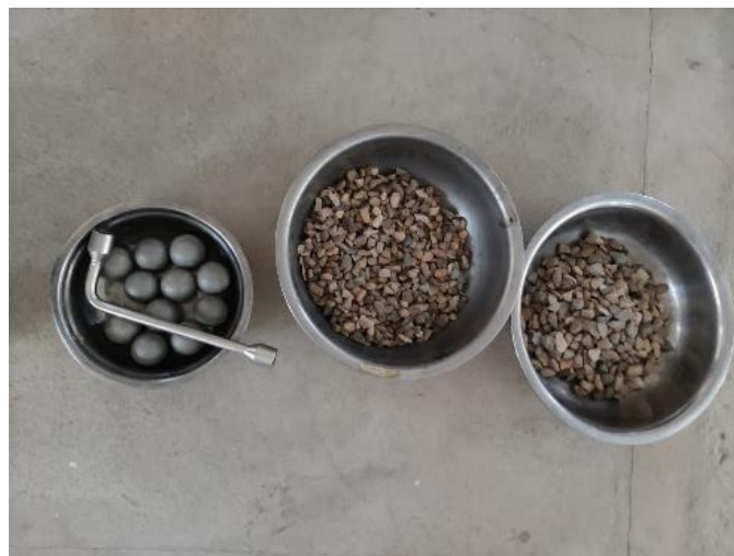
Figura 30. Muestra preparada del agregado grueso e intermedio para realizar el ensayo en la máquina de los ángeles a 500 revoluciones
