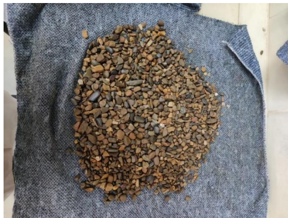
Figura 21. Secado superficial del agregado pétreo saturado
