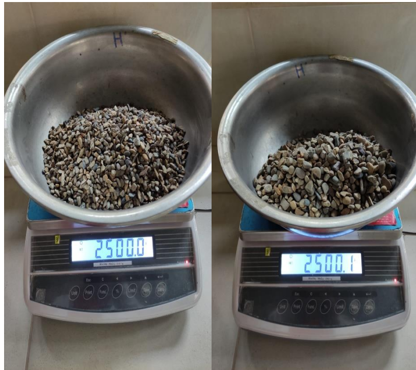
Figura 29. Muestra de agregado intermedio (Gravilla) lavado y tamizado
