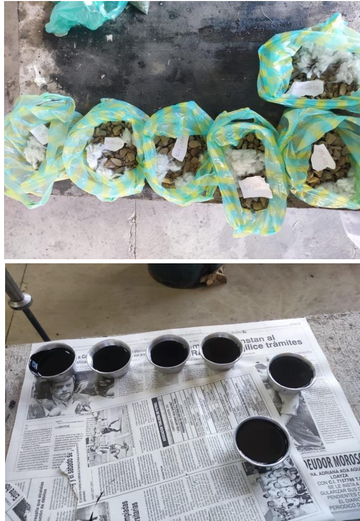
Figura 48. Distribución de los pesos de las muestras de agregados, cementó asfáltico y fibras de poliolefina
