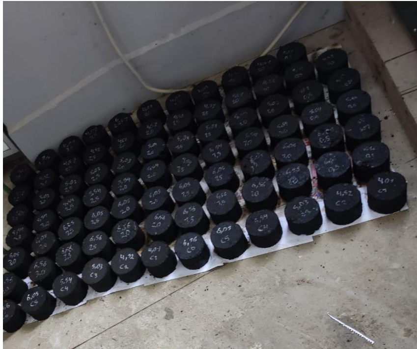
Figura 53. Briquetas elaboradas con 0.50 %, 1.00 %, 1.50 %, 2.00 %, 2.50 % y 3.00 % de fibras de poliolefina
