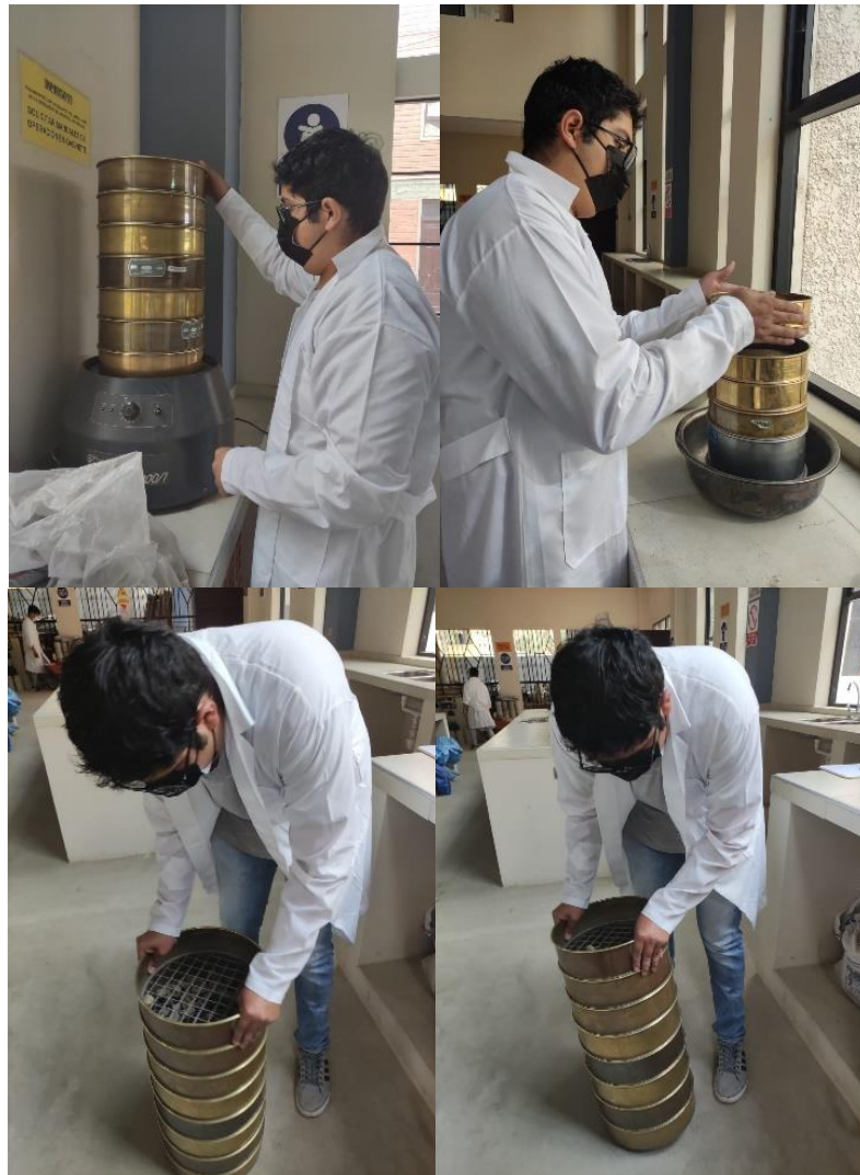
Figura 19. Tamizado de los agregados
