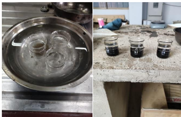
Figura 37. Ensayo de peso específico
