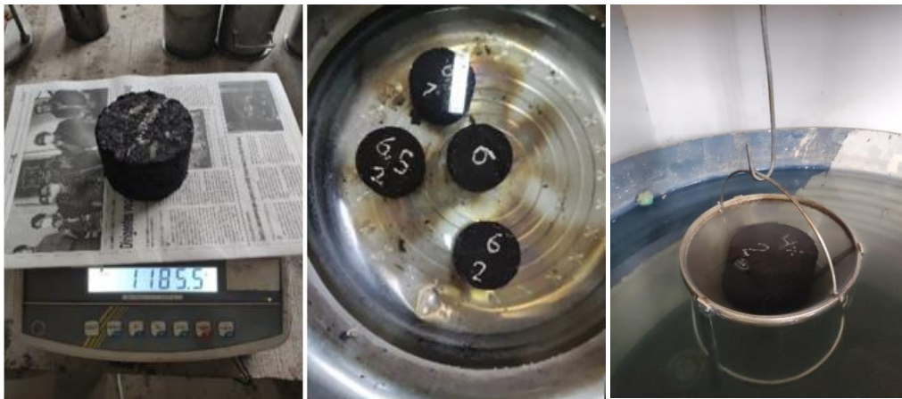
Figura 46. Ensayo para determinar la densidad de la mezcla
