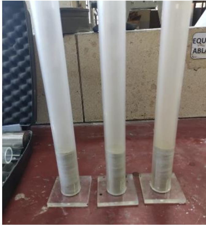
Figura 34. Probetas con agregado fino (Arena)
