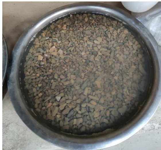
Figura 20. Agregado pétreo en reposo por 24 horas
