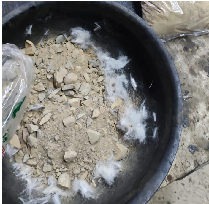
Figura 49. Mezclado de los agregados con las fibras de poliolefina
