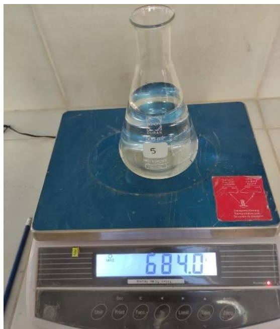
Figura 25. Calibración del matraz
