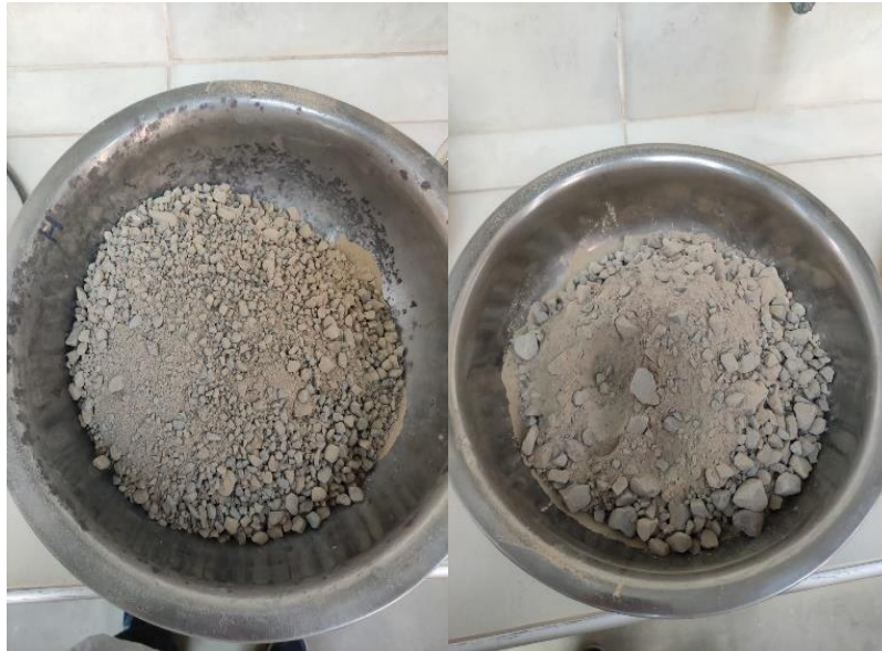
Figura 31. Muestras del agregado grueso e intermedio ensayado en la máquina de desgaste de los ángeles
