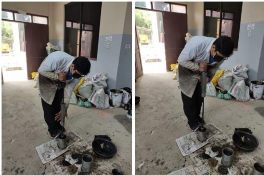
Figura 52. Compactación de las briquetas con la mezcla asfáltica modificada
