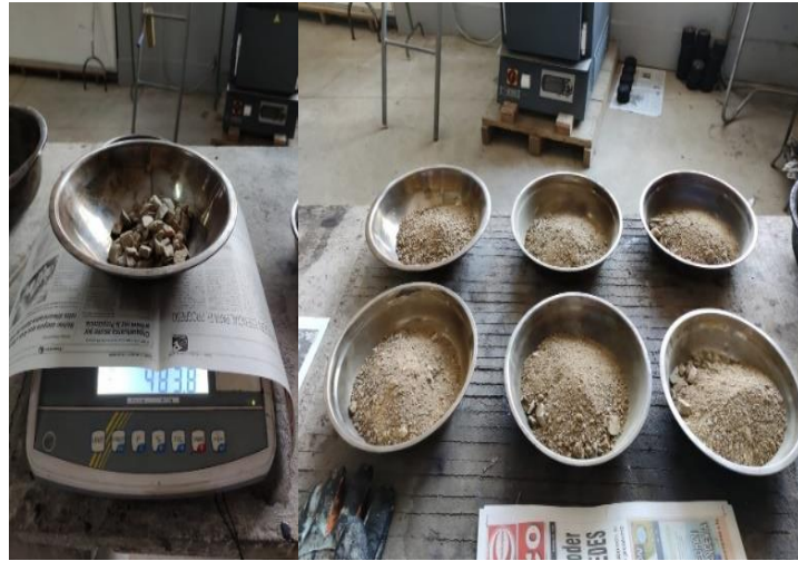
Figura 42. Preparación del peso de las briquetas
