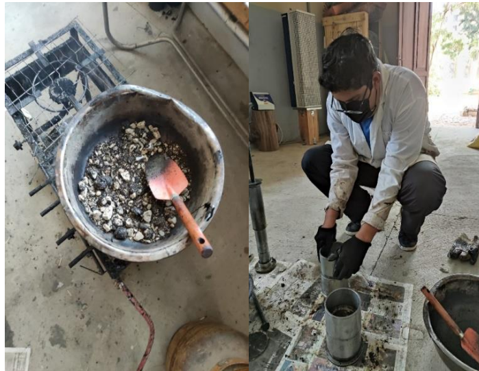
Figura 43. Mezclado y vaciado de la mezcla asfáltica en los moldes
