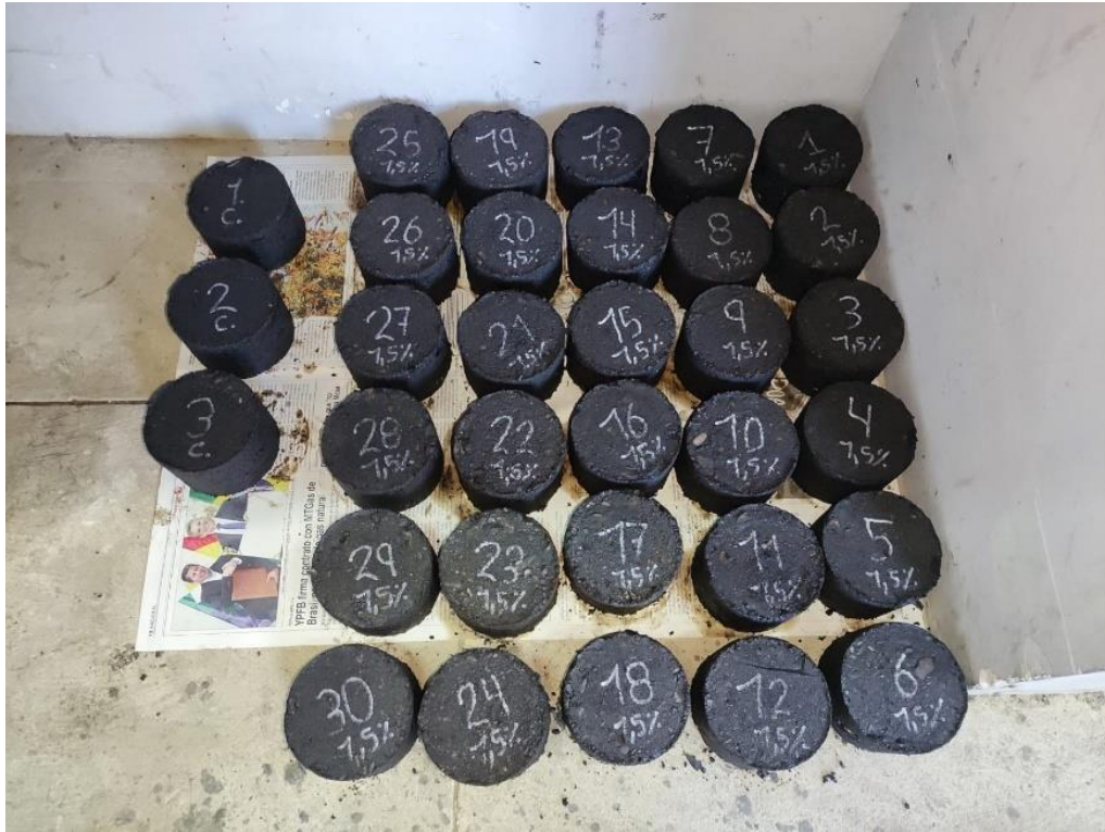
Figura 54. Briquetas elaboradas con el porcentaje óptimo de 2.50 % de fibras de poliolefina y el porcentaje óptimo de 5.74 % de cemento asfáltico
