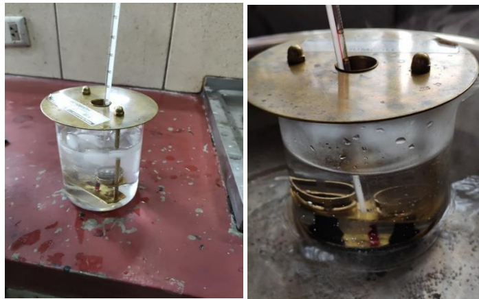
Figura 41. Ensayo de punto de ablandamiento
