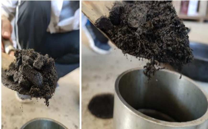
Figura 51. Mezcla asfáltica modificada con las fibras de poliolefina
