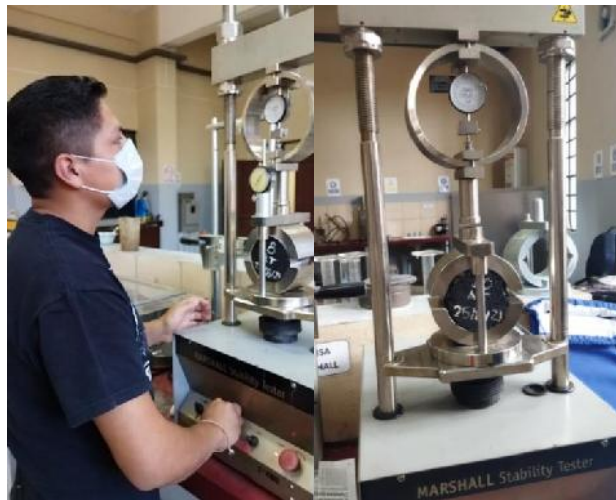
Figura 3. 12 Rotura de briquetas ensayo de estabilidad y fluencia.
