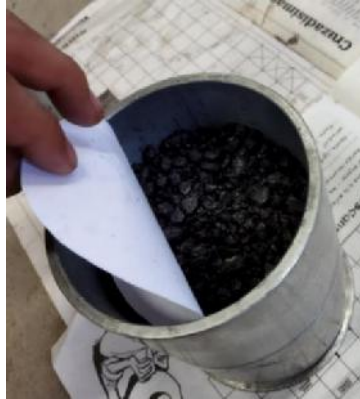
Figura 3. 15 Llenado y colocado del papel filtro en el molde.
