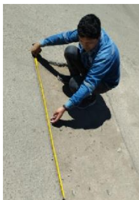
Figura 3. 128 Medición del largo del bache.
