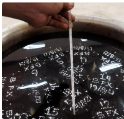
Figura 3. 20 Baño María de briquetas Bacheflex a 25^{\circ}\text{C} .
