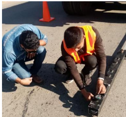
Figura 2. 12 Manipuleo de la viga para una nueva lectura.
