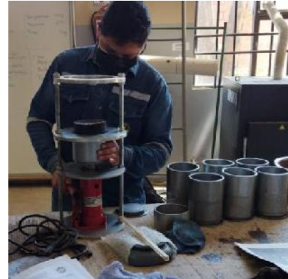
Figura 3. 6 Extracción de briquetas.
