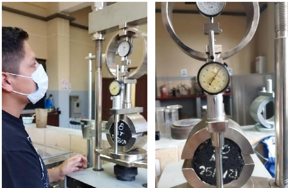
Figura 3. 21 Rotura de Briquetas, ensayo de estabilidad y Fluencia.
