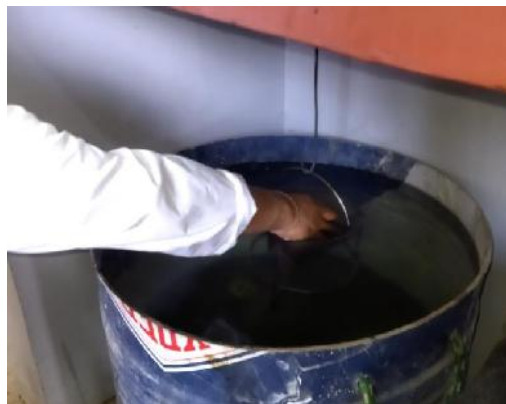
Figura 3. 10 Obtención del peso sumergido.
