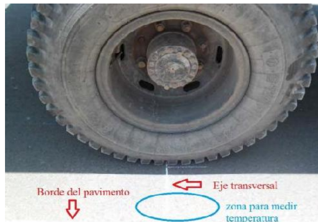
Figura 2. 14 Posición para la medición de temperatura.
