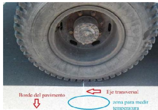
Figura 4. 74 Posición para la medición de temperatura.
