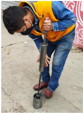
Figura 3. 5 Compactado de Briquetas.
