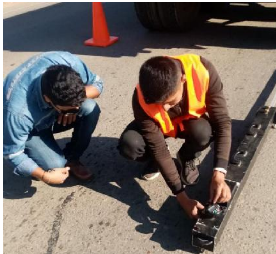
Figura 4. 72 Manipuleo de la viga para una nueva lectura.
