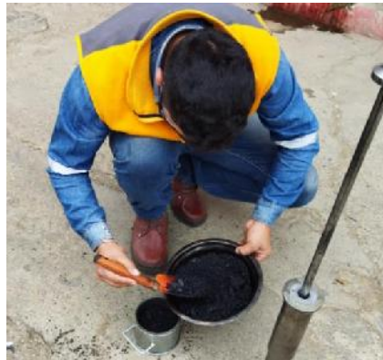
Figura 3. 4 Llenado de mezcla asfáltica al molde.
