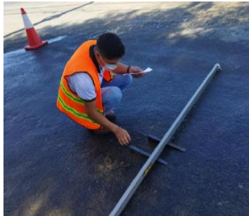
Figura 4. 6 Procedimiento y lectura de los asentamientos en todos los puntos de aplicación.
