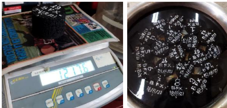
Figura 3. 19 Determinación del peso seco y sumergido.
