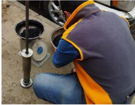
Figura 3. 3 Pesado de la mezcla asfáltica.
