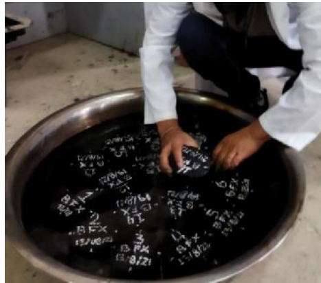
Figura 3. 9 Sumergido de briquetas y obtención del peso saturado.
