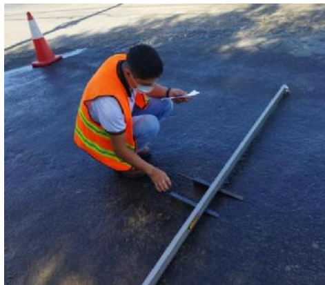
Figura 2. 20 Procedimiento y lectura de los asentamientos en todos los puntos de aplicación.
