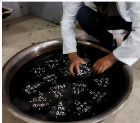
Figura A. 8 Sumergido de briquetas y obtención del peso saturado.
