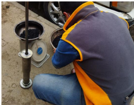
Figura A. 2 Pesado de la mezcla asfáltica.
