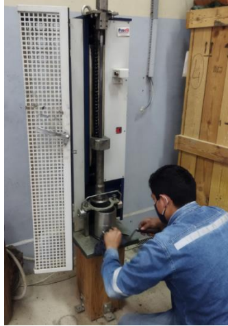
Figura A. 4 Compactación automática.
