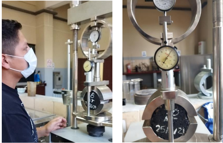
Figura A. 9 Rotura de briquetas, ensayo de estabilidad y fluencia.
