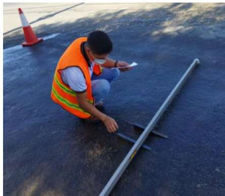
Figura A. 6 Procedimiento y lectura de los asentamientos en todos los puntos de aplicación.
