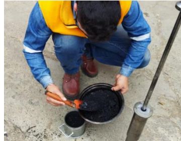
Figura A. 3 Llenado de mezcla asfáltica al molde.
