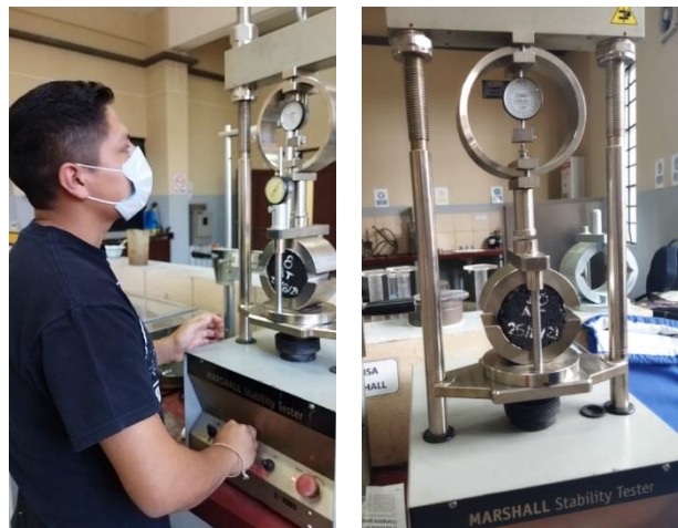
Figura A. 11 Rotura de briquetas ensayo de estabilidad y fluencia.
