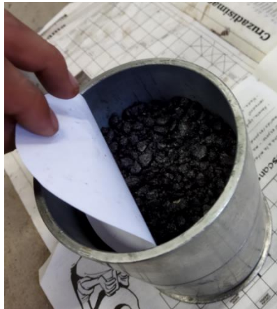
Figura A. 3 Llenado del molde con mezcla Bacheflex.
