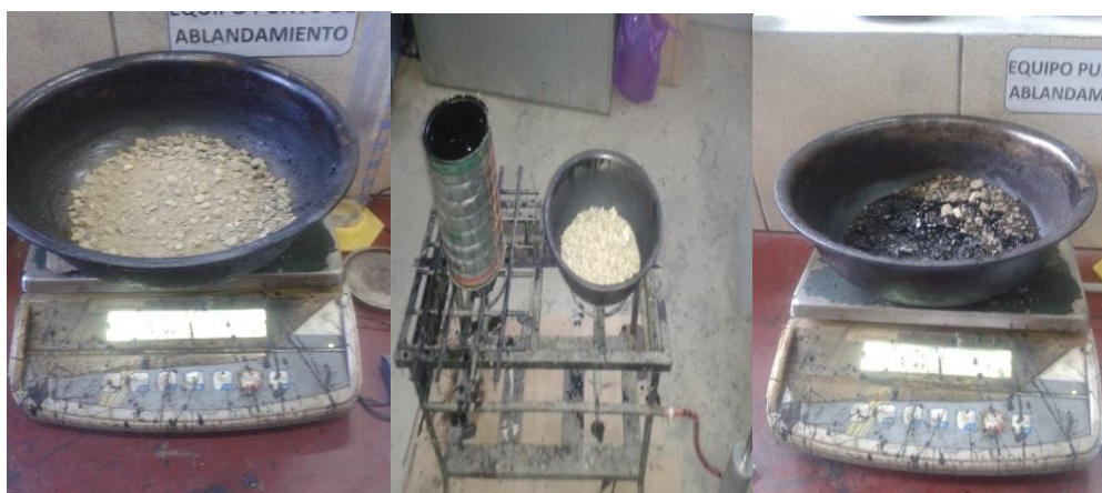
Figura 3.19: Pesado de materiales para la mezcla asfáltica
