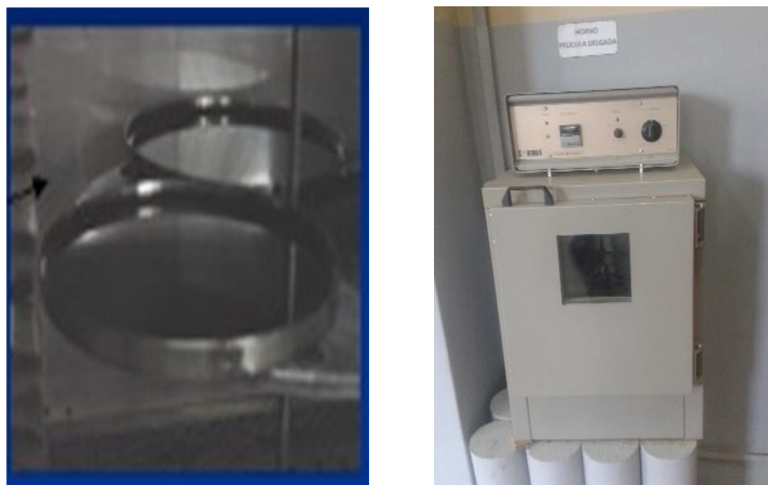
Figura 3.15: Ensayo de película delgada en horno del cemento asfáltico
