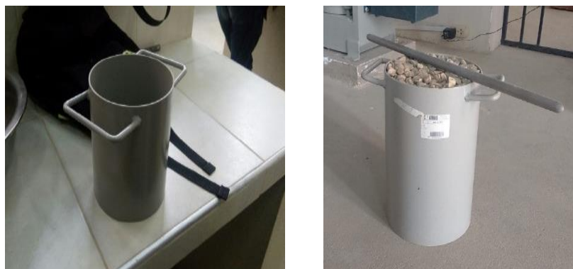
Figura 3.10: Ensayo de peso unitario.
