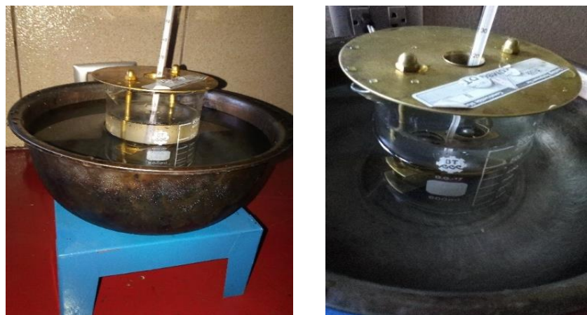
Figura 3.16: Ensayo punto de ablandamiento del cemento asfáltico
