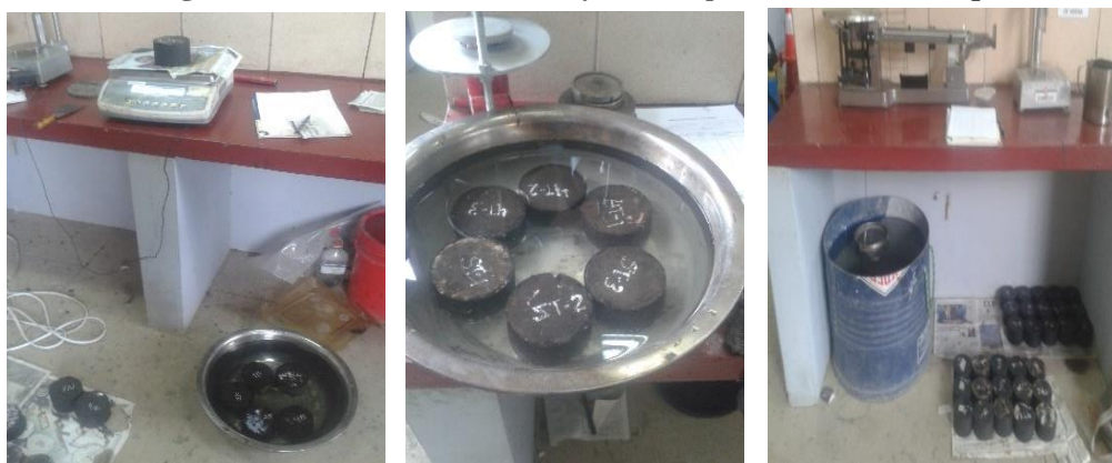
Figura 3.23: Proceso de los diferentes pesados de las briquetas
