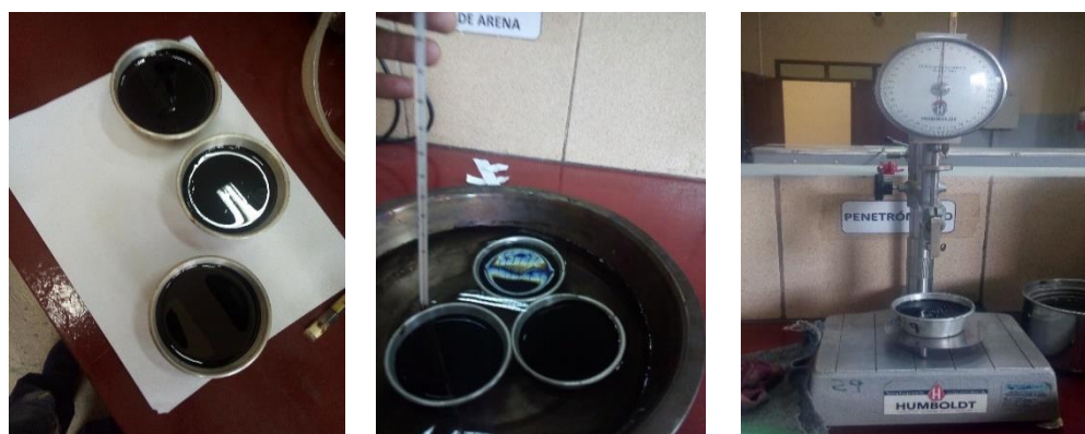
Figura 3.12: Ensayo de penetración del cemento asfáltico
