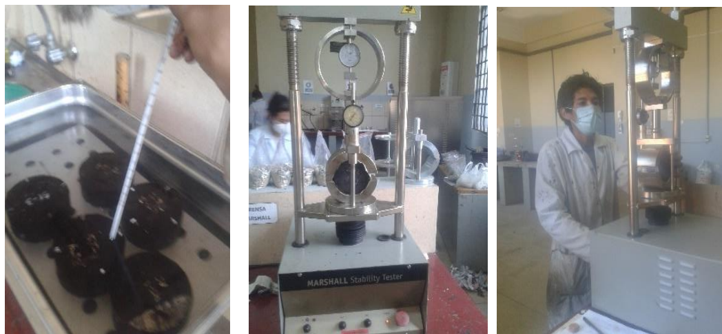
Figura 3.24: Proceso de rotura de la briqueta
