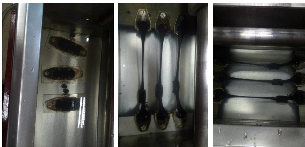
Figura 3.11: Ensayo de ductilidad del cemento asfáltico
