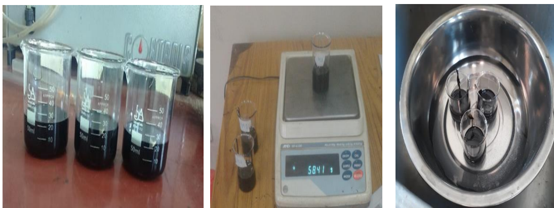
Figura 3.13: Ensayo de peso específico del cemento asfáltico
