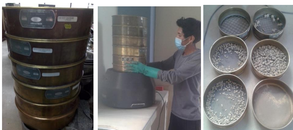
Figura 3.5: Proceso de tamizado del agregado pétreo grueso y fino
