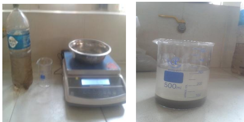
Figura 3.17: Ensayo de peso específico del cemento.
