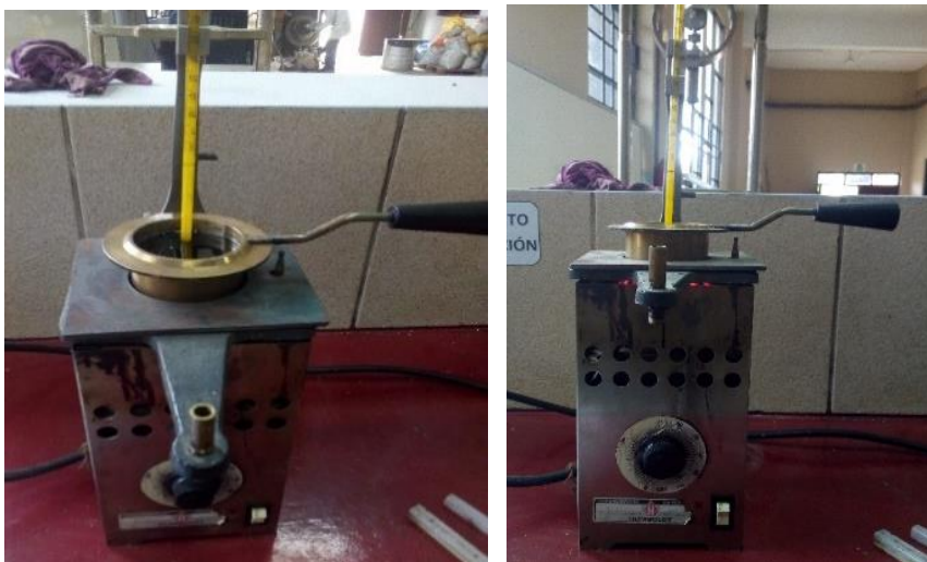
Figura 3.14: Ensayo de punto de inflamación del cemento asfáltico
