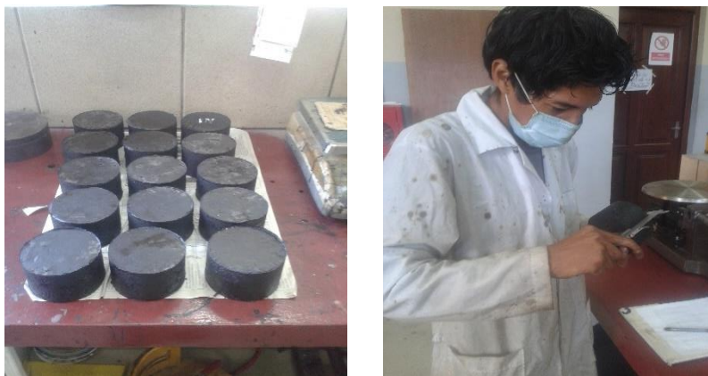
Figura 3.22: Desmolde y medición de alturas de las briquetas
