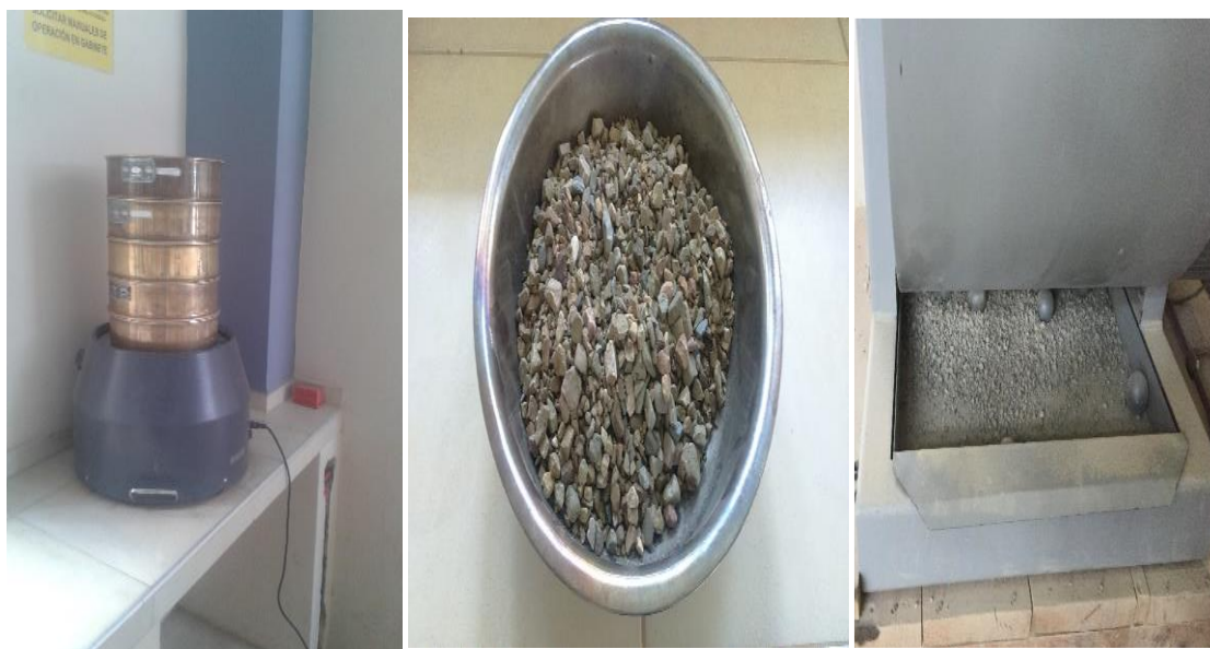
Figura 3.7: Ensayo de desgaste máquina de Los Ángeles.
