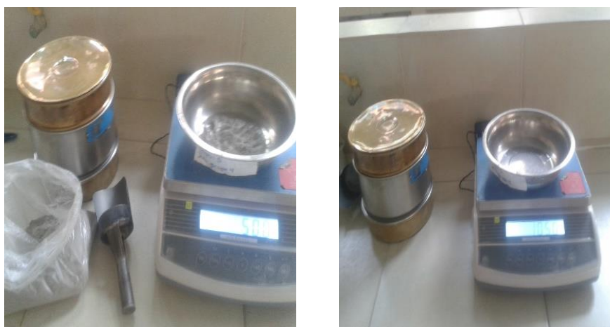
Figura 3.18: Ensayo de finura del cemento
