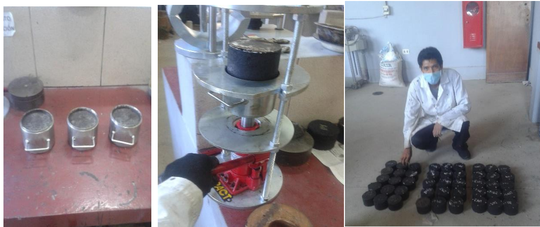
Figura 3.21: Proceso de desmolde y marcación de las briquetas
