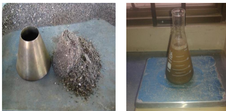
Figura 3.9: Ensayo de peso específico agregado fino.
