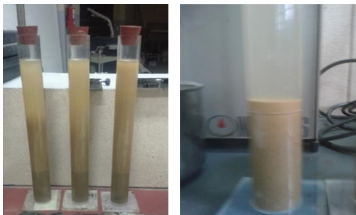
Figura 3.6: Ensayo de equivalente de arena.
