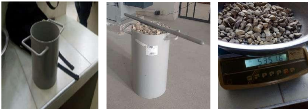
Leyenda: Ensayo de determinación del peso unitario de los agregados grueso y fino suelto y compactado.
