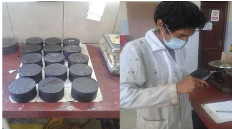
Leyenda: Proceso de medición de las alturas de las briquetas
