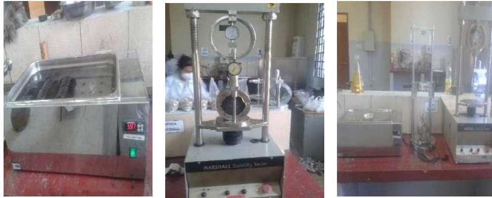
Leyenda: Equipo para la determinación de las propiedades de las mezclas asfálticas por medio del Método Marshall.
