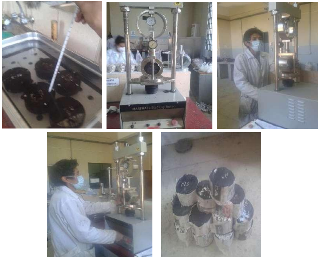
Leyenda: Proceso de rotura de la briqueta para la determinación de estabilidad y fluencia de la mezcla asfáltica.
