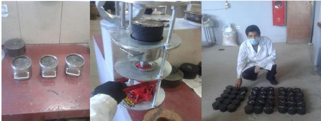
Leyenda: Proceso de enfriamiento, desmolde y marcación de las briquetas.
