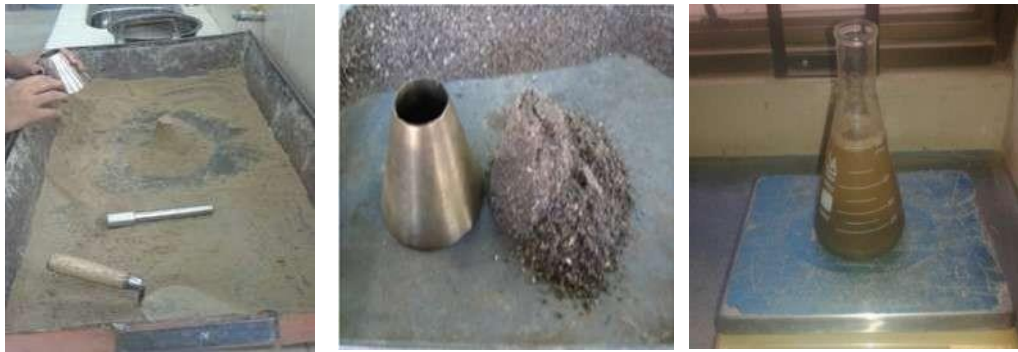
Leyenda: Ensayo de determinación de peso específico para agregado fino.
