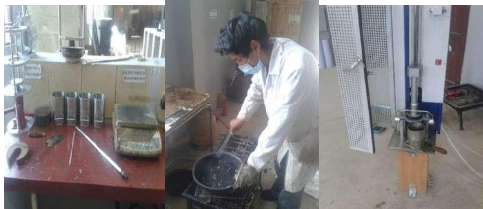
Leyenda: Material y proceso de mezclado de los agregados grueso, fino y betún en una mezcla homogénea, para luego compactarla dentro de un molde abierto en los extremos para la elaboración de las briquetas.
