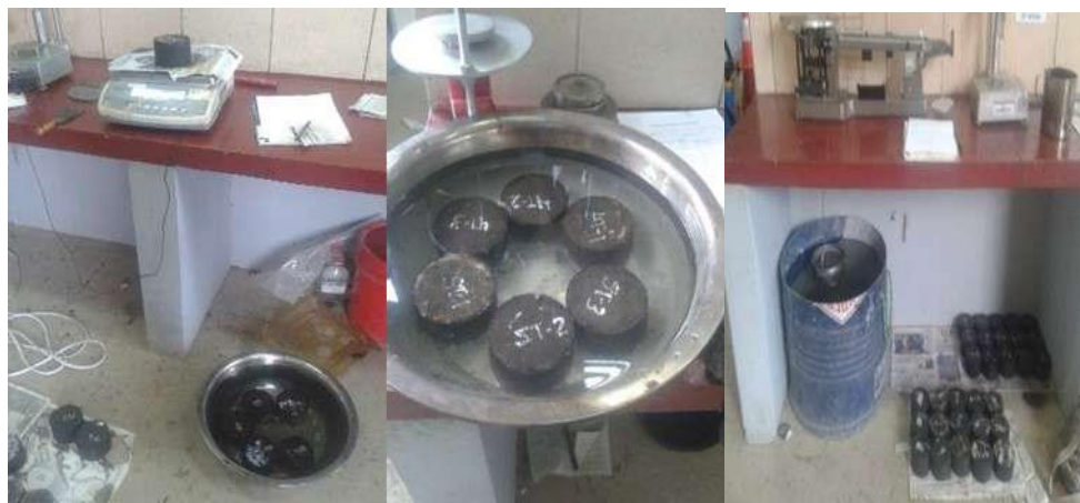
Leyenda: Proceso de pesado de las briquetas en seco, saturado y sumergido en agua para establecer las densidades.
