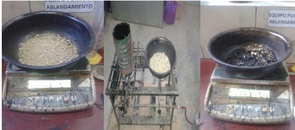
Leyenda: Pesado de materiales de la mezcla asfáltica.
