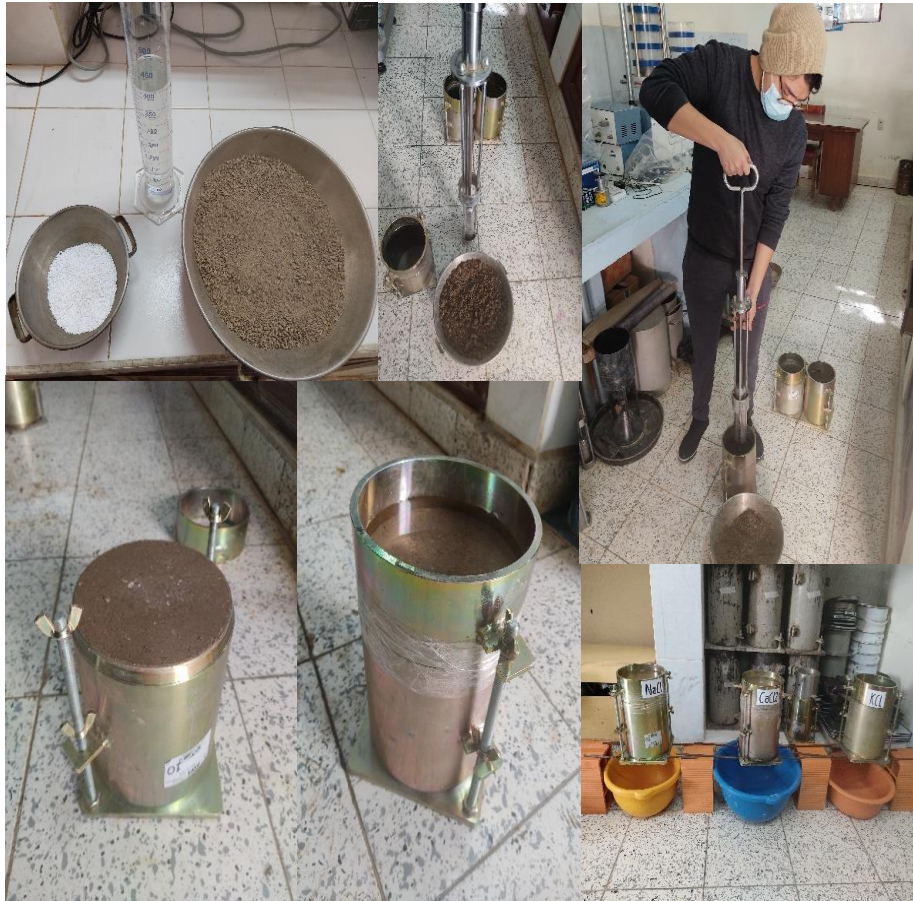
Figura 3.14: Comprobación de pérdida de agentes estabilizadores
