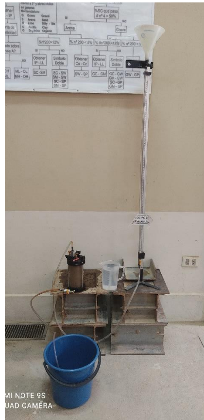
Figura 3.8: Ensayo de permeabilidad
