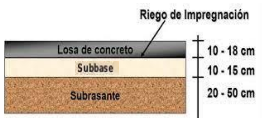
Figura 2.6: Sección transversal de pavimento rígido
