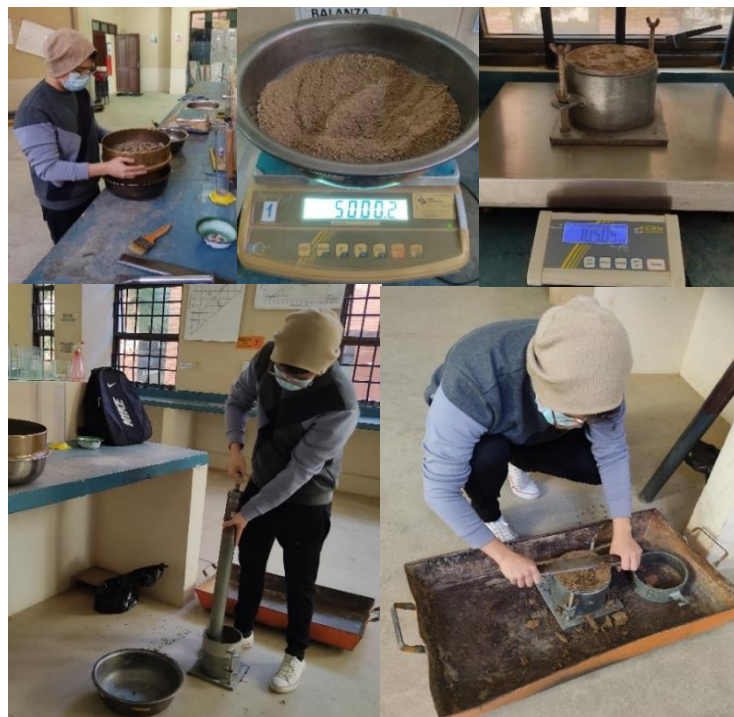
Figura 3.6: Proceso de compactación
