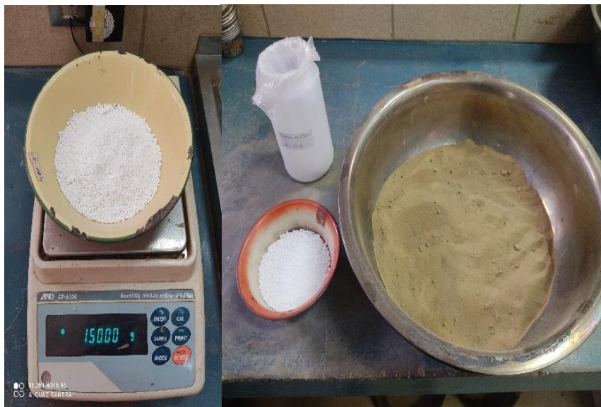
Figura 3.10: Adición de sal para compactación
