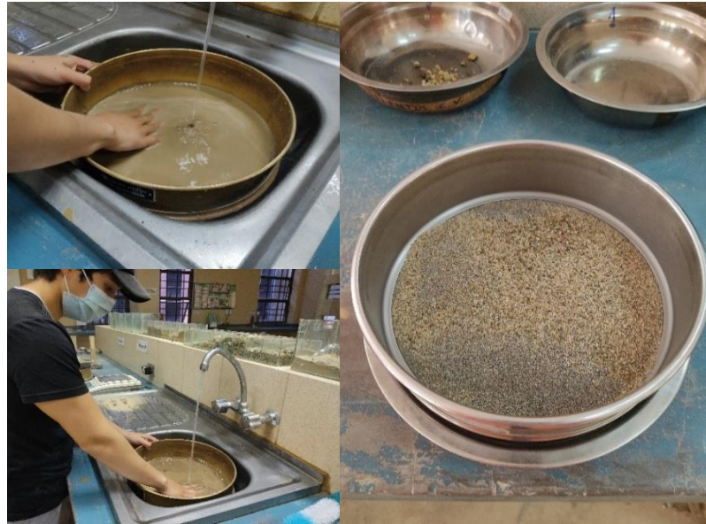
Figura 3.4: Método de lavado
