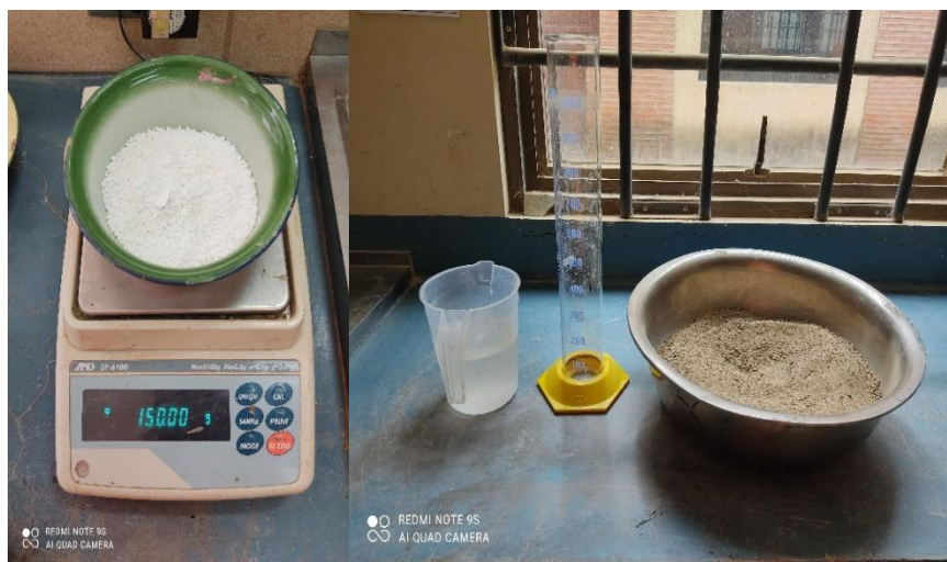
Figura 3.11: Adición de sal para CBR
