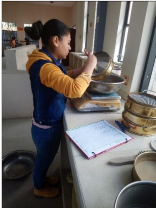
Fotografía 3.8 Pesaje de la muestra
