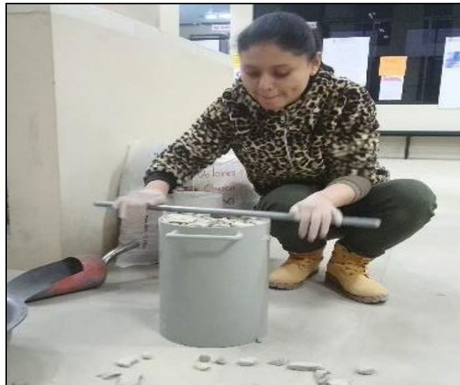
Fotografía 3.16 Peso unitario del agregado fino
