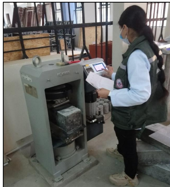
Fotografía 3.31 Ingreso de datos para la rotura de viga a flexión
