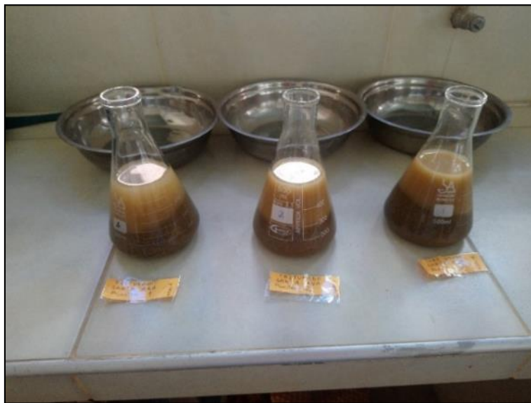
Fotografía 3.14 500 g de muestra saturados en agua dentro de un matraz
