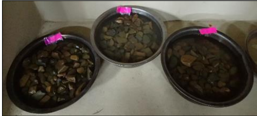
Fotografía 3.9 Saturación del agregado grueso durante 24 horas
