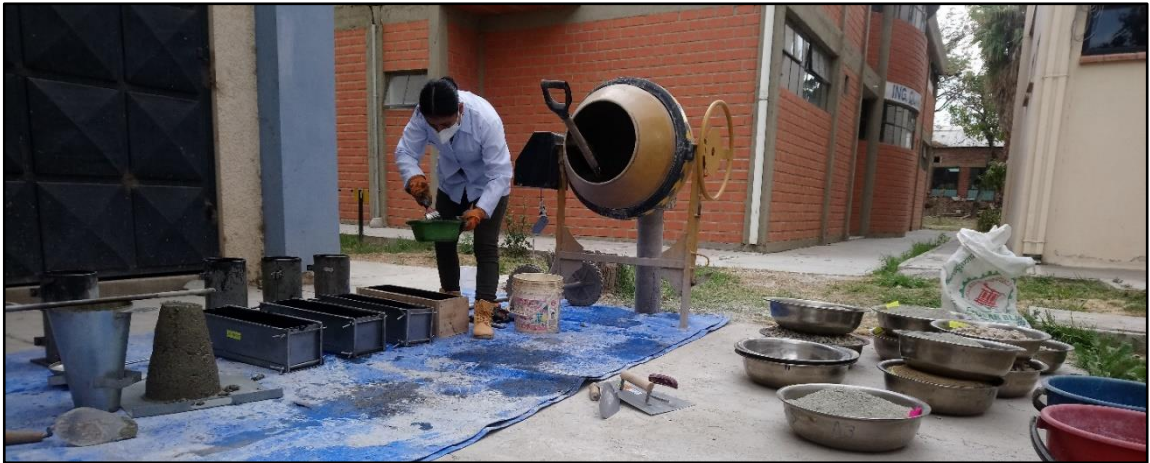
Fotografía 3.26 Varillado de cada capa
