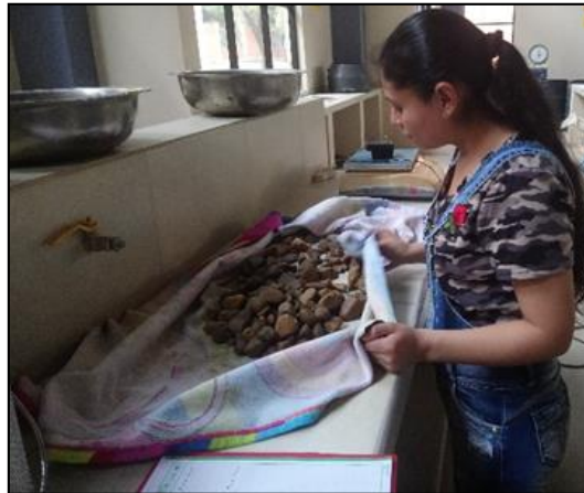
Fotografía 3.11 Peso de la muestra saturada dentro el agua
