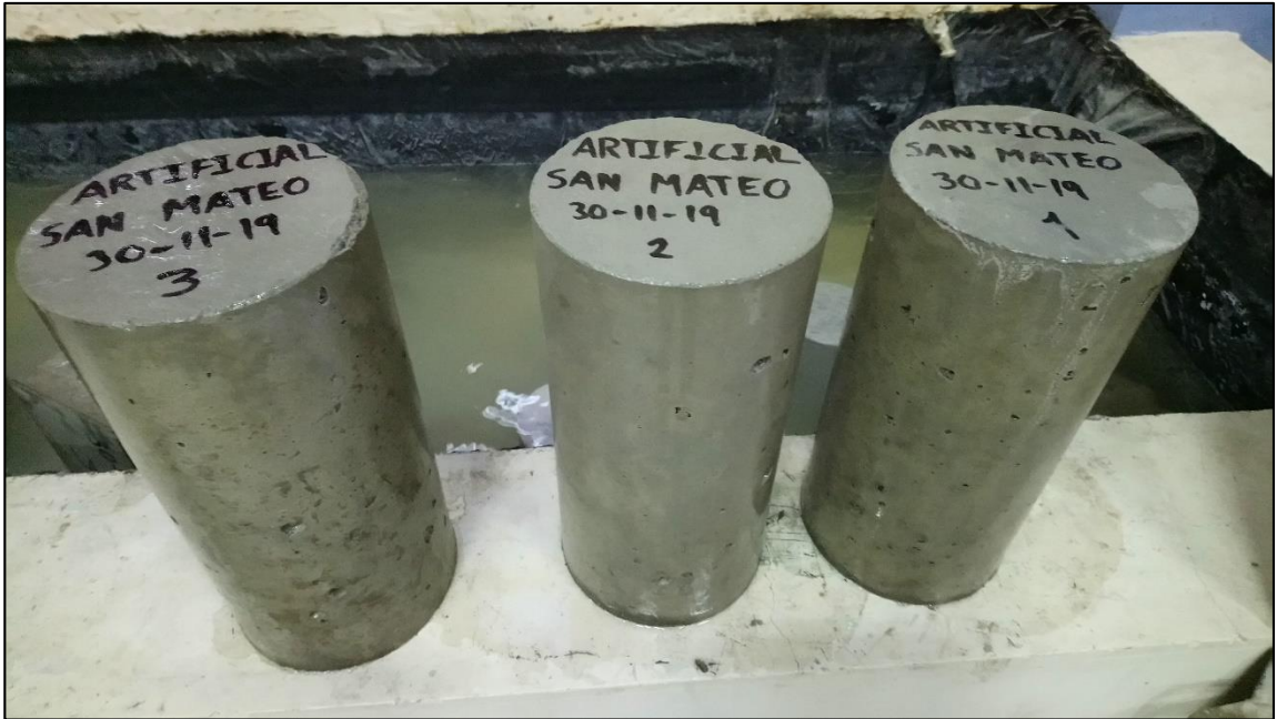
Fotografía 3.28 Secado de las probetas a temperatura ambiente
