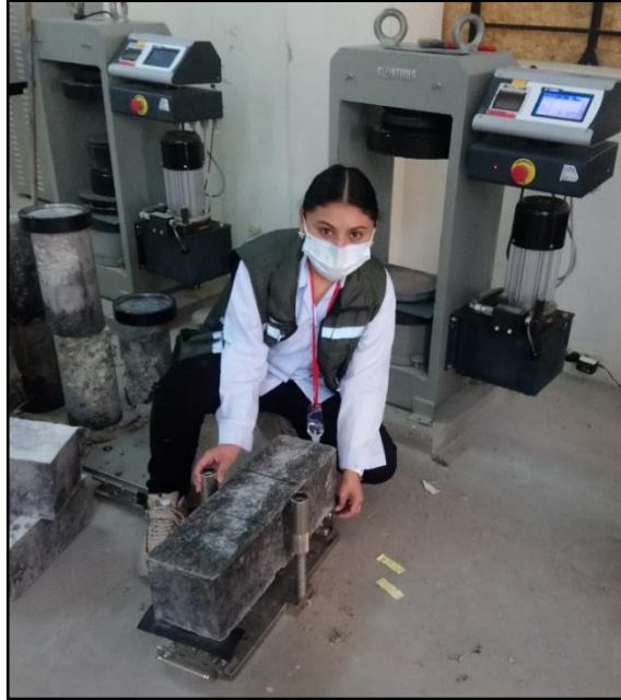
Fotografía 3.30 Preparación del espécimen para la rotura
