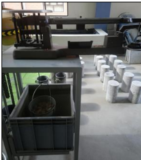
Fotografía 3.11 Peso de la muestra saturada dentro el agua
