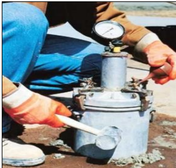
Figura 2.8 Equipo para contenido de aire método de presión
