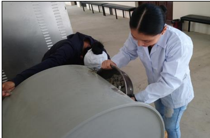
Fotografía 3.17 Colocado de la muestra en el tambor
