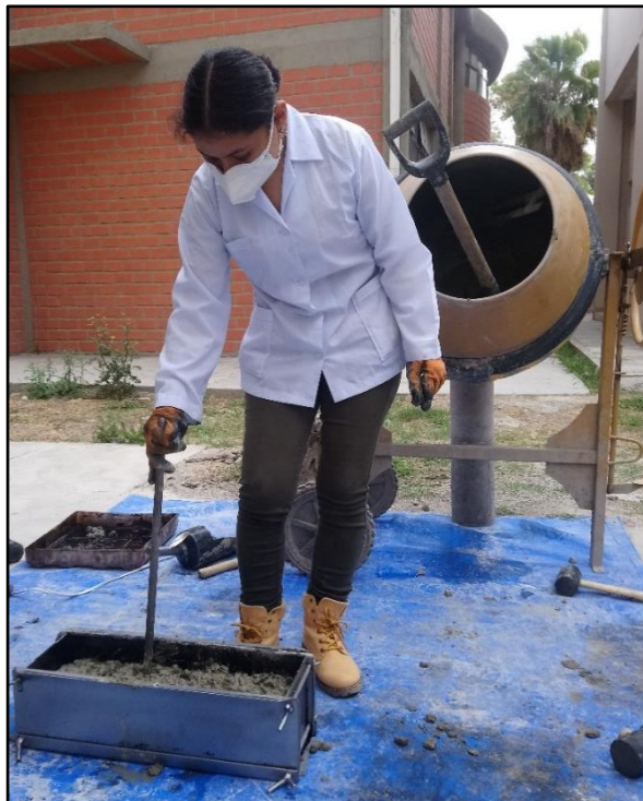
Fotografía 3.26 Varillado de cada capa
