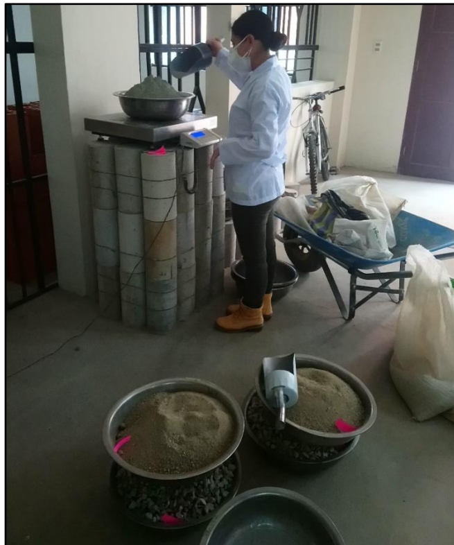
Fotografía 3.21 Bandejas con los materiales pesados para la mezcla según la dosificación de diseño
