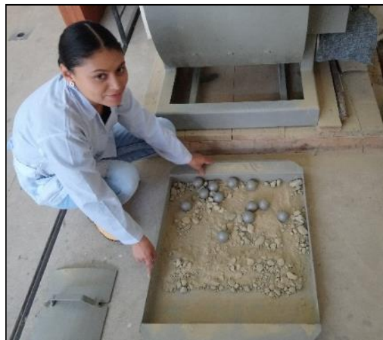
Fotografía 3.18 Muestra sometida al impacto de esferas
