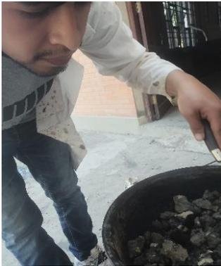
**Figura 36.** Introducir e material RAP a la centrifugadora.
