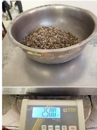
**Figura 26.** Agregado grueso triturado por la máquina de los ángeles.
