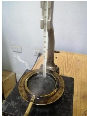
Caracterización del cemento asfaltico punto de combustión e inflamación
