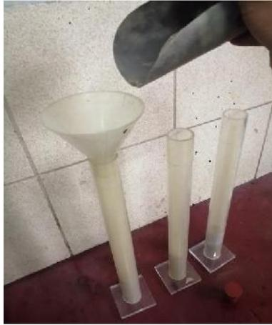
Colocado del material en probetas
