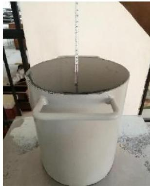
Medición de la temperatura del agua
