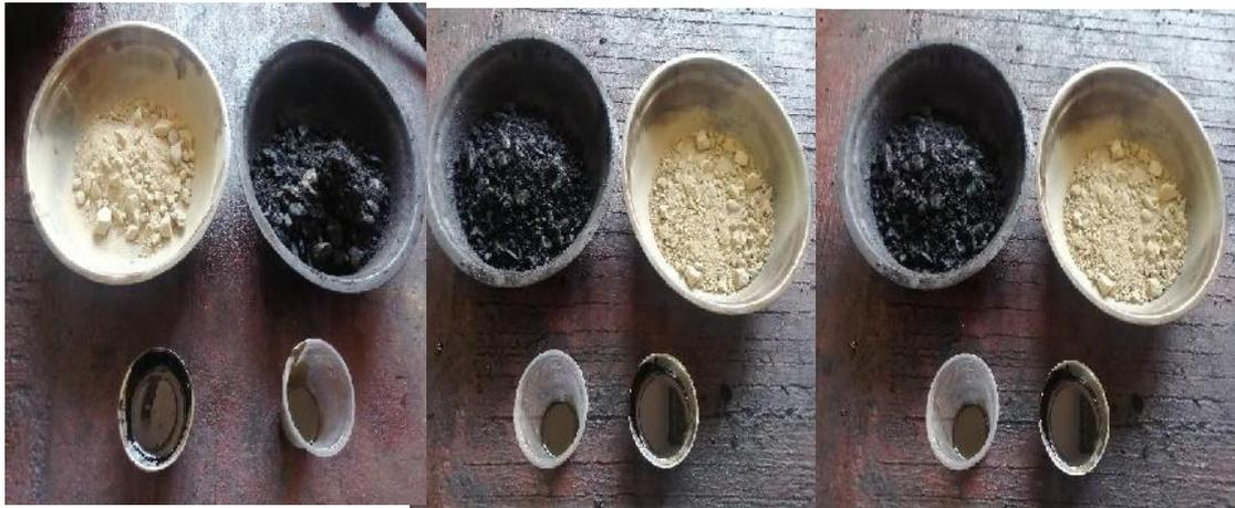
Material asfalto reciclado y aceite de motor al 5%, 10%, y 15%
