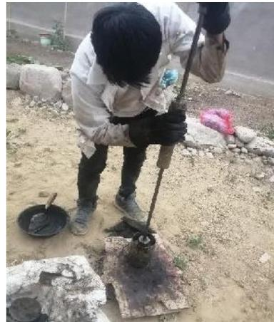
Compactado del cemento asfáltico
