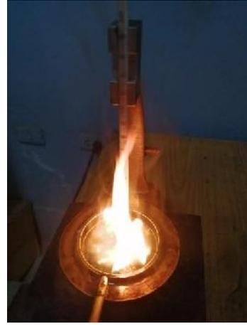
Medición de la temperatura para el punto de combustión e inflamación para el aceite desechado de motor
