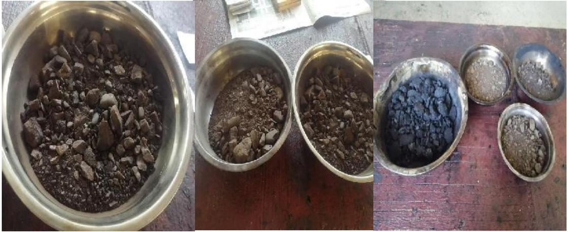
Material RAD sin cemento asfáltico
