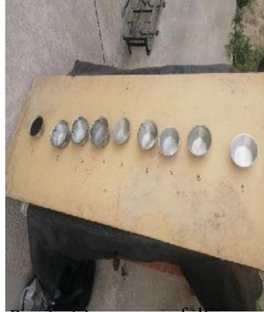
Pesado del cemento asfáltico a
