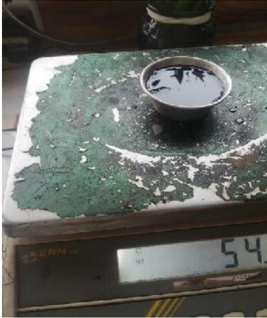
Peso del cemento asfáltico
