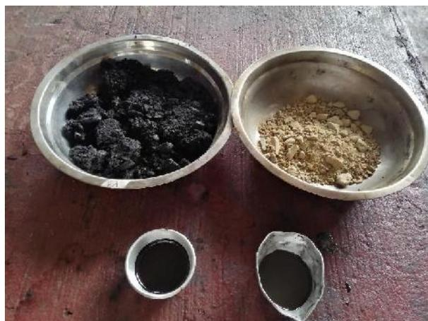
Combinación de material Rap, Material convencional cemento asfáltico y aceite de motor desechado al 5% (diésel) para realizar las briquetas
