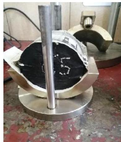
Compactado del cemento asfáltico
