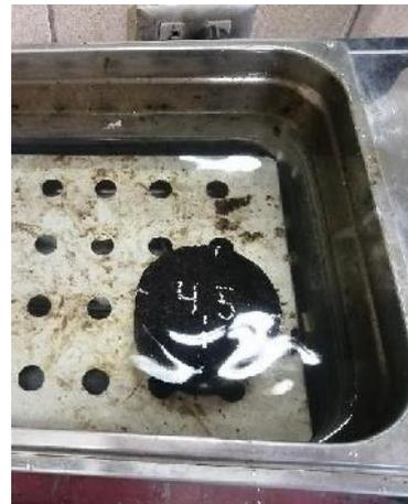
Medición de las briquetas al espesor peso seco semisumergido y totalmente sumergido
