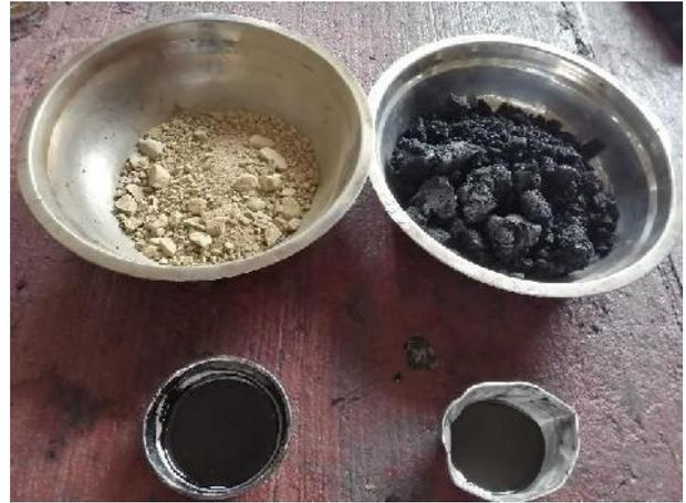
Combinación de material Rap, Material convencional cemento asfáltico y aceite de motor desechado al 20% (gas-gasolina) para realizar las briquetas
