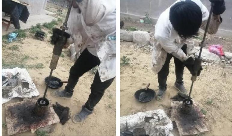
Compactado del cemento asfáltico
