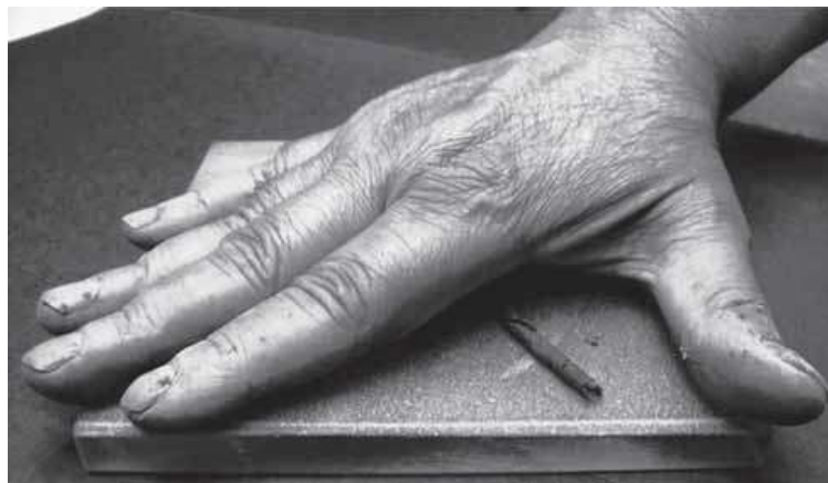
Figura 5. Prueba de limite plástico.
