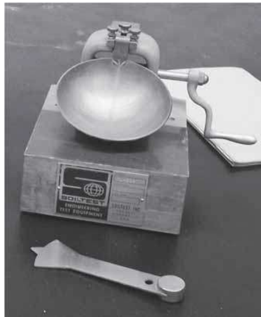
Figura 4. Dispositivo de limite líquido y herramienta de ranurado.
