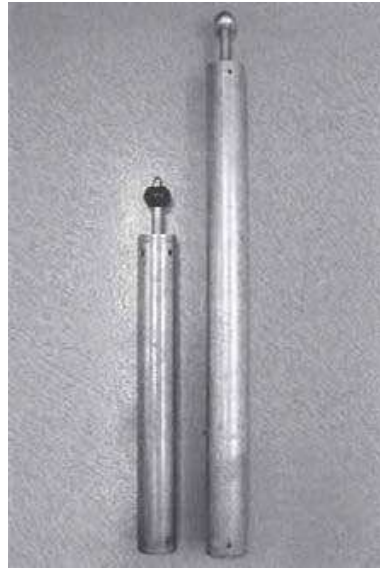
Figura 7. Martillos utilizados en las pruebas Proctor estándar y modificada.
