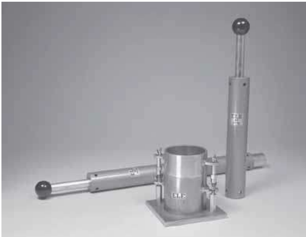
Figura 6. Martillos utilizados en las pruebas Proctor estándar y modificada.
