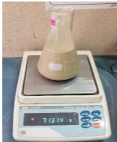
Figura 3. Ensayo de peso específico.
