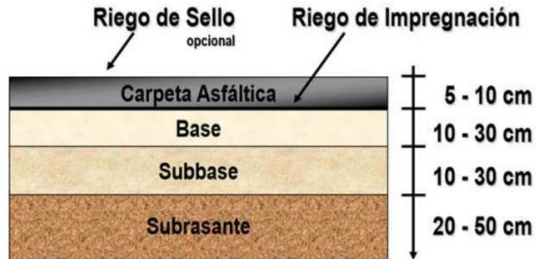
Figura 1 Corte transversal de un pavimento flexible
